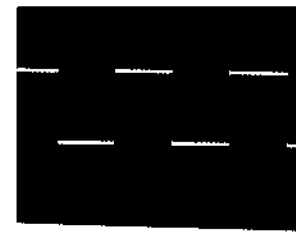
④ IC333 ②pin, IC363 ⑩pin (LRCKI) 5Vp-p, 5μs
