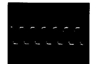
8 IC702 2pin (BCK) 5.2Vp-p, 0.3μs
