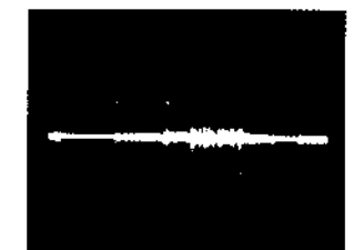
11 IC1 2pin, 3pin (HEAD) REC mode 4.2Vp-p
