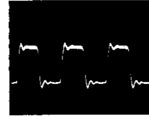
㉕ IC307 ㉓pin 3.6Vp-p, 49MHz
