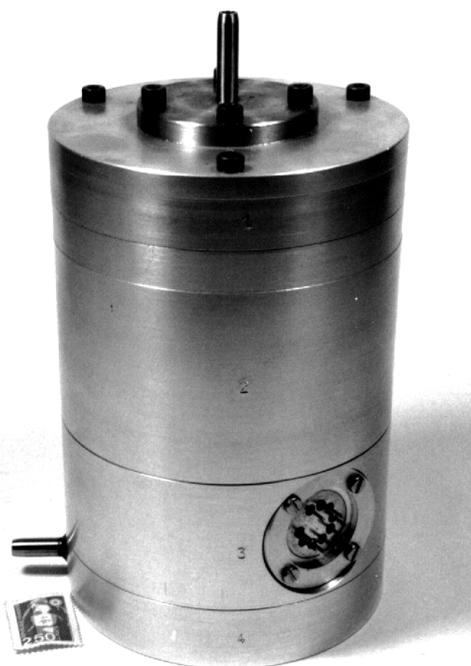
réunies sur un support commun, les deux pompes volumétriques (à pistons et à palettes), reliées, à travers un robinet, à un petit réservoir de vide. Ainsi le vide préliminaire est obtenu de l'une ou l'autre pompe, la pompe moléculaire prenant la suite. Le réservoir de vide, isolé en amont si le robinet est fermé, donne une autonomie suffisante pour se passer des pompes
