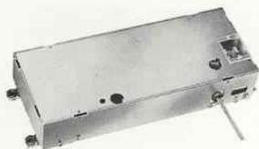
Spiralfedersystem mit Transistor-Verstärker. Hallstärke regelbar (Mono/Stereo).
