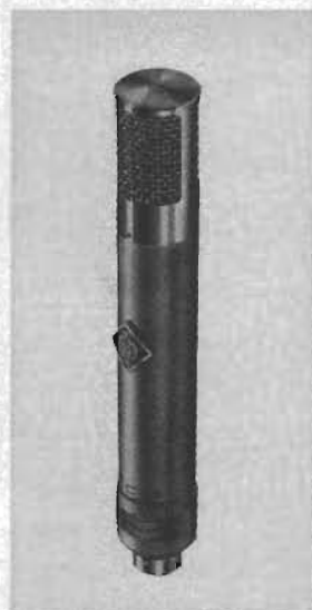
Fig 11 Kondensatormikrofon, typ Neumann KM56, med omkopplingsbar upptagningskarakteristik. Frekvensområdet 40—15 000 Hz, känslighet 0,8 mV/ \mu b, distorsion 0,4 %, pris 1105:—.
