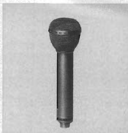
Fig 6 Dynamisk kardiodmikrofon Beyer typ M88. Frekvensområde 40—16 000 Hz \pm 3 dB, känslighet 0,25 mV/ \mu b, pris 670:—.
