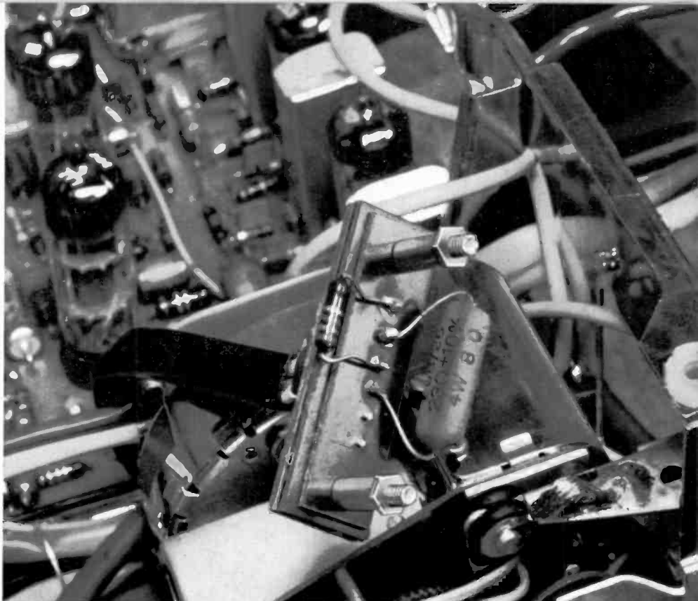
Blindstecker, der an Stelle eines nicht benutzten UHF-Tuners 15 tritt
