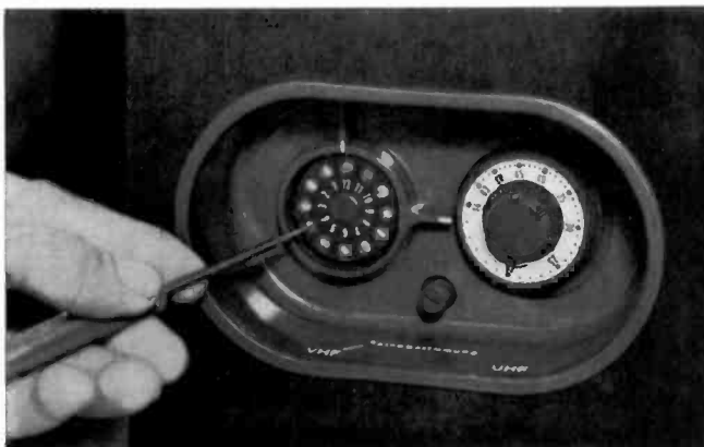
Bild 2 So wird die Wählerscheibe auf die gewünschten Kanäle eingestellt
