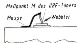
Bild 17 Mechanische Anordnung des Meßpunktes im UHF-Tuner 15
