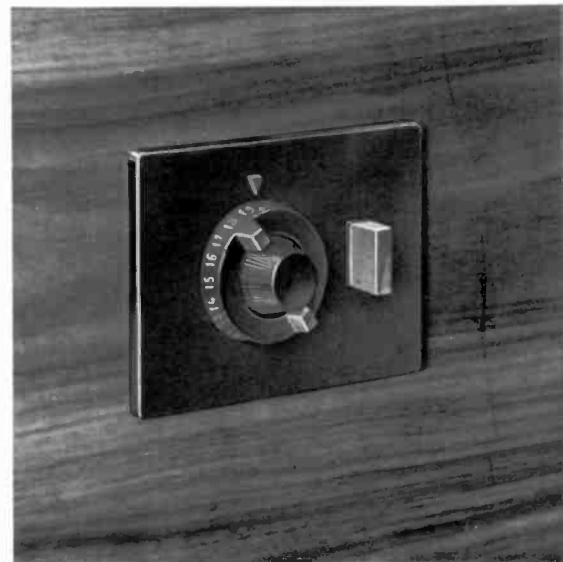
Bild 7 Abdeckplatte und Bedienungsorgane des GRUNDIG Universal-UHF-Einbauteils nach erfolgtem Einbau
