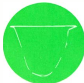
Bild 5 „Marke“ (Schwung) auf einer HF-Durchlaßkurve. RC-Kombination 5 k \Omega - 1 nF vor dem Oszillographeneingang
