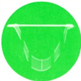
Bild 4 „Marke“ (Schwung) auf einer HF-Durchlaßkurve mit Breitbandoszillograph
