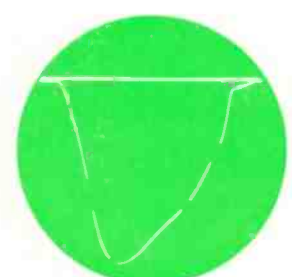
Bild 13 Durchlaßkurve des selben Bild-ZF-Verstärkers, bei dem die ZF-Röhren untereinander vertauscht wurden
