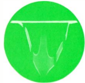
Bild 7 Markengeber ist zu stark aufgedreht. Die Form der Durchlaßkurve wird unkenntlich
