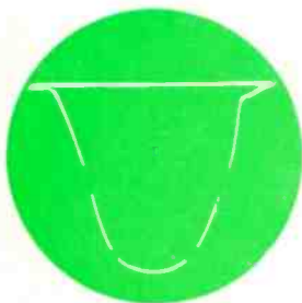
Bild 8 Das HF-Anschlußkabel des Wobblers wurde mit 60 Ω abgeschlossen
