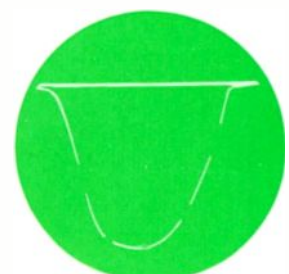
Bild 6 „Marke“ (Schwung) auf einer HF-Durchlaßkurve. RC-Kombination 50 k \Omega - 5 nF vor dem Oszillographeneingang. Durch zu große Zeitkonstante wird die Durchlaßkurve verzerrt
