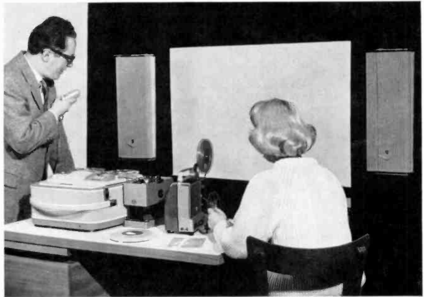
Bild 1 Schmalfilm-Vertonung im Zweikanal-Verfahren mit GRUNDIG TK 54. Links neben der Bildwand: GRUNDIG Hi-Fi-Raumklang-Box IV, rechts GRUNDIG Hi-Fi-Verstärker-Box IV
