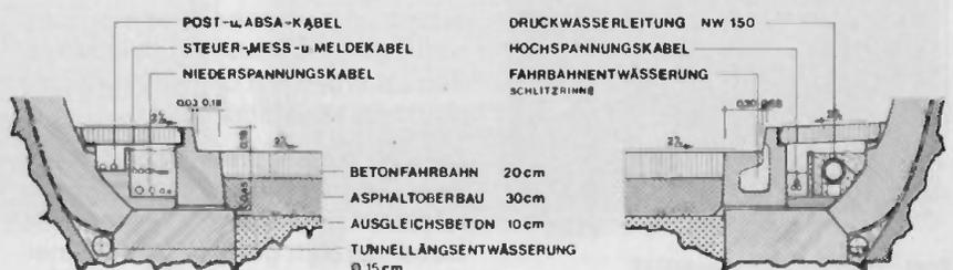
Bild 1 Querschnitt durch eine Tunnelröhre des Arlbergtunnels
