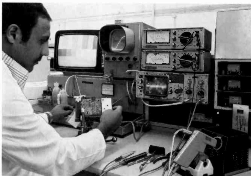
Bild 2 Reparaturplatz mit Kugelgelenkadapter (Farbbaustein)
