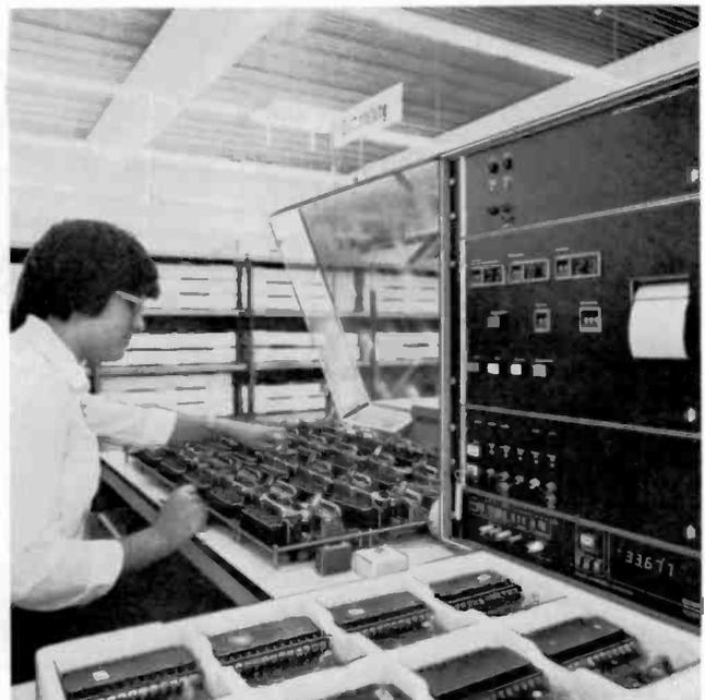
Bild 4 Driftmeßanlage bei geöffneter Abdeckung des Adapterrahmens
