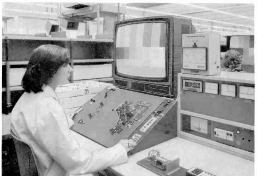
Bild 6 Prüfplatz der Endkontrolle
