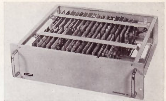
Bild 5 Steuereinschub einer Zweikoordinaten-Steuerung als Beispiel für den Aufbau der Anlage
