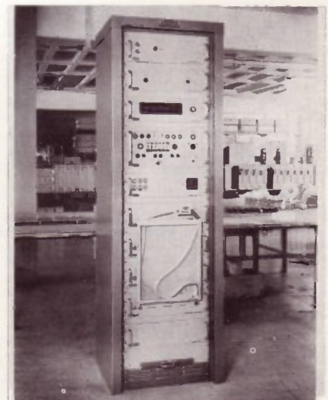
Bild 7 Steuerung, Bedienungspult und numerische Anzeige in einem Schrankgestell
