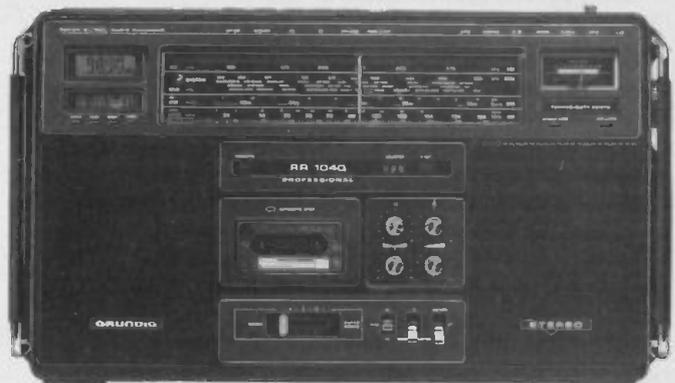
Grundsätzlich wurde davon ausgegangen, möglichst wenige Schraub- und Lötverbindungen beim Ein- und Ausbau zu haben sowie die unterschiedlichsten Eigenschaften sämtlicher Geräte unter einen Hut zu bringen. Weiterhin sollten natürlich ein guter Mehrbereichs-Rundfunk-Empfänger einschließlich Stereo-UKW-Teil mit gleichzeitiger Cassetten-Aufnahmemöglichkeit sowie einer vorrangigen Tonband-Wieder-
