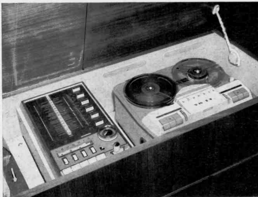
Bild 5 Raum für Tonbandkoffer beim MS 70 a. Aber auch hier läßt sich ein TM 45-Chassis einbauen, da ein „doppelter Boden“ vorhanden ist, versehen mit allen Einbau-Bohrungen
