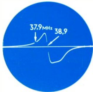
c) Diskriminatorekreis 13 richtig abgeglichen Feinabstimmungskondensator steht am linken Anschlag. Anodenkreis 15 nach hohen Frequenzen verstimmt (Kern herausgedreht)
