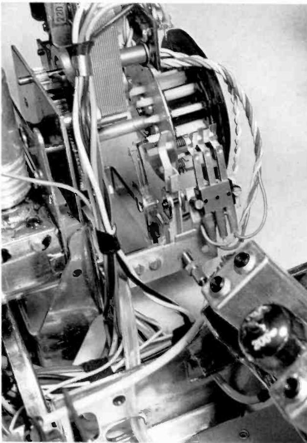
Bild 24 Die Kontaktfedersätze der Senderwählscheibe
