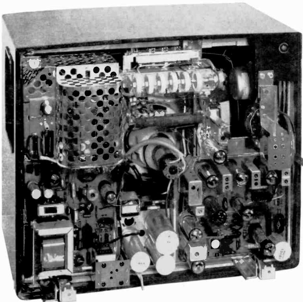
Bild 3 Trotz der kleinen Abmessungen ist der Aufbau des Chassis übersichtlich. Unser Bild zeigt den „Zauberspiegel 243“ (mit Magnetomatic-Scharfabstimmung) bei abgenommener Rückwandhaube.
