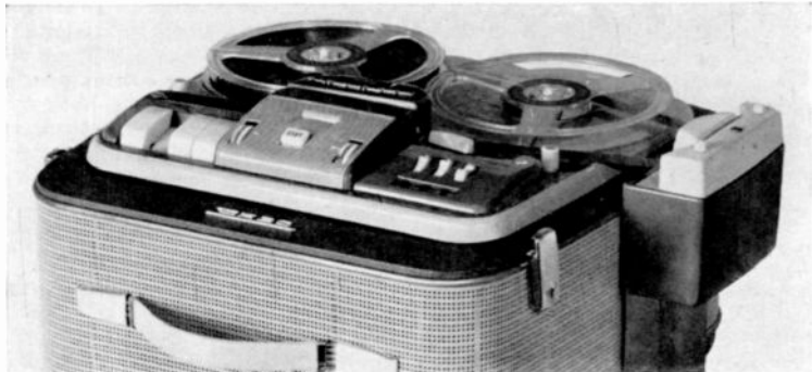
Das GRUNDIG sono-dia-Steuergerät läßt sich zu jedem Tonbandgerät verwenden. Unser Bild zeigt es am Tonbandkoffer TK 30.
