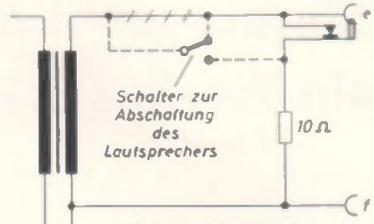
Bild 18 Schaltung des nachträglichen Einbaus von Lautsprecher-Abschaltern
