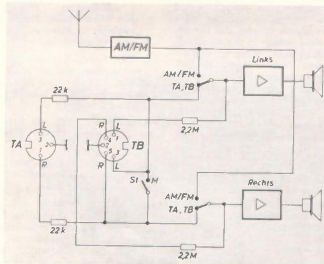
Bild 5 Tonbandbuchse bei einem Rundfunk-Tischgerät mit Zweikanal-Stereo-Verstärker
