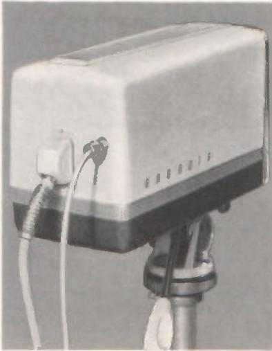
Bild 2 Die Kabelanschlüsse beim FA 40
