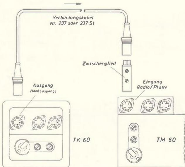
Bild 6. Verbindung zwischen TK 60 und TM 60
