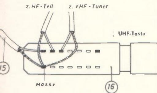
Anschluß der HF-Leitung ⑮ am UHF-Schiebeschalter des Druckstastenaggregats
