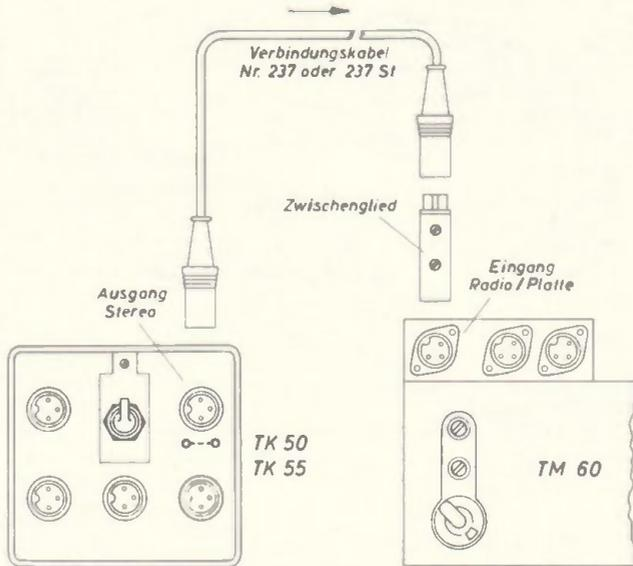
Bild 7. Verbindung zwischen TK 50, TK 54, TK 55 und TM 60
