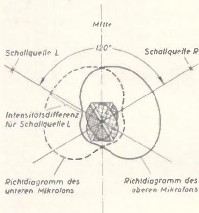
Bild 13 Richtcharakteristiken und Intensitätsdifferenz beim GDSM 211.
