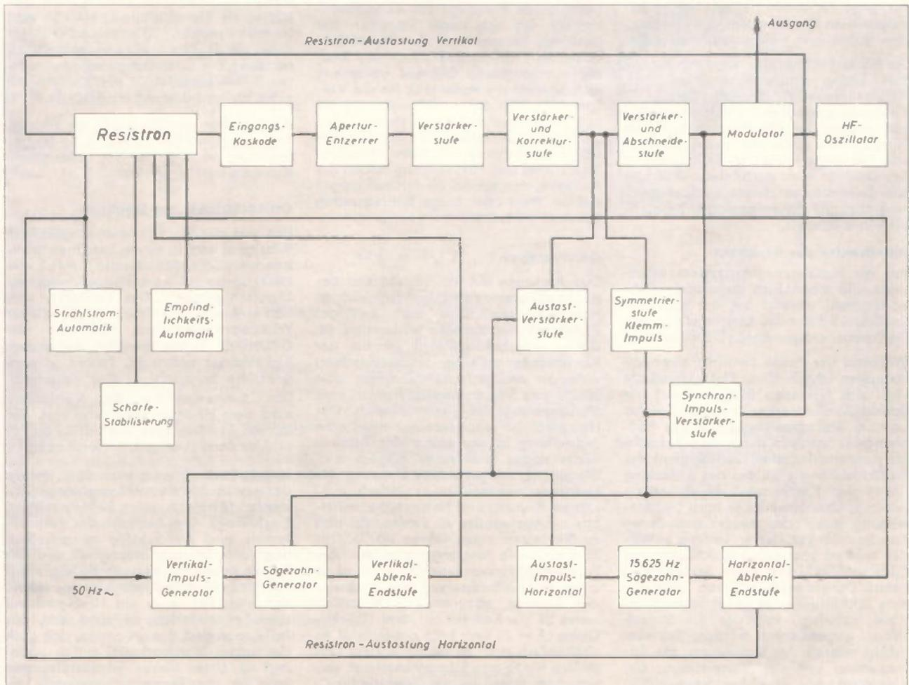
Bild 4 Blockschemo der GRUNDIG Fernsehkamera FA 40
