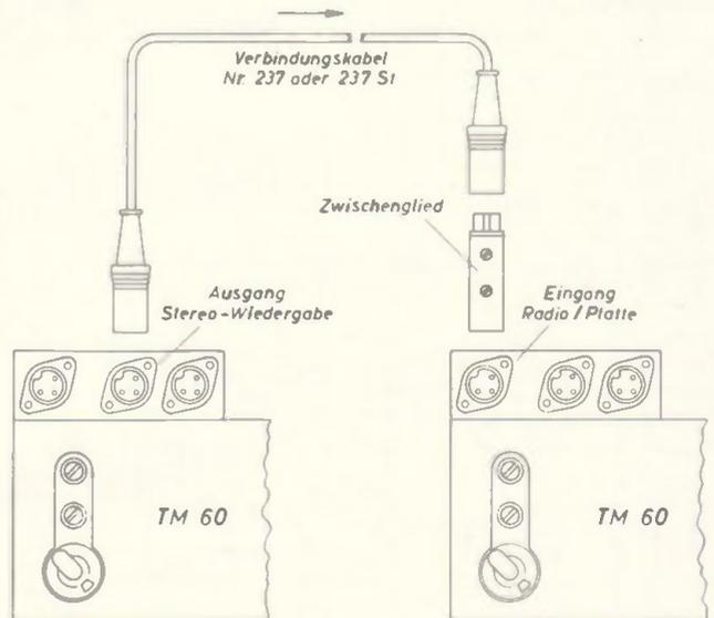
Bild 8. Verbindung zwischen TM 60 und TM 60
