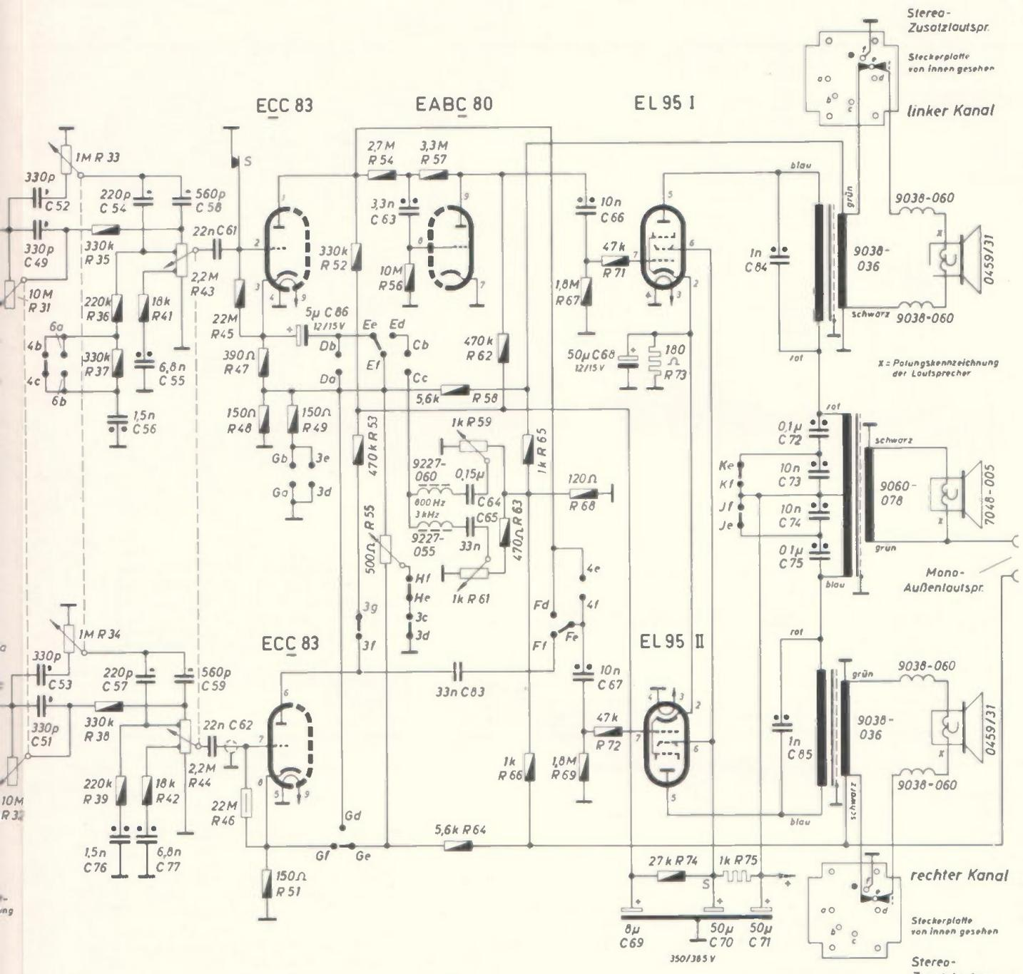
NF-Schaltung der GRUNDIG Stereo-Tischgeräte 4016, 4017 und 4019
