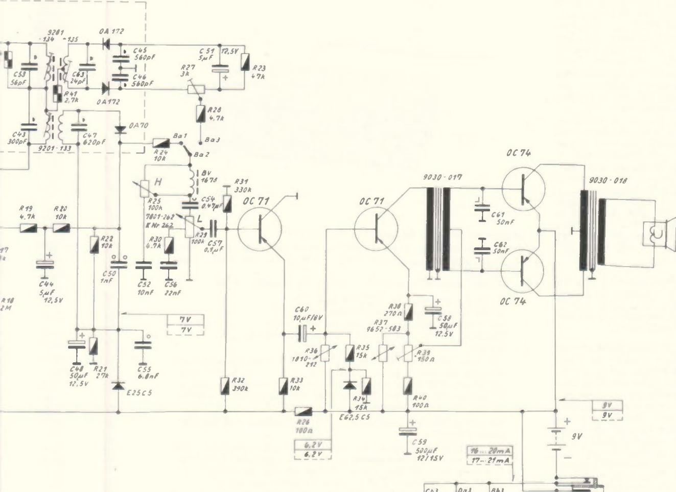
Spannungen mit GRUNDIG-Röhrevoltmeter auf den Meßbereichen 10/3/1 V bei 9V-Batteriespannung gemessen. Spannungs- und Stromwerte gültig für MW UKW bei eingedrehtem Drehko ohne Signal.
