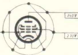
Spannungen bei Aufnahme ohne Signal mit GRUNDIG RVM Typ 6062 (R<sub>i</sub>: 30MΩ) gegen Chassis gemessen.
