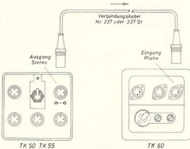
**Bild 2. Verbindung zwischen TK 50, TK 54, TK 55 und TK 60**
