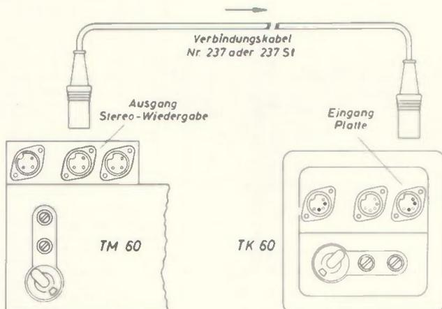
**Bild 4. Verbindung eines Stereo-Plattenspielers mit dem TK 60**
