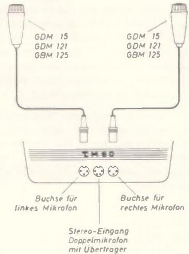
Bild 7 Anschluß von zwei getrennt aufgestellten Mikrofonen.
