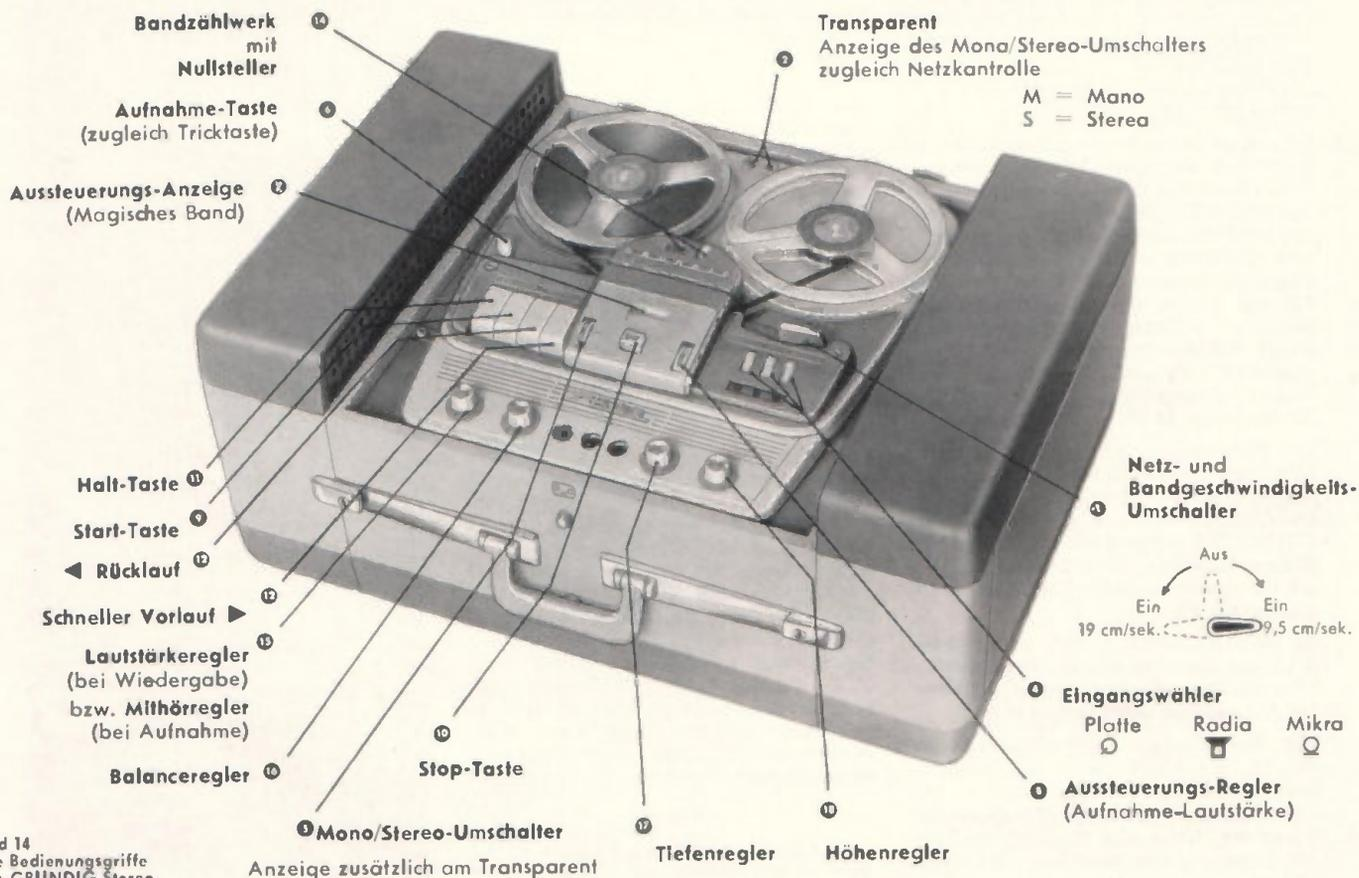
Bild 14 Die Bedienelemente des GRUNDIG Stereo-Tonbandkoffers TK 60.
