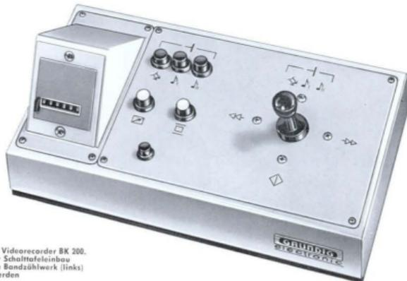
Bild 12 Fernbedienungspult zum Videorecorder BK 200. Diese Einheit ist auch für Schalttafelbau geeignet. Das elektrische Bandzählwerk (links) kann extern betrieben werden.
