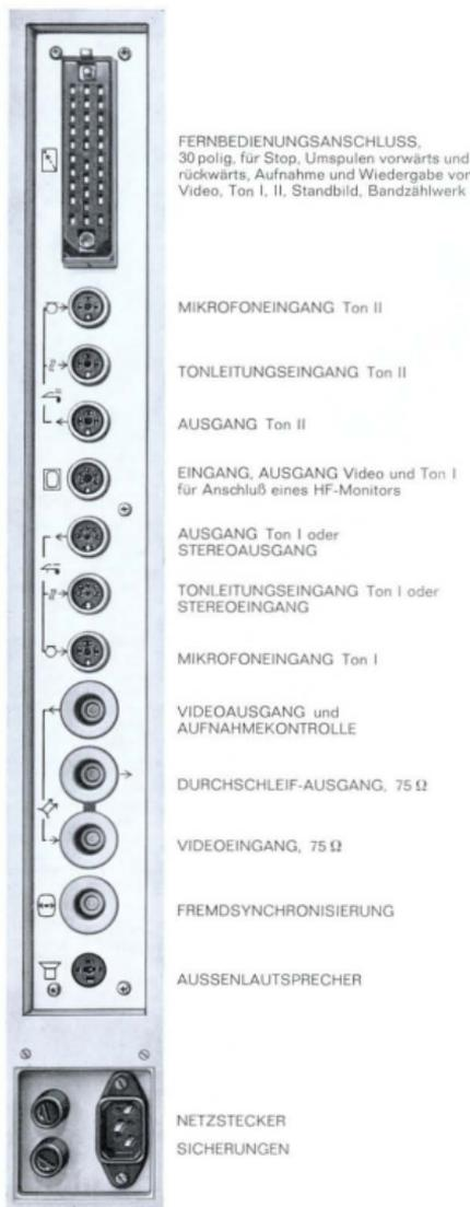
Bild 7 Die Anschlußleiste des Videorecorders BK 200
