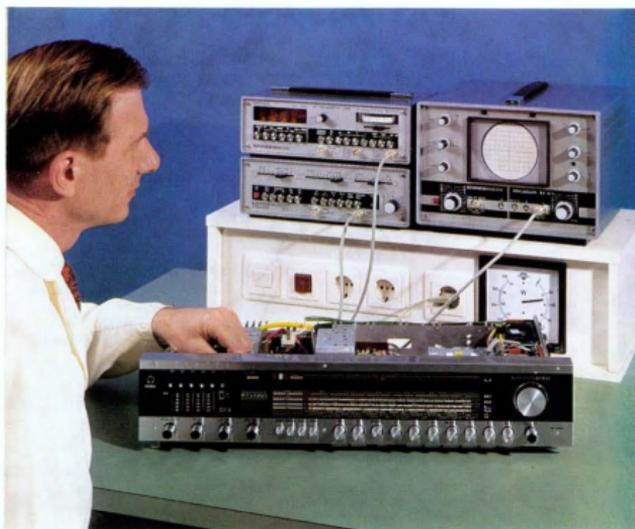
Stereo-Steuergerät-Abgleich mit GRUNDIG Stereo-Coder SC 5
