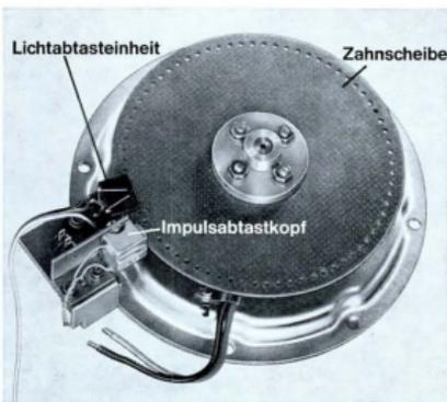
Bild 20 Abtastung der Zahnscheibe am Bandantriebsmotor
