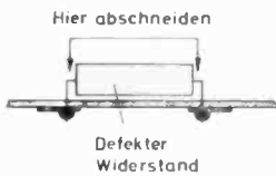
Bild 3 und 4 Auswechseln defekter Widerstände und Kondensatoren.
