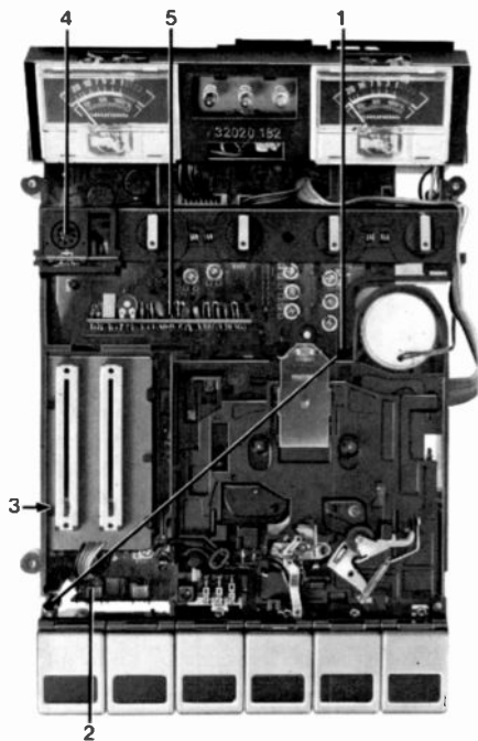
Bild 6 CN 830: Laufwerk von Druckplatte getrennt
