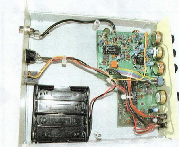
Fig.3 Le BFO est monté sur un petit circuit additionnel, en bas à droite.
