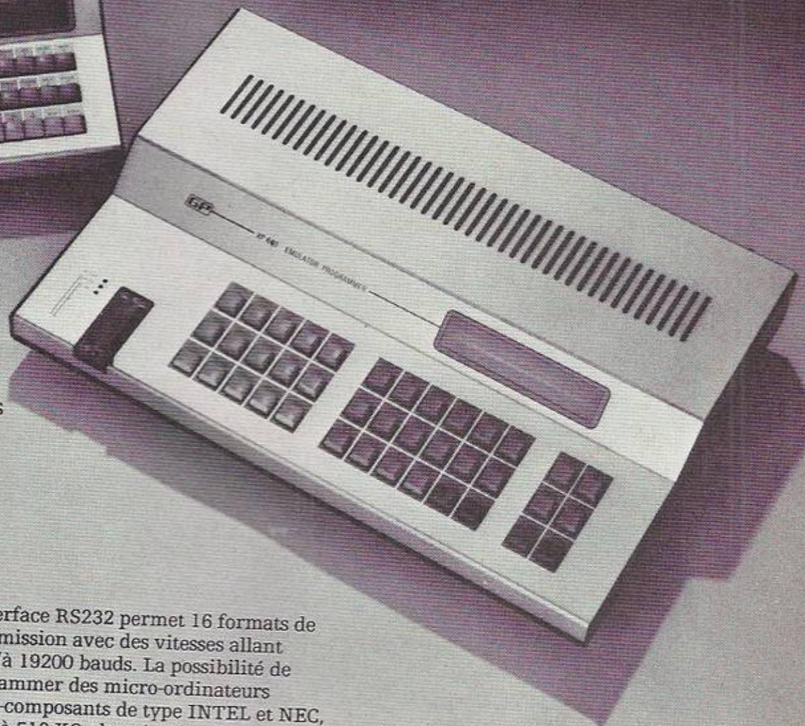
L'interface RS232C permet 16 formats de transmission avec des vitesses allant jusqu'à 19200 bauds. La possibilité de programmer des micro-ordinateurs mono-composants de type INTEL et NEC, jusqu'à 512 KO. de mémoire et ceci pour un prix de 12 500 F.
