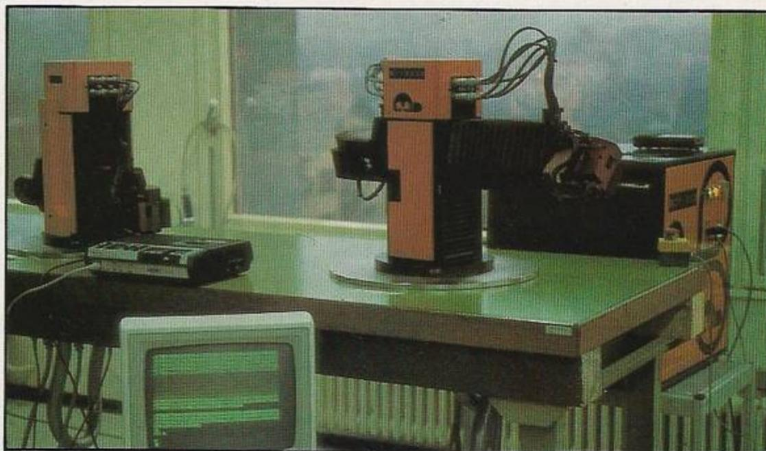
Contrôle d'un cycle d'assemblage sur un MR03. Au premier plan un micro-ordinateur visualise les différentes phases du cycle.
