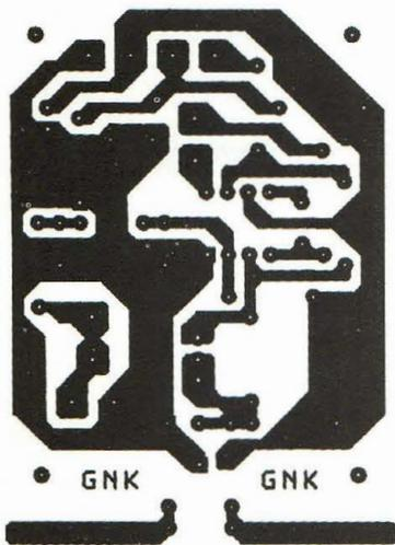
Fig.2 Reproduction à l'échelle 1 du circuit imprimé à l'échelle 1 vu du côté cuivre.
