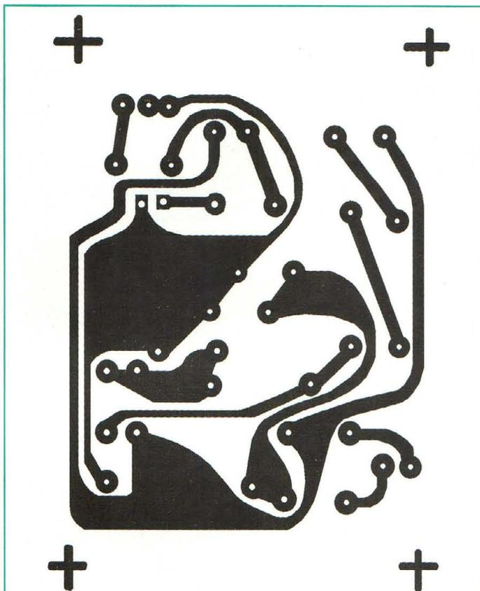
Fig.2 Reproduction à l'échelle 1 du circuit imprimé vu du côté cuivre.
