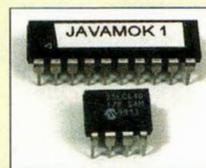
Programmable en BASIC, en C en assembleur et en Basic Pic
