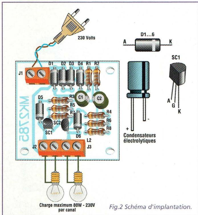
En effet, par rapport à une ampoule de 25 Watts reliée directement au 230 volts secteur, la même ampoule connectée sur J2 ou J3 donne une émission lumineuse supérieure d'environ 20%.
