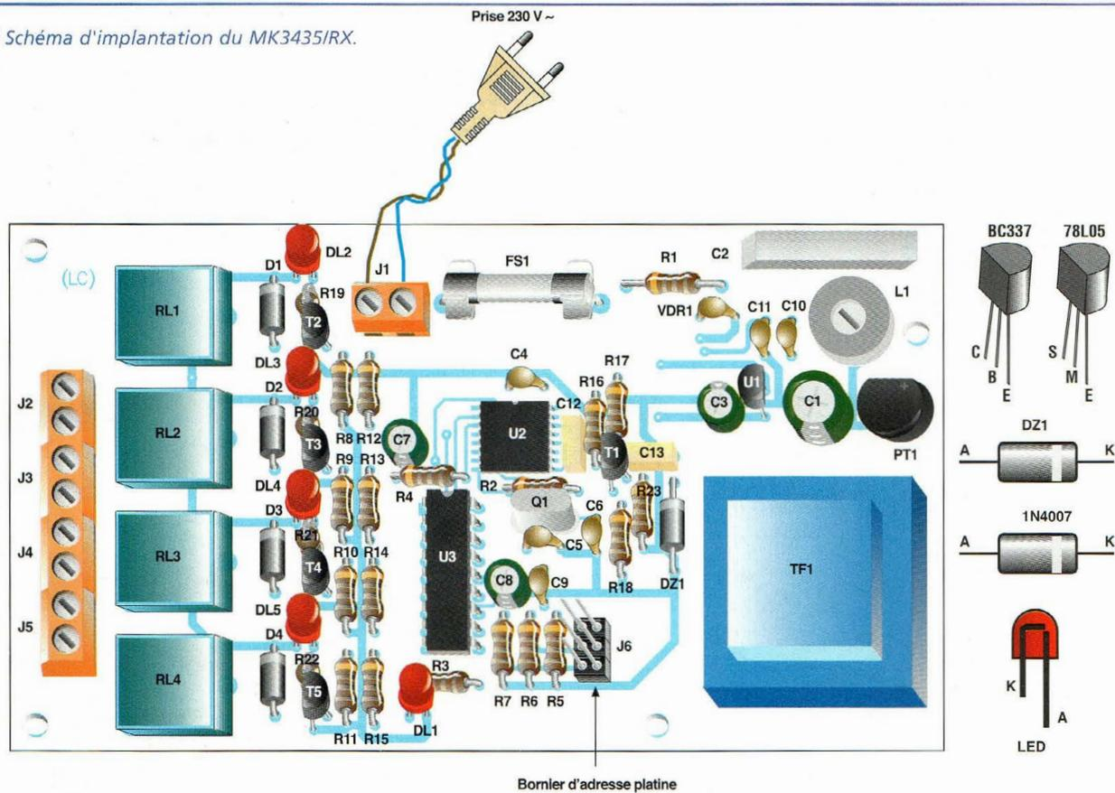
la platine est utilisée seule sans PC, le clavier optionnel permet la commande d'un seul module 3435/RX à la fois sélectionné par les cavaliers
