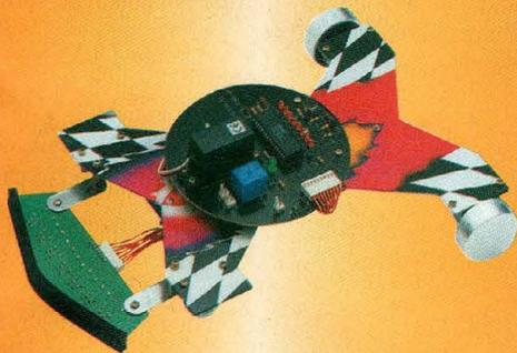
Suivi de ligne par 7 capteurs infrarouges • Propulsion par 2 moteurs • Mise en route par signal sonore • Fourni avec servo-moteur • Alimentation : Electronique + servo : 4 piles ou accus de type R6, propulsion : 3 accus de type R6 • Dimensions : 31 x 22 x 9 cm.
