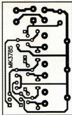
Fig.3 Reproduction du circuit imprimé MK3785 à l'échelle 1 vu du côté cuivre.
