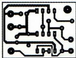
Fig.2 Reproduction du circuit imprimé à l'échelle 1 vu du côté cuivre.
