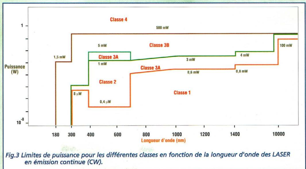
Fig.3 Limites de puissance pour les différentes classes en fonction de la longueur d'onde des LASER en émission continue (CW).
