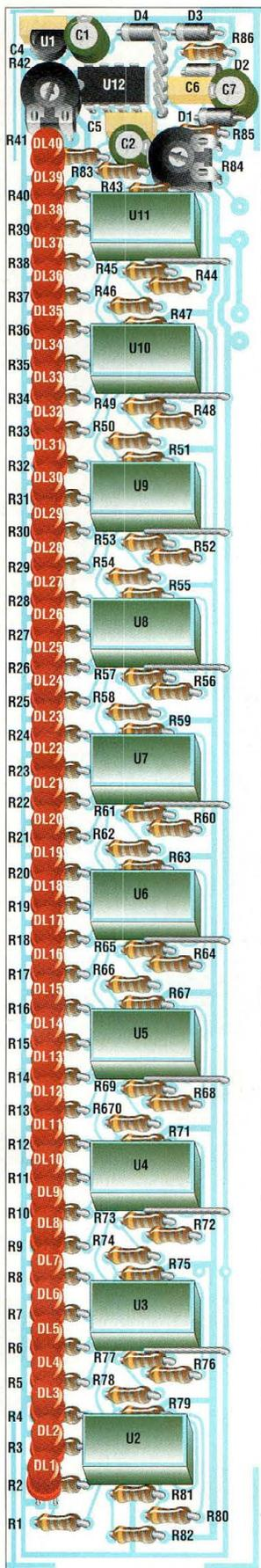
Fig.2 Schéma d'implantation et reproduction du circuit imprimé MK1495.
