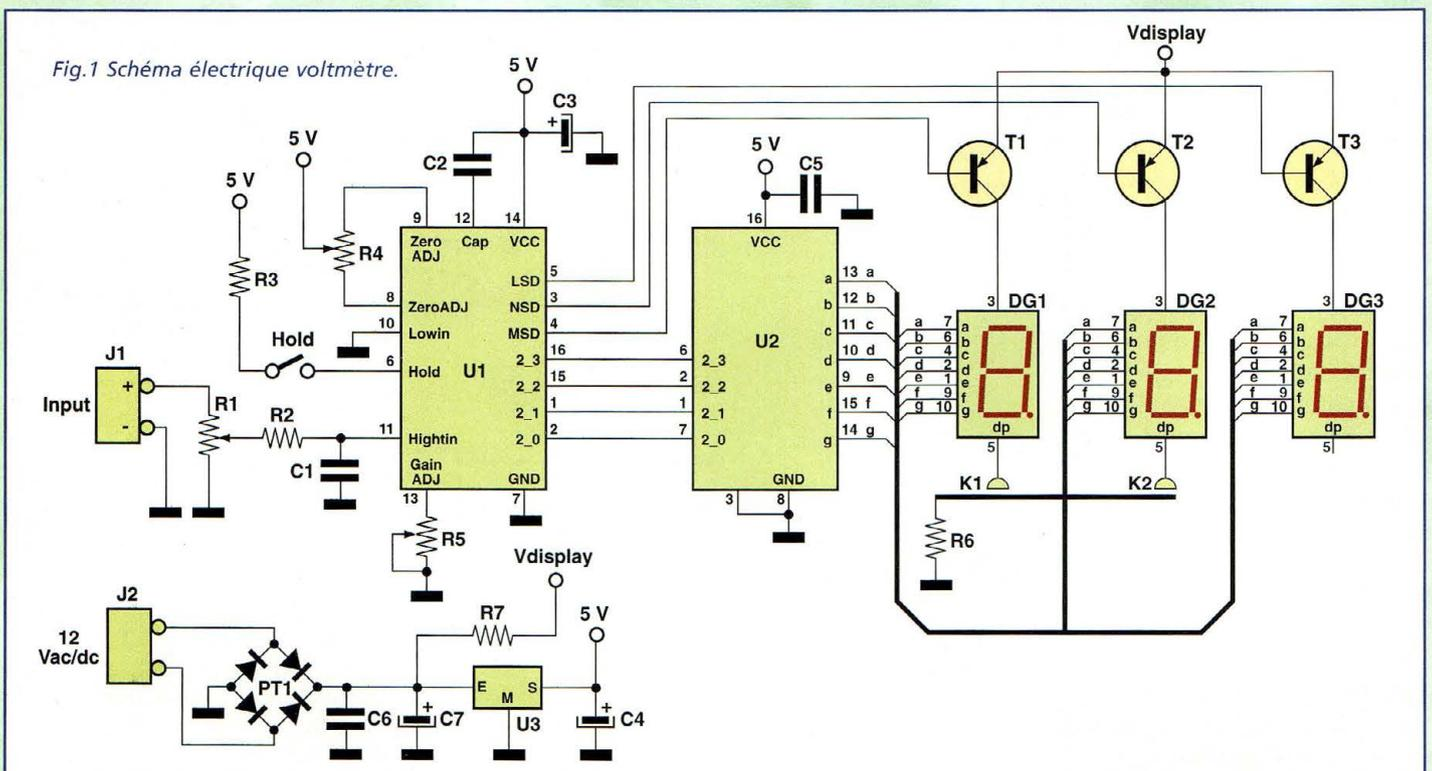
rents points, nous avons donc été amenés à concevoir ce système d'afficheur lumineux de grande taille visible d'une distance de 20 mètres environ. Nous l'avons couplé avec un dispositif de mesure, un voltmètre numérique, qui permettra d'assurer les mesures les plus diverses en associant des petits modules adapteurs.
