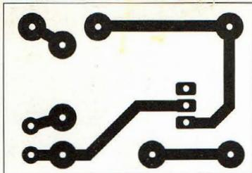
Fig.2 Reproduction à l'échelle 1 du circuit imprimé étudié pour recevoir les deux versions vu côté cuivre.
