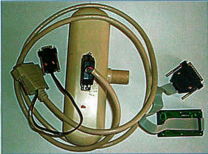
Fig.3. Détail de réalisation du câblage de l'interface à connecter sur le PC. Un câble additionnel branché sur une DB9 permet de prélever directement sur le PC le courant nécessaire au rétroéclairage de l'afficheur (fils rouge/noir = 5 volts). (photo J. Launay)
