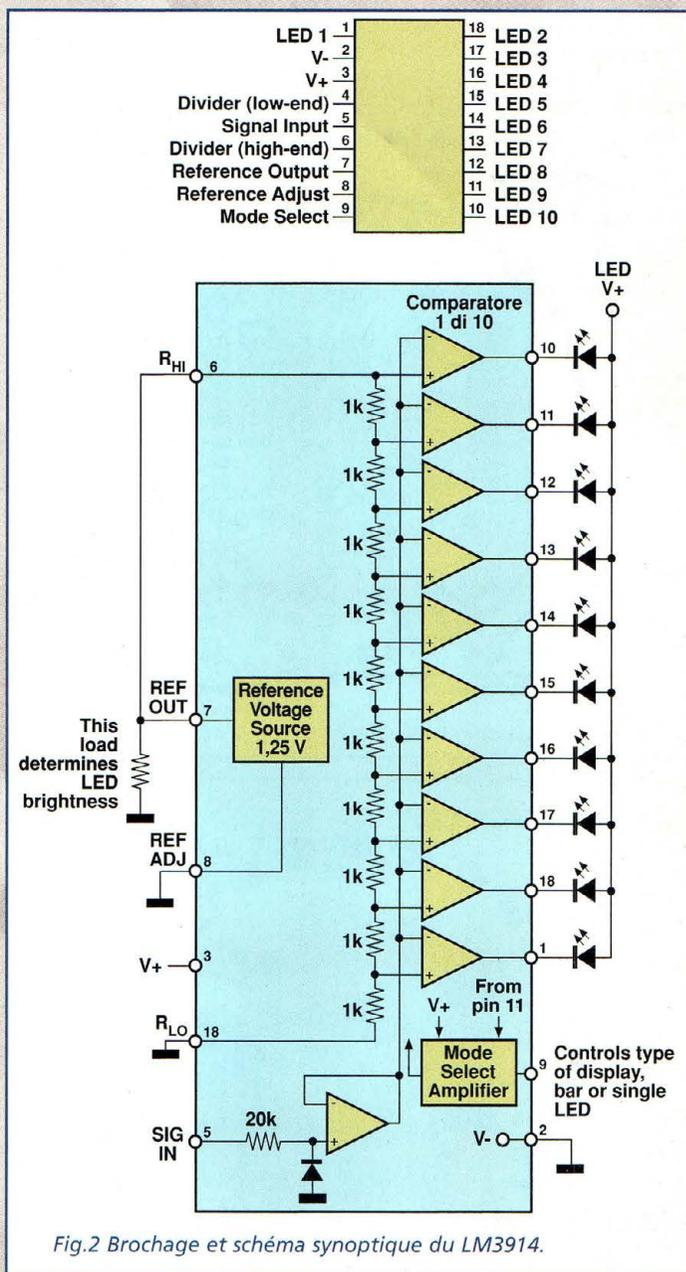
Fig.2 Brochage et schéma synoptique du LM3914.
