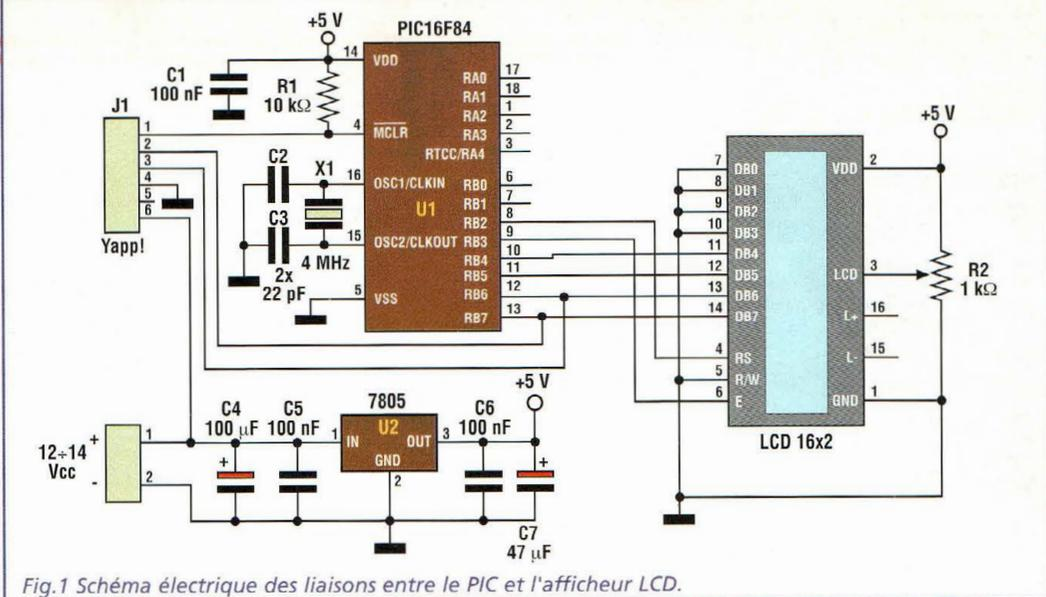
Fig.1 Schéma électrique des liaisons entre le PIC et l'afficheur LCD.
