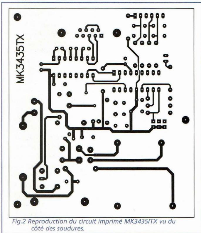
Fig.2 Reproduction du circuit imprimé MK3435/TX vu du côté des soudures.
