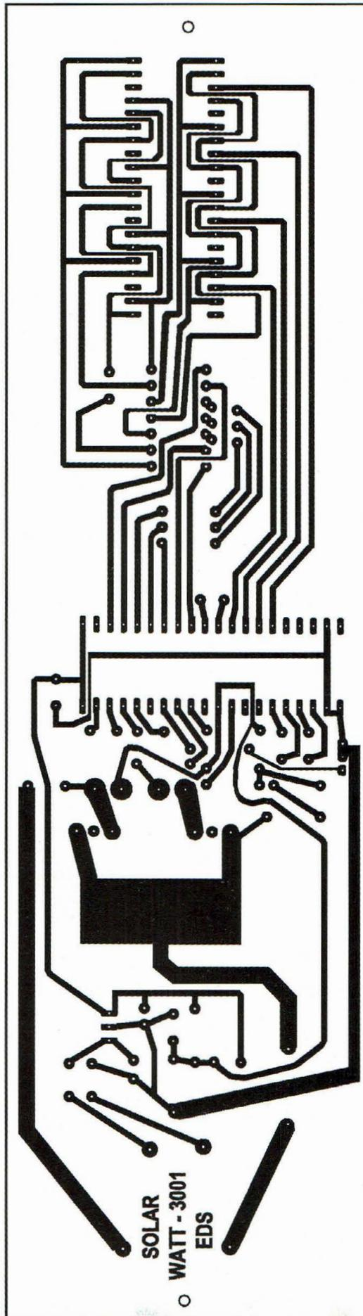
Fig.4 Reproduction à l'échelle 1 du circuit imprimé vu côté cuivre.
