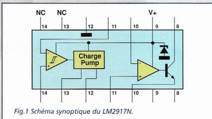
Fig.1 Schéma synoptique du LM2917N.
