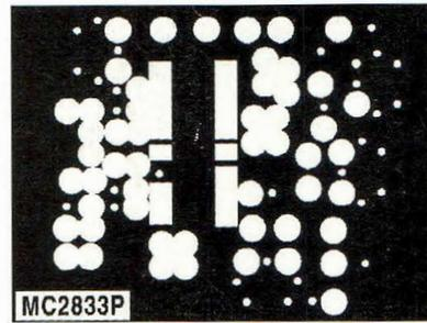
Fig.3 Plan de masse présent côté composants.
