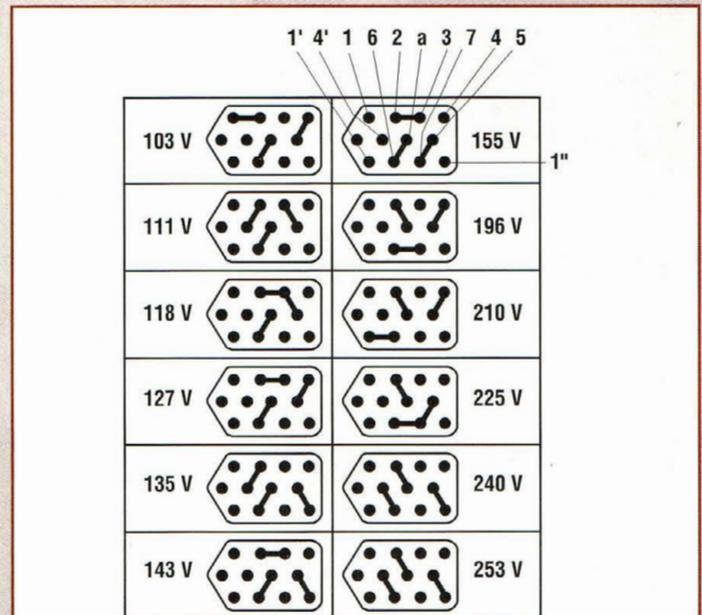
Schéma des connexions possibles pour l'adaptation de tension secteur.
