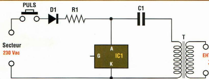
Fig.1B Schéma électrique de l'allume-gaz avec FLC01.
