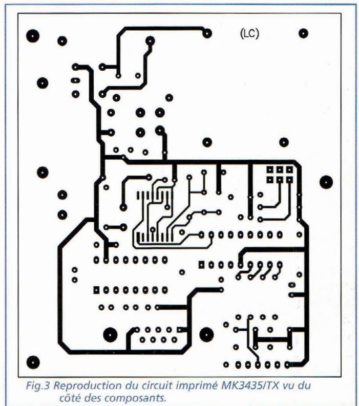
Fig.3 Reproduction du circuit imprimé MK3435/TX vu du côté des composants.
