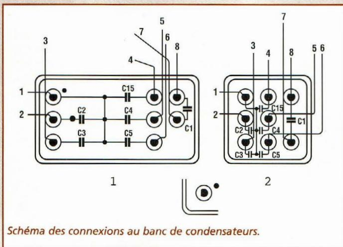
Schéma des connexions au banc de condensateurs.
