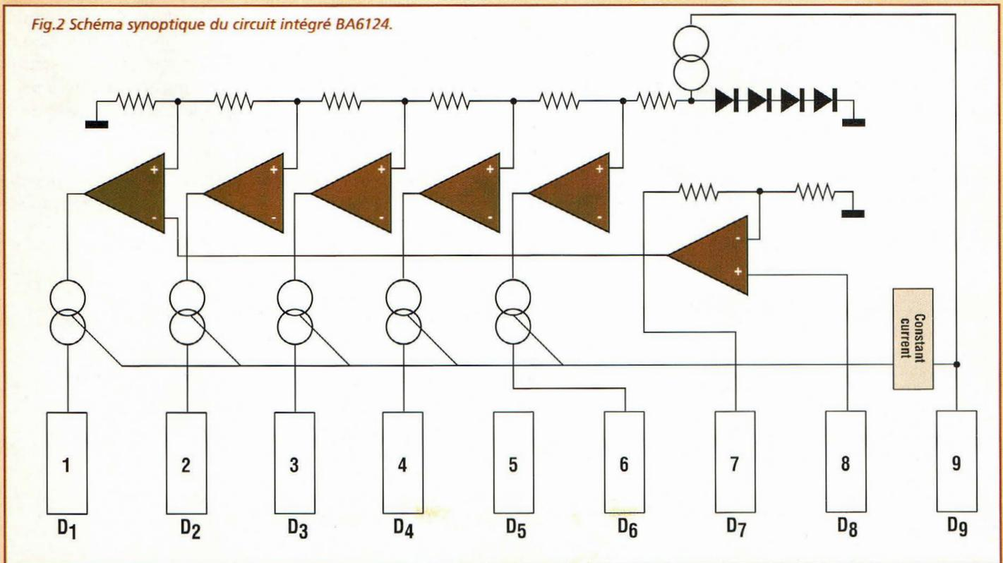
Fig.2 Schéma synoptique du circuit intégré BA6124.
