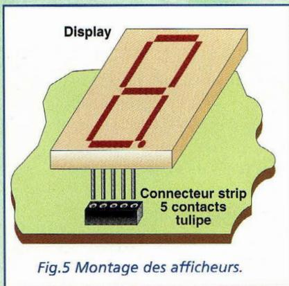
Fig.5 Montage des afficheurs.
