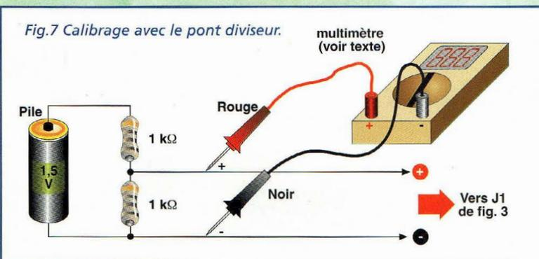
Fig.7 Calibrage avec le pont diviseur.
