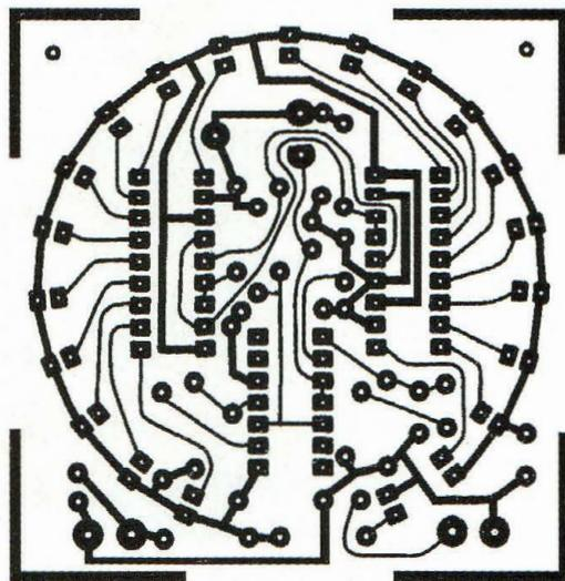
Fig.4 Reproduction du circuit imprimé du MK1490
