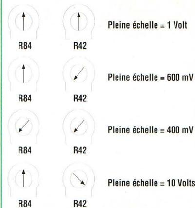
Fig.4 Relevés de position des curseurs des ajustables en fonction des configurations d'affichage les plus courantes.
