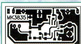
Fig.2 Reproduction à l'échelle 1 du circuit imprimé MK3835 vu du côté cuivre.
