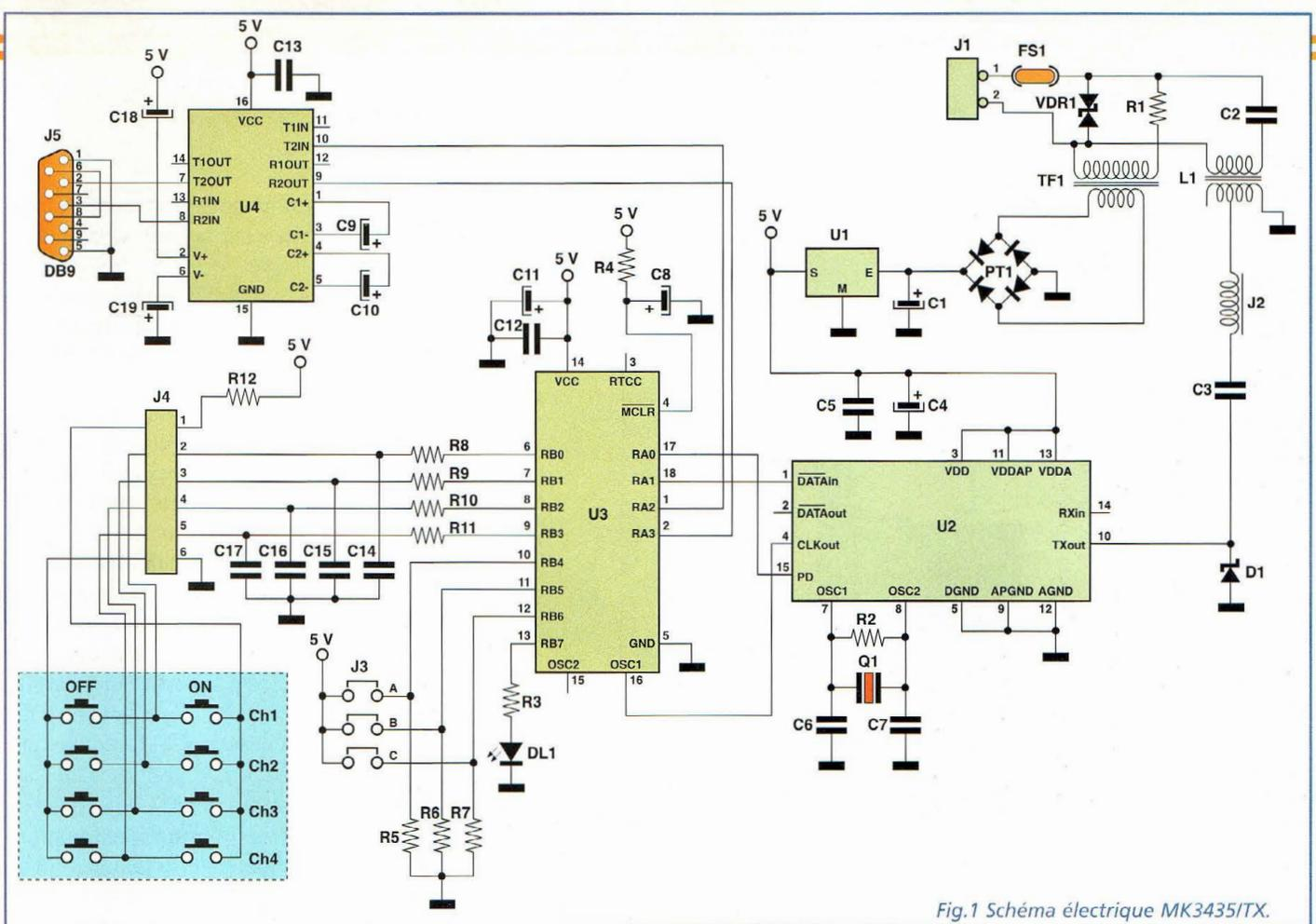
Fig.1 Schéma électrique MK3435/TX.
