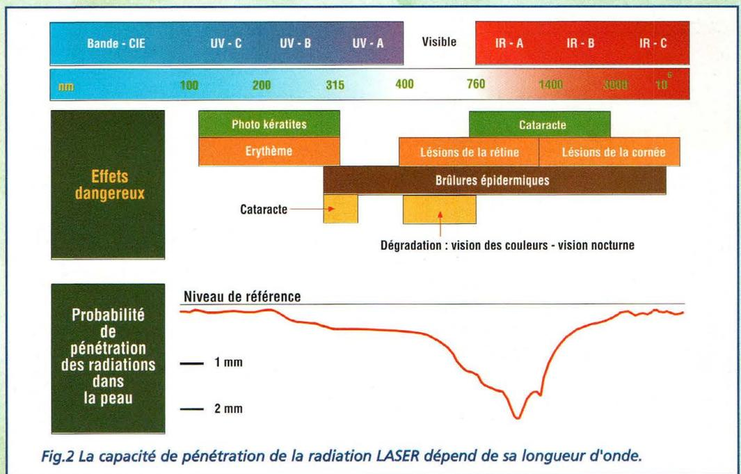
Fig.2 La capacité de pénétration de la radiation LASER dépend de sa longueur d'onde.
