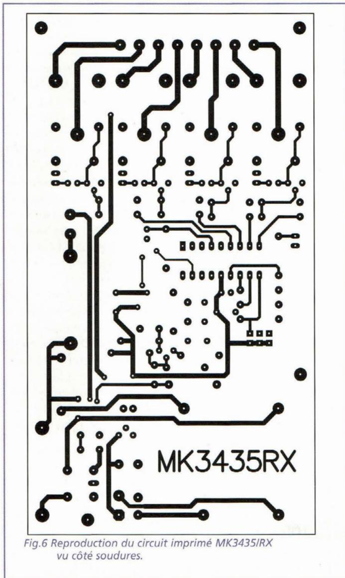
Fig.6 Reproduction du circuit imprimé MK3435/RX vu côté soudures.
