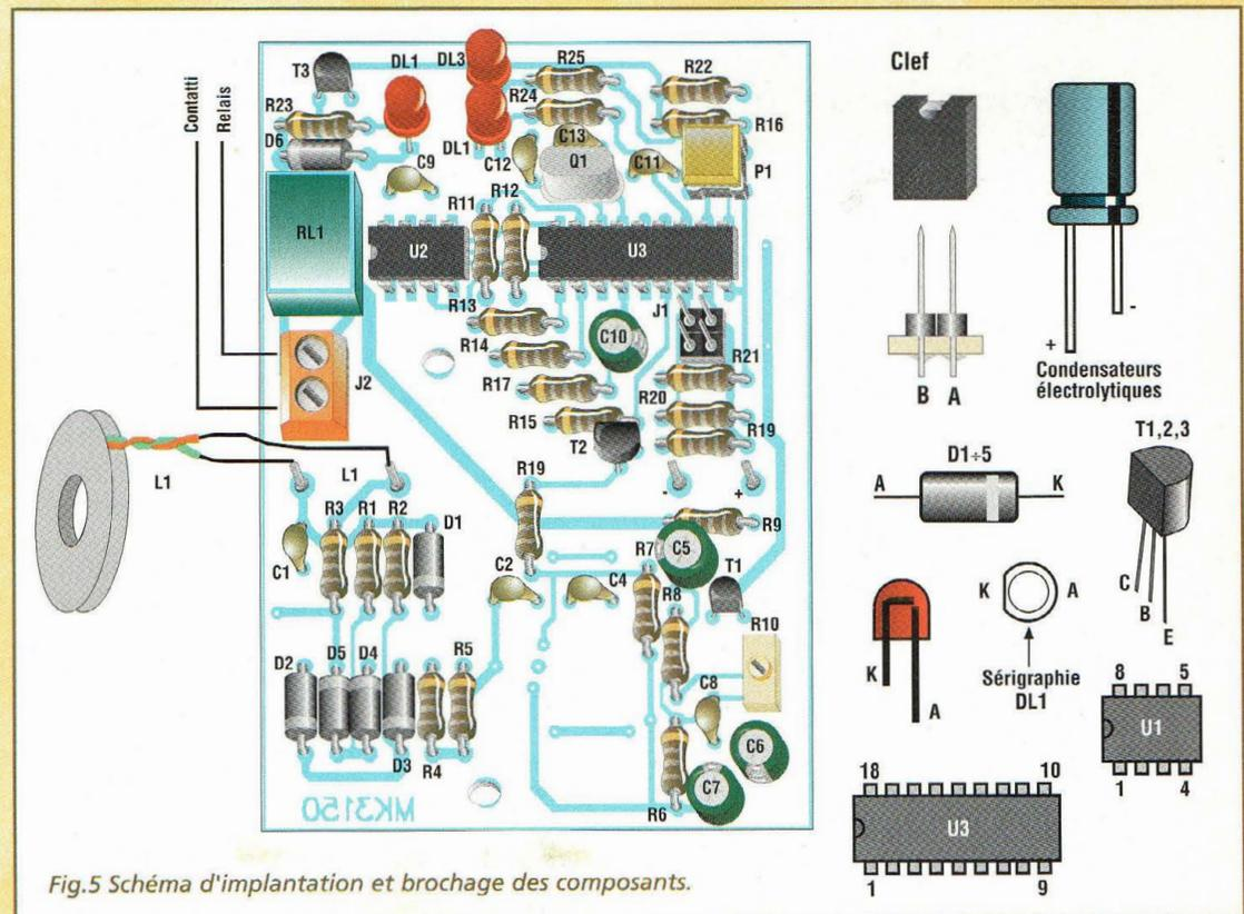
Fig.5 Schéma d'implantation et brochage des composants.
