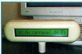
Fig.2 Le Plug'in fait défiler sur l'afficheur le titre du morceau joué par Winamp. (photo J.Launay)
