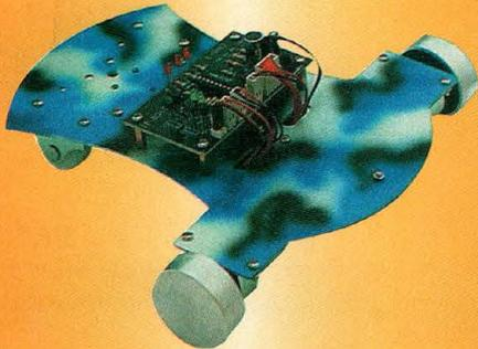
Suivi de ligne par 3 capteurs infrarouges • Propulsion par 2 moteurs 6V • Mise en route par signal sonore • En fonctionnement, émet une mélodie • Alimentation : électronique : 4 piles ou accus de type R6, propulsion : 4 accus de type R6 • Dimensions : 22 x 22 x 8 cm.
