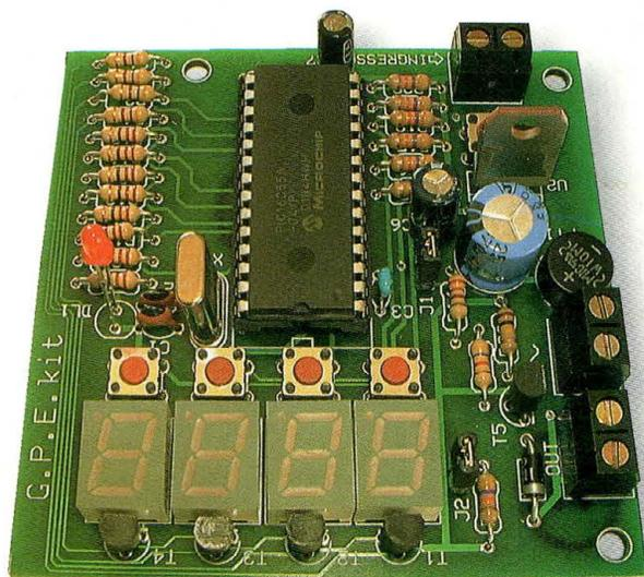
**S**olution à tous les problèmes de comptage, ce compteur universel est également capable d'assurer un déclenchement par comparaison avec une valeur de consigne ou lorsque le compteur passe par le zéro. Cette valeur est paramétrée par les poussoirs P1 à P5. L'affichage compte quatre afficheurs à LED. Lorsqu'une faible consommation est recherchée, la fonction blanking des afficheurs est prévue réduisant ainsi la consommation de 80% sans altérer la fonction de comptage.
