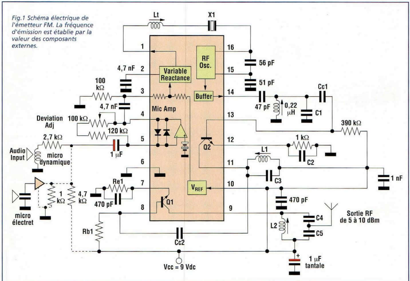
L'émetteur FM, dont le schéma électrique est reproduit en fig.1, dispose d'une puissance de +10dBm s'il fonctionne à une fréquence de 49,7 ou 76 MHz et d'une puissance de +5dBm sur 144,6 MHz, performances relevées pour une tension d'alimentation de 8 volts. La puissance n'est pas trop élevée vu que le circuit intégré MC2833 Motorola, qui constitue le cœur de l'émetteur, a été étudié pour les téléphones
