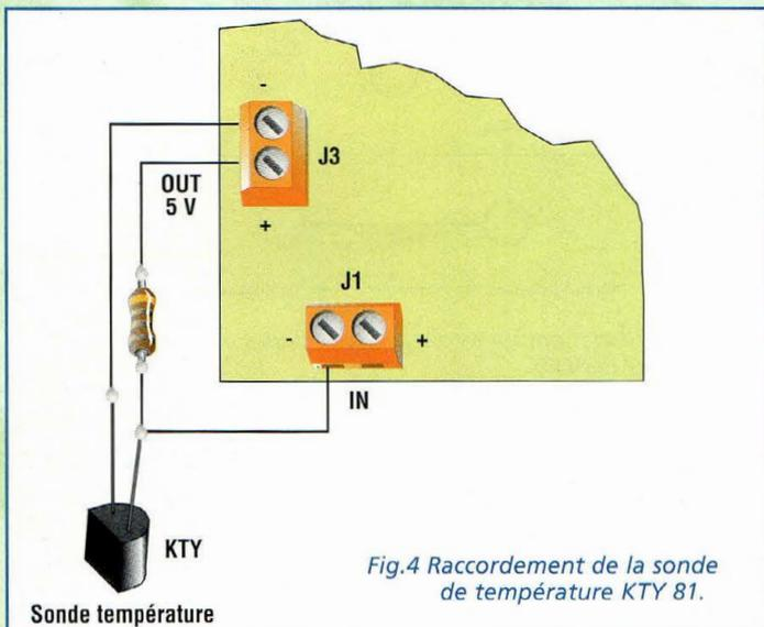
Fig.4 Raccordement de la sonde de température KTY 81.
