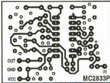
Fig.2 Reproduction à l'échelle 1 du circuit imprimé vu côté soudures.
