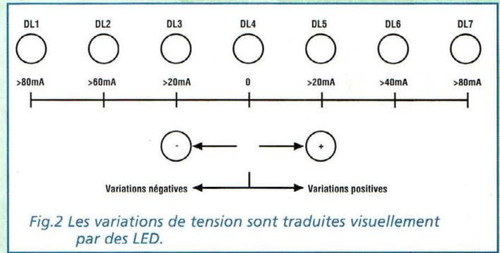
LED DL2 qui s'éclaire. Lorsque aucune variation n'est détectée, l'allumage de la LED verte DL1 témoigne d'une condition de stabilité.
