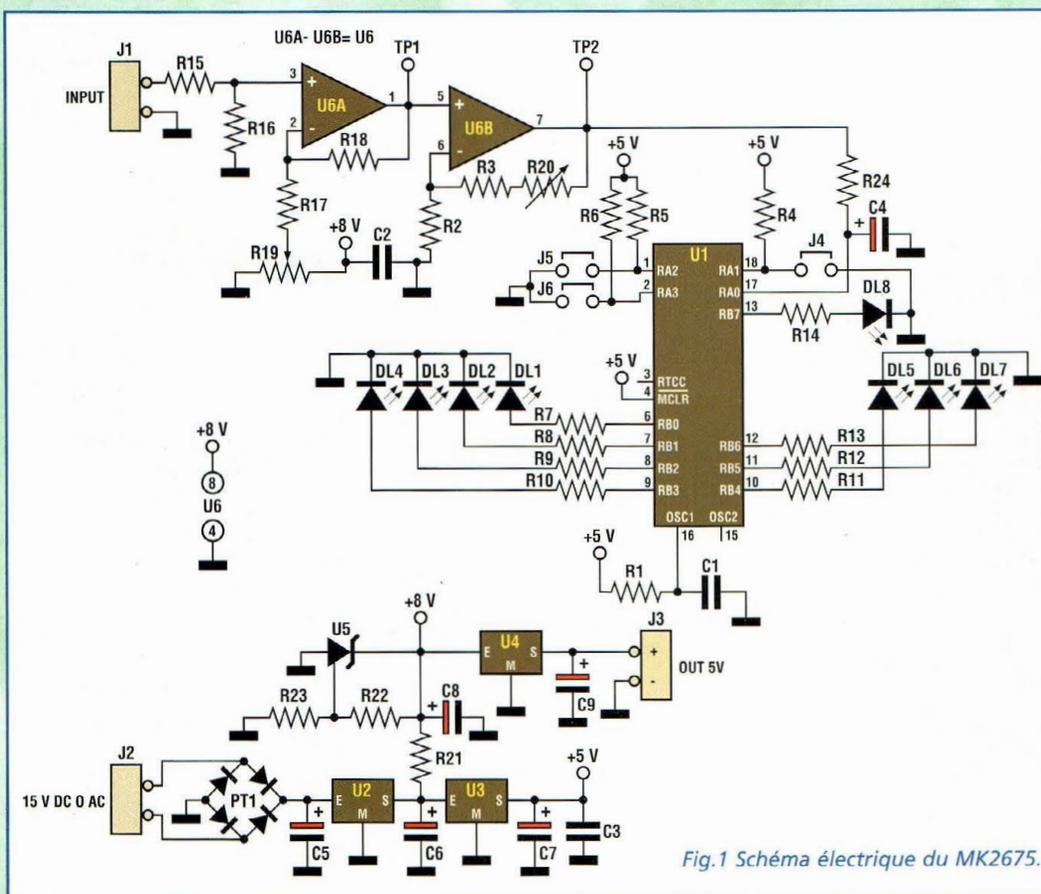
Fig.1 Schéma électrique du MK2675.
