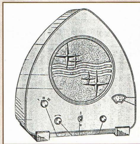
Ce modèle, entré en production dans la seconde moitié de 1930, est le premier appareil de construction Philips à rompre avec le style coffrets, qui à l'époque est omniprésent chez tous les constructeurs. De par son style, il représente alors une nouveauté capable de rivaliser face au design novateur des naissantes constructions "chapelles ou cathédrales" de l'école américaine.
