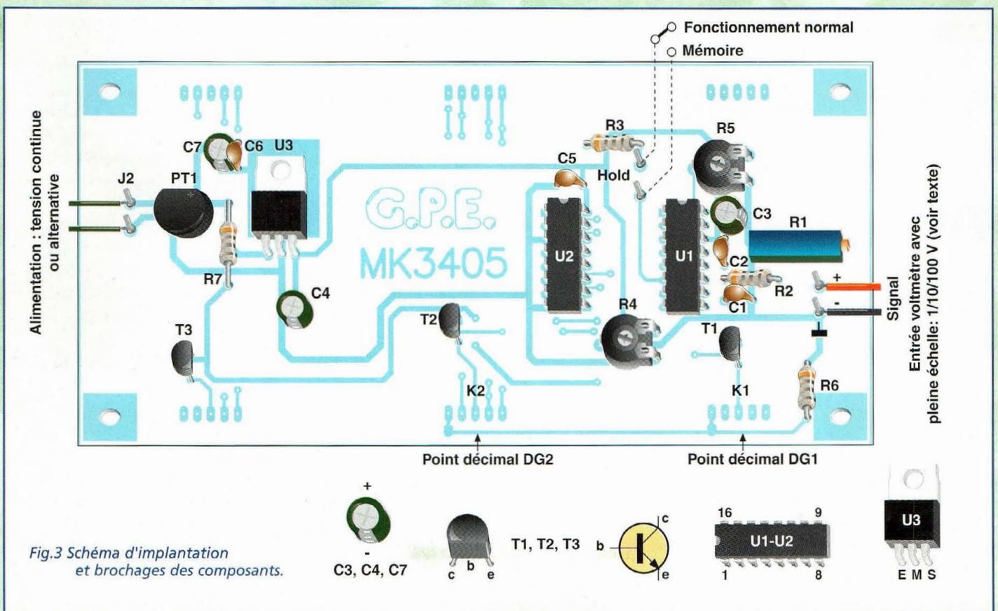
Fig.3 Schéma d'implantation et brochages des composants.
