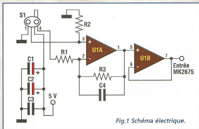
Fig.1 Schéma électrique.
