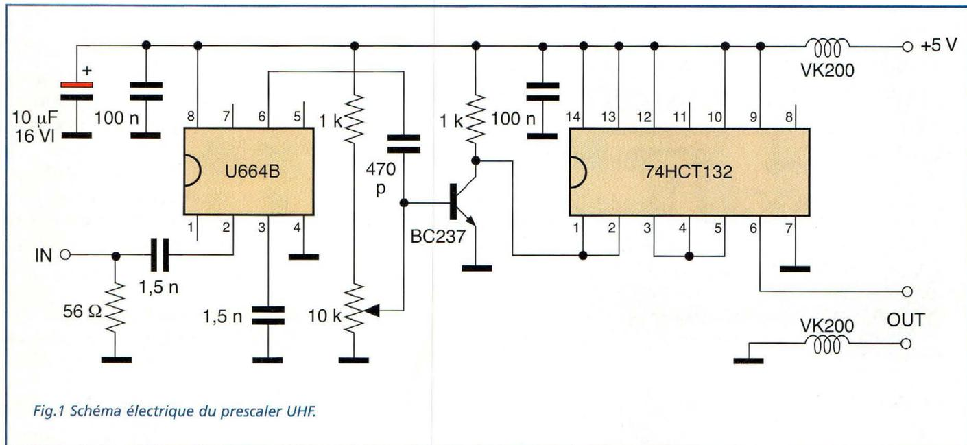
Fig.1 Schéma électrique du prescaler UHF.
