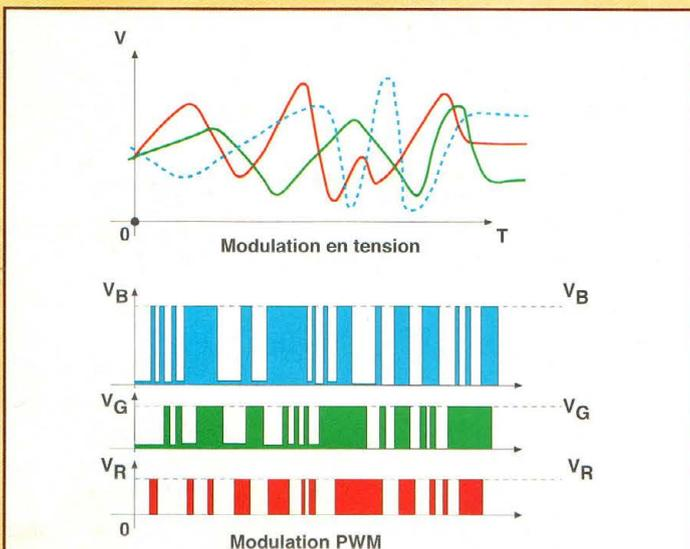
Fig.1 Modulation en tension et modulation PWM.
