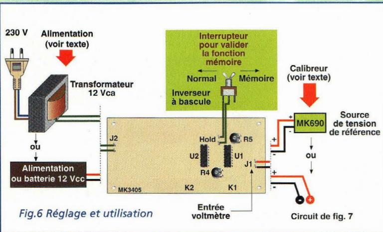
Fig.6 Réglage et utilisation
