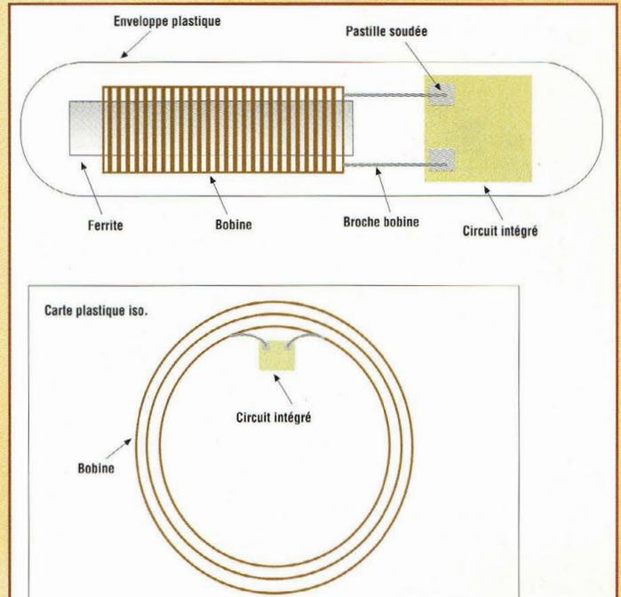
Fig.2 Différentes implantations possibles du procédé de clef électronique à transpondeur.
