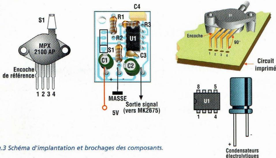
Fig.3 Schéma d'implantation et brochages des composants.
