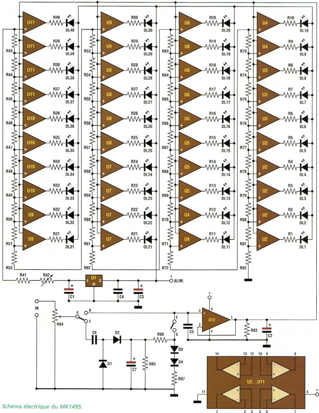
Fig.1 Schéma électrique du MK1495.
