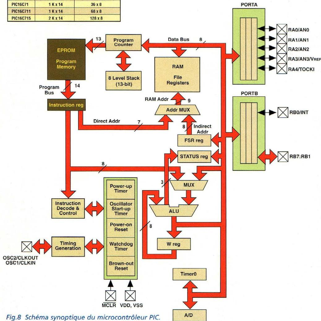
Fig.8 Schéma synoptique du microcontrôleur PIC.
