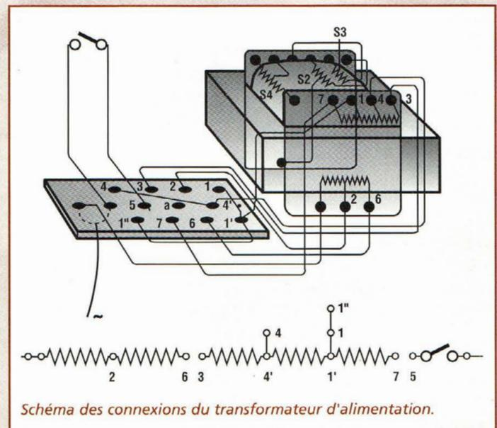
Schéma des connexions du transformateur d'alimentation.
