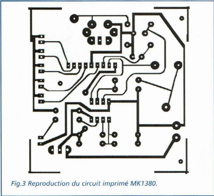
Fig.3 Reproduction du circuit imprimé MK1380.
