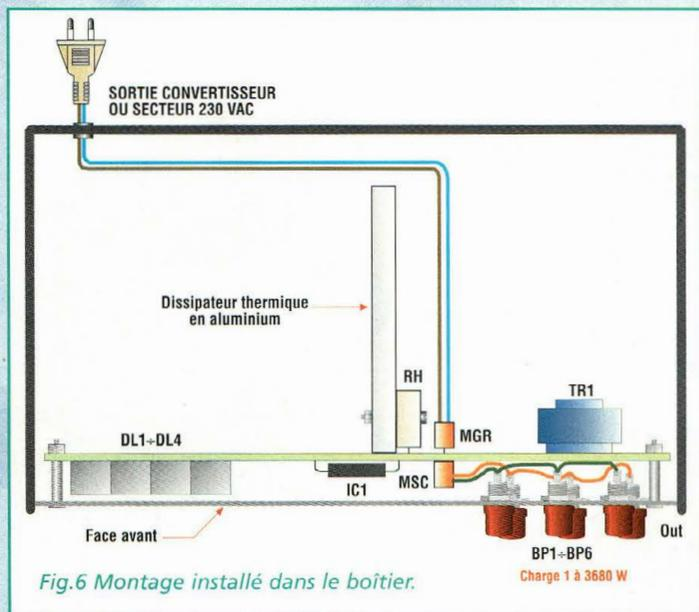
Fig.6 Montage installé dans le boîtier.
