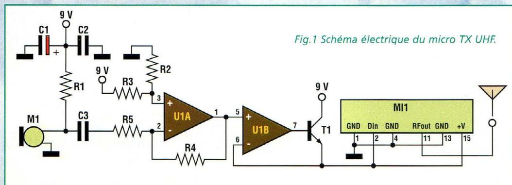
Fig.1 Schéma électrique du micro TX UHF.
