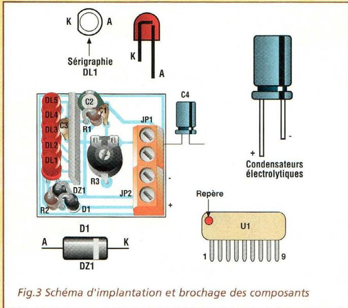
Fig.3 Schéma d'implantation et brochage des composants
