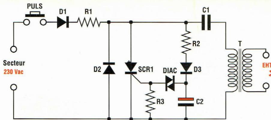
Fig.1 A Schéma électrique d'un allume-gaz à composants discrets en technologie classique.
