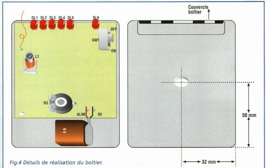
Fig.4 Détails de réalisation du boîtier.
