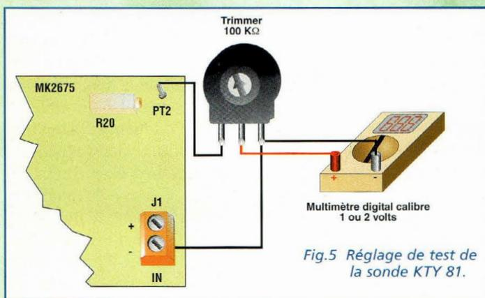
Fig.5 Réglage de test de la sonde KTY 81.
