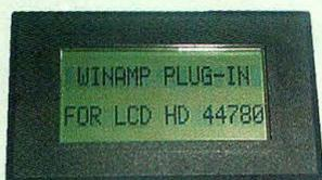
Fig.1. L'interface est conçue pour commander des afficheurs LCD au standard Hitachi HD44780. (photo J.Launay)
