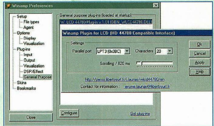
Fig.4 Un clic bouton droit sur le player Winamp permet d'accéder aux options de configuration. Le paramétrage du Plug'in permet de sélectionner le port parallèle, le type d'afficheur (16 ou 20 caractères) et la vitesse de défilement (scrolling). (photo J. Launay)
