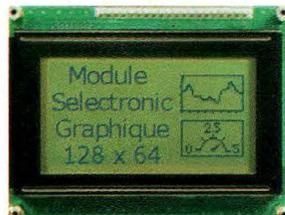
Contrôleur : KS0107/0108 • Avec convertisseur DC/DC intégré (réglage de contraste) • Alim. : 5V/160mA • Fenêtre : 72 x 40 mm • Dim. : 93 x 70 x 15 mm.
