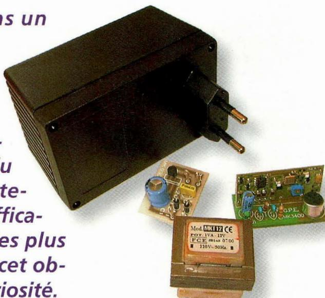
Nombre de micro émetteurs FM fonctionnent avec des piles, soit pour en minimiser les dimensions ou pour les rendre plus autonomes. Le MK3750 proposé ici est quelque peu différent car il est logé dans un boîtier comportant une prise 230 volts ce qui le prédispose à être directement alimenté par la tension secteur.
