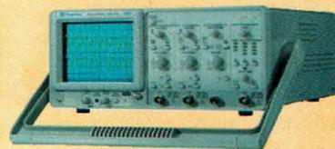
pulations. Il s'agit du modèle ISO-TECHISR658. Chez Metrix, le grand concurrent haut de gamme à moins de 10000 francs est la version OX863. Il s'agit d'un oscilloscope doté d'une bande passante de 150 mégahertz sur les deux voies avec un temps de montée de 3.5 nano secondes.
