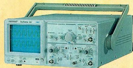
sures peuvent s'afficher pour les rapports de tensions exprimés en décibels. La gamme dynamique s'étend alors de -73 à + 40 dB. L'utilisation d'une sonde atténuatrice 10x augmente la mesure de 20 dB. Dans ces conditions, on obtient une dynamique allant de -53 à + 60 dB.
