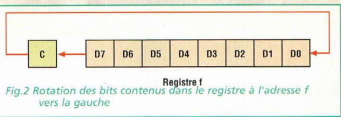
Fig.2 Rotation des bits contenus dans le registre à l'adresse f vers la gauche
