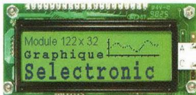
Contrôleur: SED1520 • Alim.: 5V/90mA. Fenêtre: 64 x 18 mm • Dim.: 84 x 44 x 10 mm.
