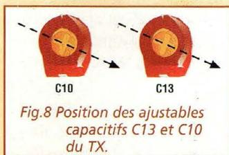
Fig.8 Position des ajustables capacitifs C13 et C10 du TX.
