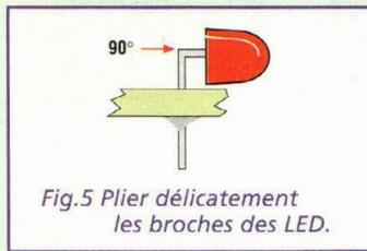
Fig.5 Plier délicatement les broches des LED.
