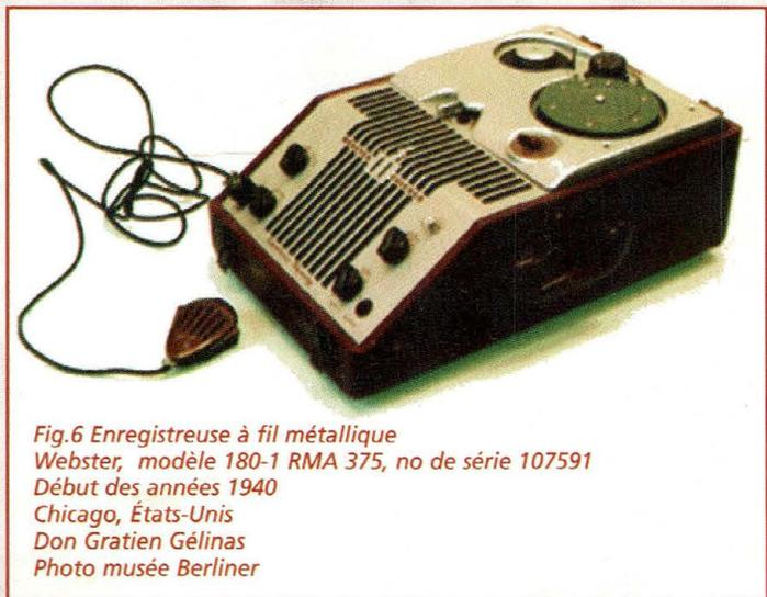
*Fig.6 Enregistreuse à fil métallique
