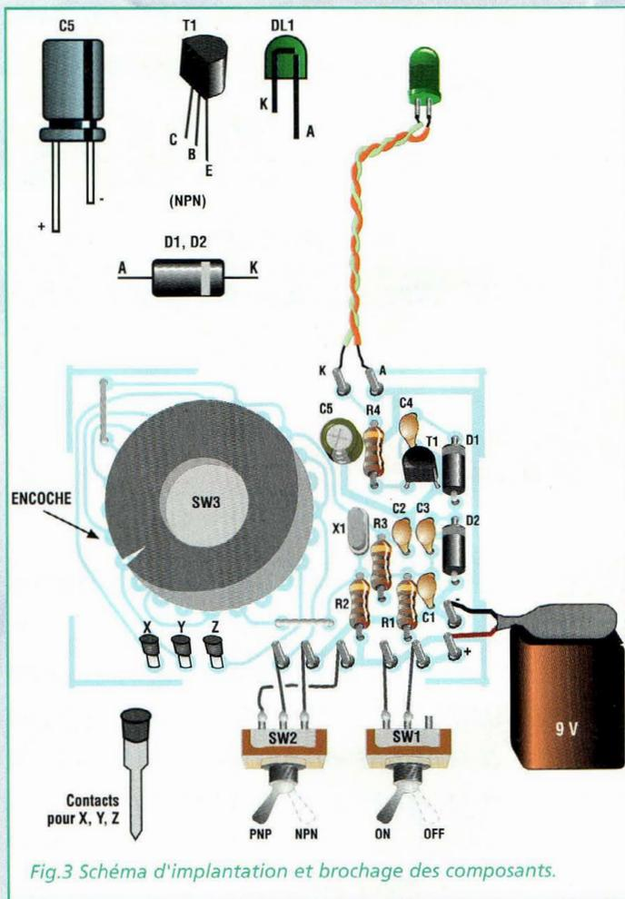
Fig.3 Schéma d'implantation et brochage des composants.
