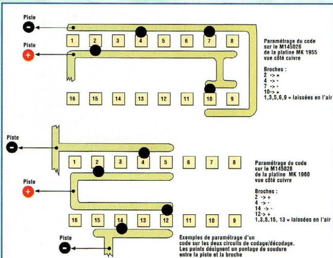
Fig.5 Détail de paramétrage des pontages de codage sous les circuits intégrés.
