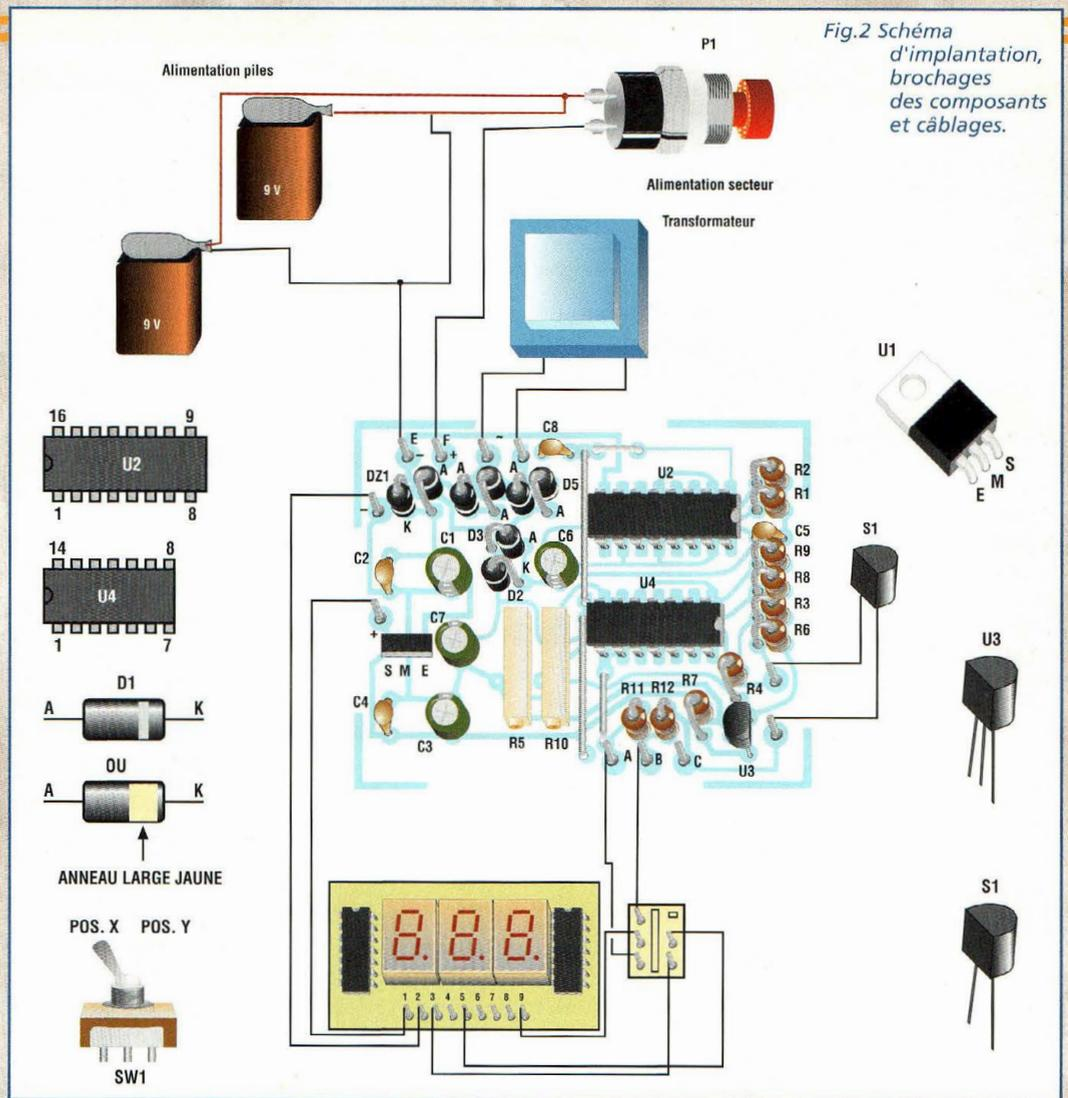
Fig.2 Schéma d'implantation, brochages des composants et câblages.
