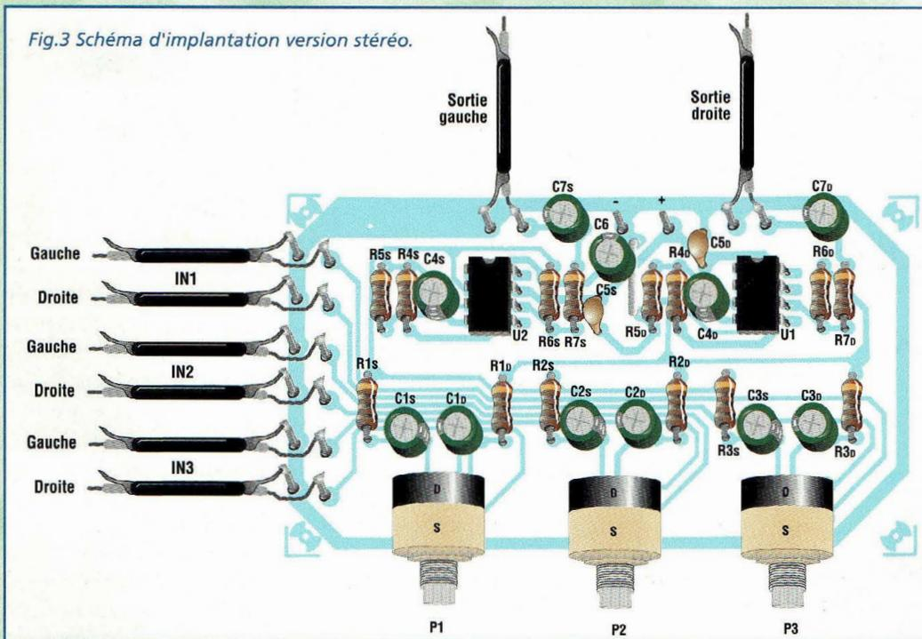
Fig.3 Schéma d'implantation version stéréo.
