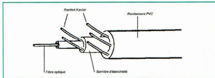
Fig.21 Constitution d'un câble monofibre extérieur
