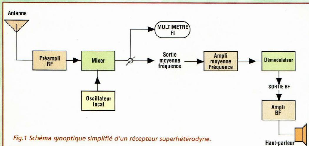
Fig.1 Schéma synoptique simplifié d'un récepteur superhétérodyne.
