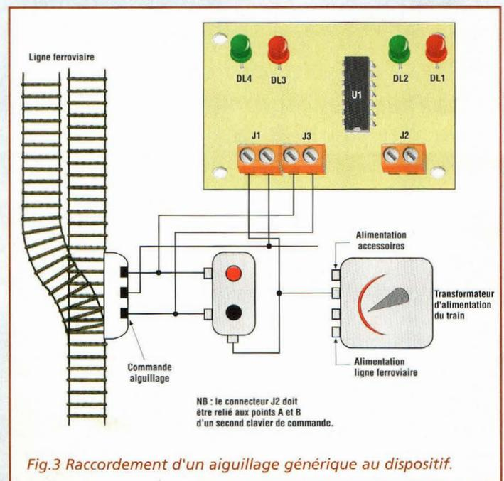
NB : le connecteur J2 doit être relié aux points A et B d'un second clavier de commande.
