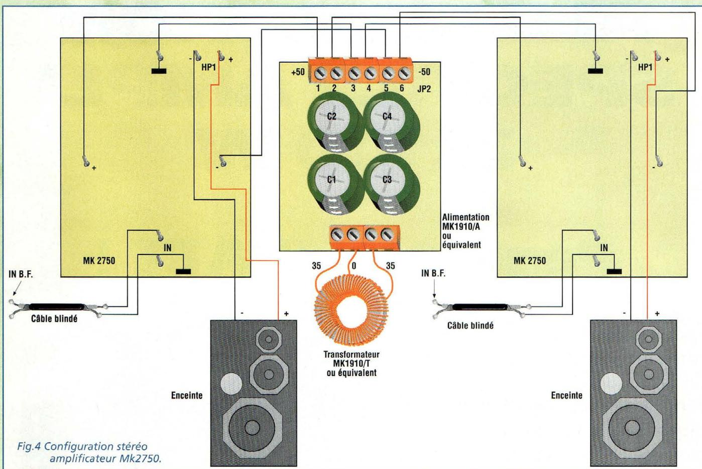
Fig.4 Configuration stéréo amplificateur Mk2750.
