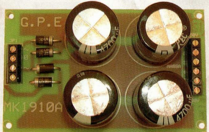
L'alimentation de puissance représentée dans le schéma de fig.1 est une alimentation classique pour amplificateurs B.F. Elle est formée d'un pont redresseur formé de diodes, suivie de condensateurs de capacité élevée (6800 pF x 2 sur chaque ligne d'alimentation)
