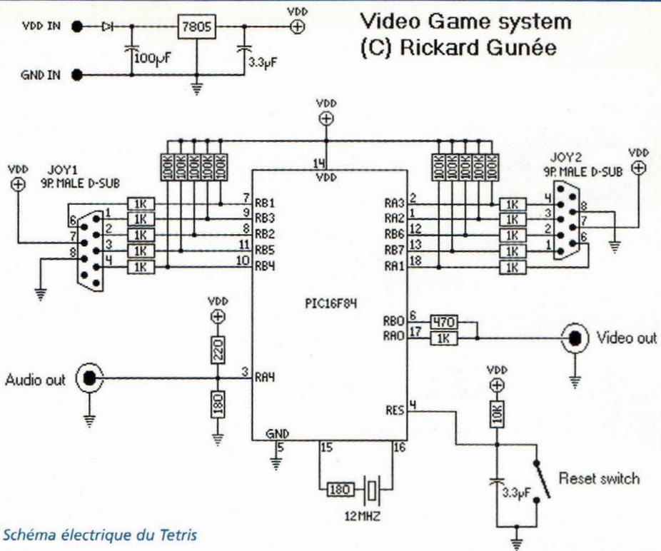
Fig.2 Schéma électrique du Tetris
