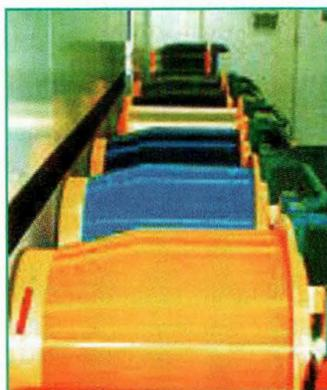
Fig.20 Enduites de résine synthétique et colorée, les fibres optiques sont enroulées autour des bobines. Photo Alcatel
