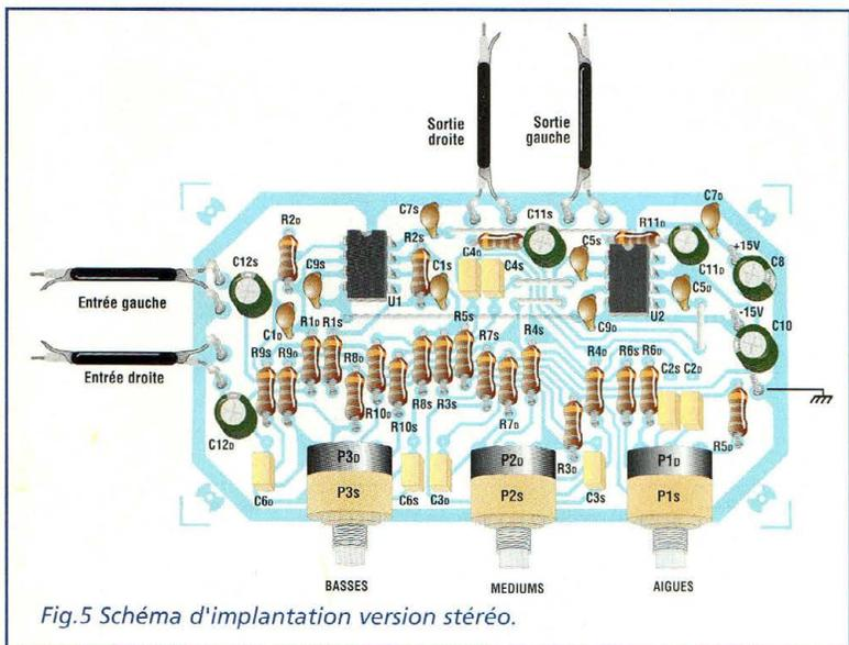
Fig.5 Schéma d'implantation version stéréo.
