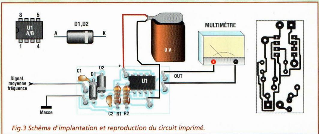
Fig.3 Schéma d'implantation et reproduction du circuit imprimé.
