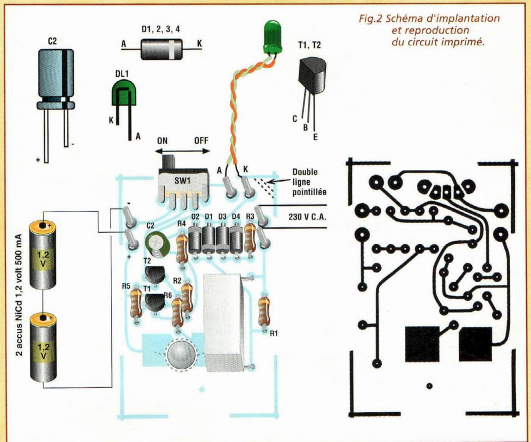
Fig.2 Schéma d'implantation et reproduction du circuit imprimé.
