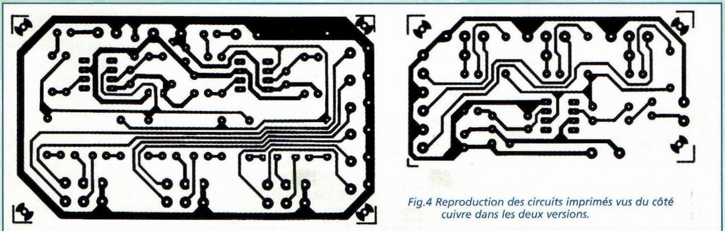
Fig.4 Reproduction des circuits imprimés vus du côté cuivre dans les deux versions.
