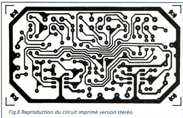
Fig.6 Reproduction du circuit imprimé version stéréo.
