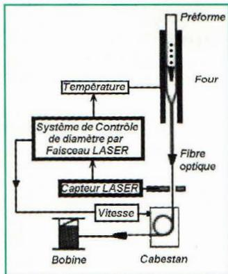
Fig.19 Représentation schématique du procédé de fibrage
