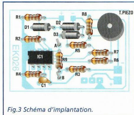
Fig.3 Schéma d'implantation.
