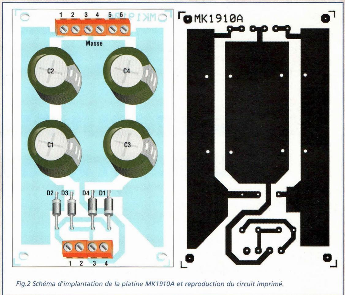
Fig.2 Schéma d'implantation de la platine MK1910A et reproduction du circuit imprimé.
