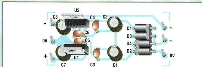
Fig.7 Schéma d'implantation de l'alimentation symétrique.
