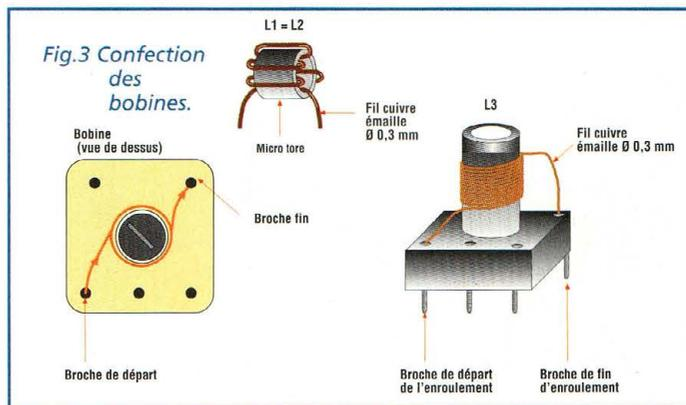
est strictement respectée. Noter ici deux observations importantes : la réalisation des bobines L1, L2 et L3 et les doubles soldures à effectuer sur quelques composants. Double soudure, car il convient de souder le composant des deux côtés de la platine, puisque la surface cuivrée sert de plan de masse pour le récepteur.
