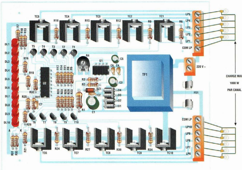
sants conformément au schéma d'implantation reproduit en fig.3. Veiller au sens d'engagement des composants polarisés : diodes, condensateurs
