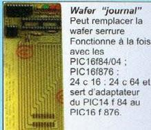
**Wafer "journal"** Peut remplacer la wafer serrure. Fonctionne à la fois avec les PIC16F84/04 ; PIC16F876 ; 24 c 16 ; 24 c 64 et sert d'adaptateur du PIC14 F84 au PIC16 F 876.
