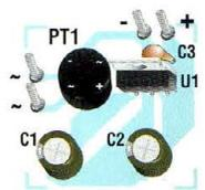
si avec une tension secondaire supérieure d'au moins 10% par rapport à la tension souhaitée. Par exemple, pour une tension stabilisée de 12 volts, utiliser un transformateur dont la tension secondaire est comprise entre 13,5 et 15 volts. Dans tous les cas, le transformateur doit fournir un courant minimum au moins égal à 350 mA.
