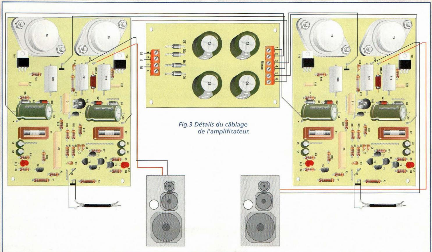
Fig.3 Détails du câblage de l'amplificateur.
