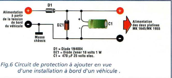
Fig.6 Circuit de protection à ajouter en vue d'une installation à bord d'un véhicule .
