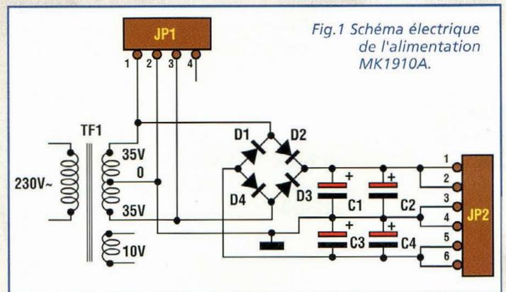
Fig.1 Schéma électrique de l'alimentation MK1910A.
