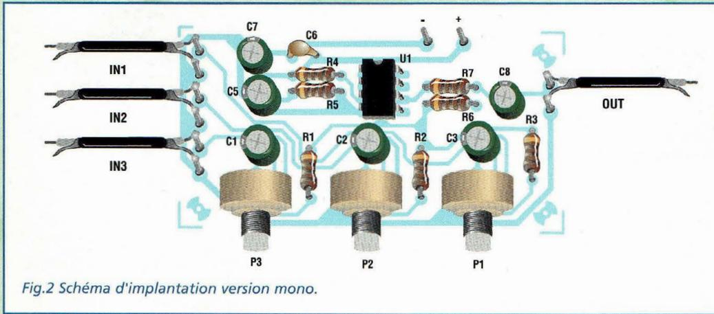
Fig.2 Schéma d'implantation version mono.
