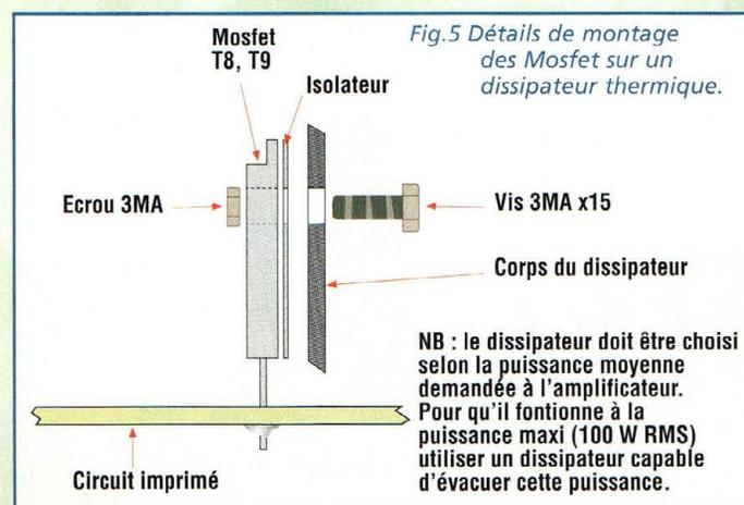
Fig.5 Détails de montage des Mosfet sur un dissipateur thermique.
