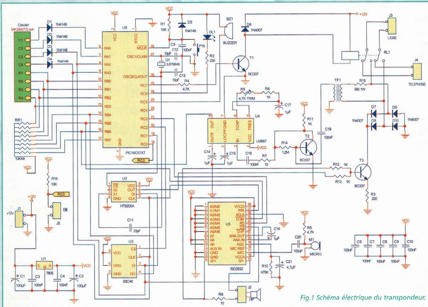
Fig.1 Schéma électrique du transpondeur.
