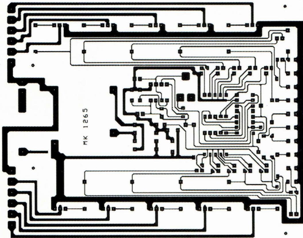
Fig.3 Schéma d'implantation et reproduction du circuit imprimé.
