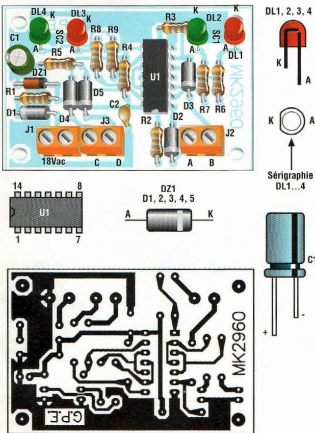
Fig.2 Schéma d'implantation, reproduction du circuit imprimé MK2960 et brochages des composants.
