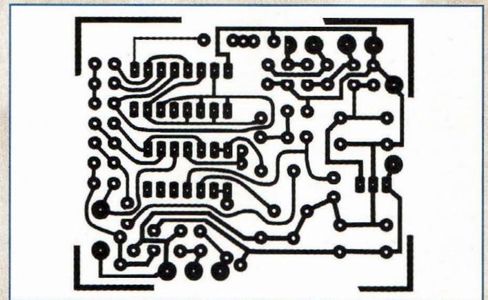
Le fonctionnement de U2 est très simple. En effet, c'est un générateur de tension alternatif (signal carré) à environ 1KHz. Cette tension est ensuite redressée par les diodes D2 et D3 puis utilisée comme tension de référence négative pour les amplis opérationnels renfermés en U4. U3 produit une tension d'environ 2,5 volts rigoureusement stable selon la température, qui sert pour alimenter le pont de Wheatstone où vient prendre place le capteur S1.
