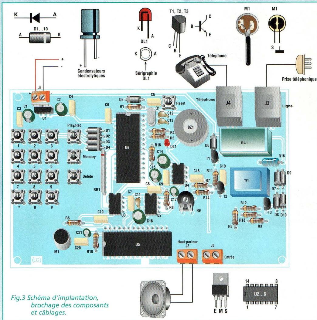
Fig.3 Schéma d'implantation, brochage des composants et câblages.
