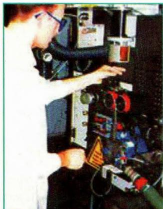
Fig.18 Une fois la préforme achevée, commence le fibrage proprement dit. Photo Alcatel.
