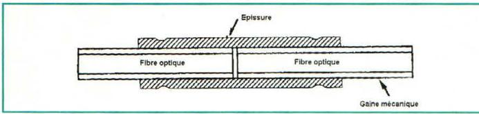
Fig.29 Epissure réalisée pour abouter deux fibres optiques
