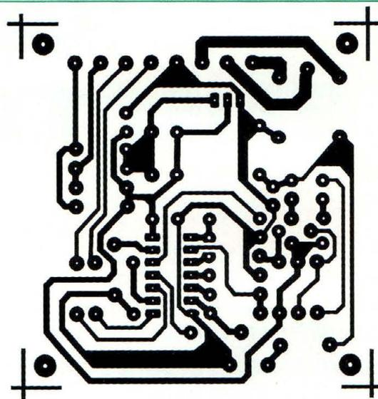
Fig.4 Reproduction du circuit imprimé vu du côté pistes.
