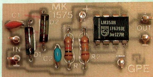
*pour les valeurs de moyenne fréquence de 455 KHz à plus de 36 MHz. Il remplace remarquablement l'oscilloscope pour l'estimation et la quantification du niveau des signaux de ces fréquences intermédiaires.*
