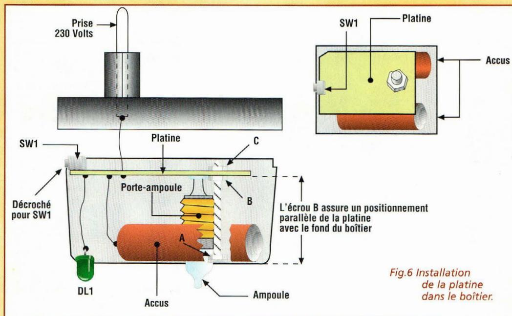
La longue vis filetée 3MA sera fixée au fond du boîtier avec la vis A. L'écrou B maintient la platine parallèle au fond du boîtier et l'écrou C assure la fixation de la platine.
