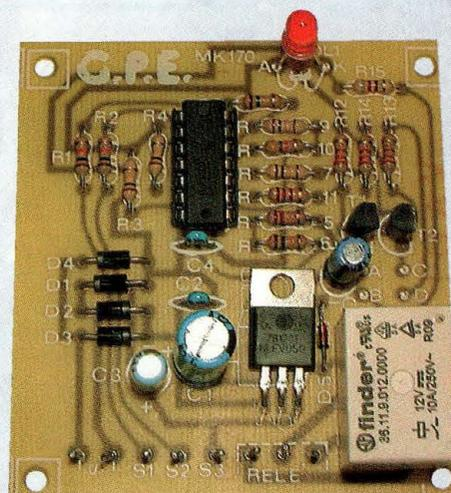
Le contrôle du niveau des liquides contenus dans un réservoir ou une citerne est indispensable dans le domaine agricole mais il trouve également nombre d'applications dans la vie courante. Cet appareil permet de contrôler le niveau d'eau ou de tout autre liquide non inflammable dans n'importe quelle cuve et permet surtout d'effectuer automatiquement le remplissage ou la vidange lorsque le niveau atteint un minimum ou un maximum.
