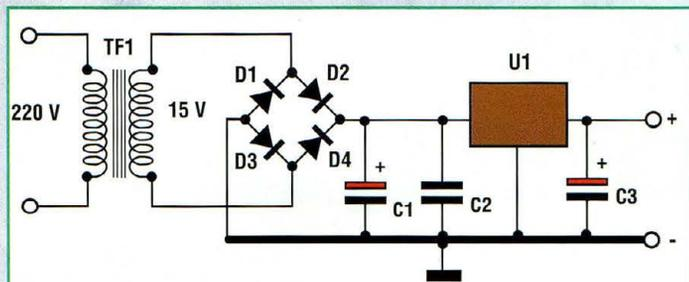
Fig.2 L'alimentation est capable de fournir une tension continue de 12 volts.
