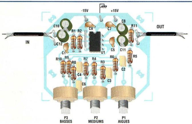
Fig.3 Schéma d'implantation version mono.
