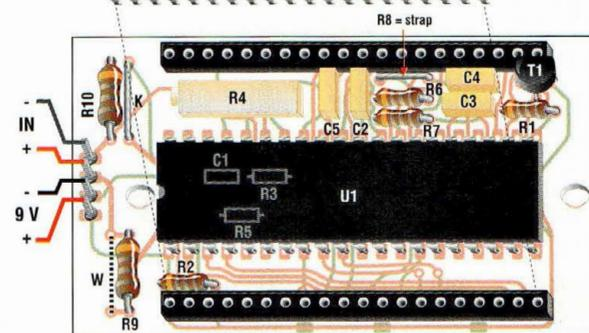
Fig.9 Schéma d'implantation MK595.
