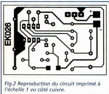
Fig.2 Reproduction du circuit imprimé à l'échelle 1 vu côté cuivre.
