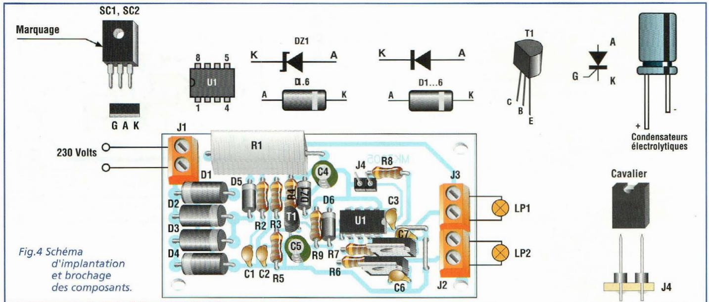
Fig.4 Schéma d'implantation et brochage des composants.
