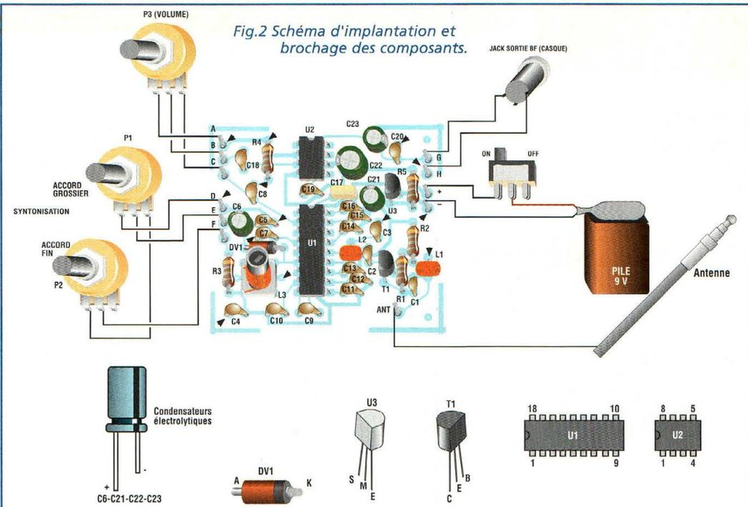
d'émetteurs lointains. L'accord est du type à diode varicap. La tension appliquée sur l'anode, provoque une variation de capacité et donc une variation d'accord du circuit oscillateur L3/DV1, qui permet de syntoniser le récepteur sur la fréquence à recevoir.
