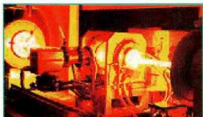
Fig.17 La fabrication de la préforme, un tube de verre qui donne naissance à des centaines de km de fibres optiques. Photo Alcatel
