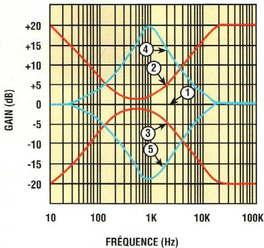
Fig.2 Diagramme de la réponse en fréquence avec quelques courbes obtenues en agissant sur les trois contrôles de tonalité.
