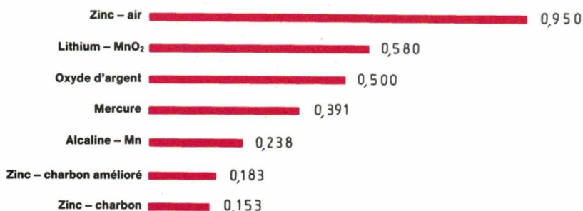
Fig. 9. - Caractéristiques comparées en densité d'énergie (W/h).
