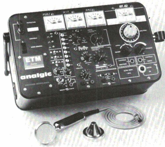
Fig. 15. - Ensemble de traitement dont l'un des modules délivre des courants antalgiques (doc. ETM).
