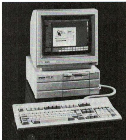
Le PC 2 dispose en entrées-sorties d'une porte parallèle et d'une porte série V24.
