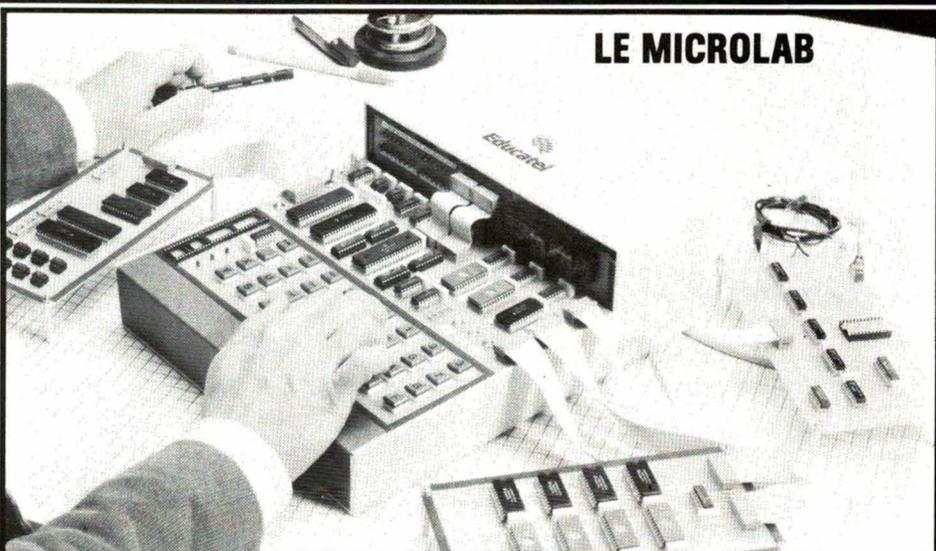
**CARACTÉRISTIQUES TECHNIQUES :** ● 1 Microprocesseur 6809 E ● Horloge 1 MHZ ● 1 Mémoire EPROM 2K OCTETS ● 1 Mémoire RAM 2K OCTETS ● 2 PIA 6821 ● 1 Timer 6840 ● 1 Affichage à 6 éléments ● 1 Visualisation adresses ● Données ● Signaux de contrôle du microprocesseur ● Un clavier...
