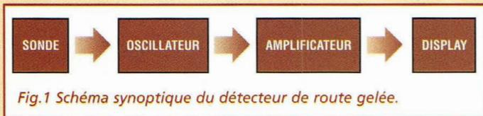
Fig.1 Schéma synoptique du détecteur de route gelée.
