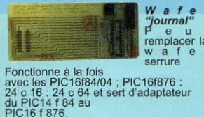
**Wafer "journal"** peut remplacer la wafer serrure. Fonctionne à la fois avec les PIC16F84/04 ; PIC16F876 ; 24 c 16 ; 24 c 64 et sert d'adaptateur du PIC14 F 84 au PIC16 f 876.
