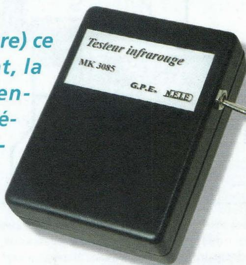
Ce petit dispositif très simple sert à déterminer immédiatement et sans démontage le fonctionnement correct d'une télécommande à rayons infrarouge. Pour différentes raisons, une télécommande à infra rouge
