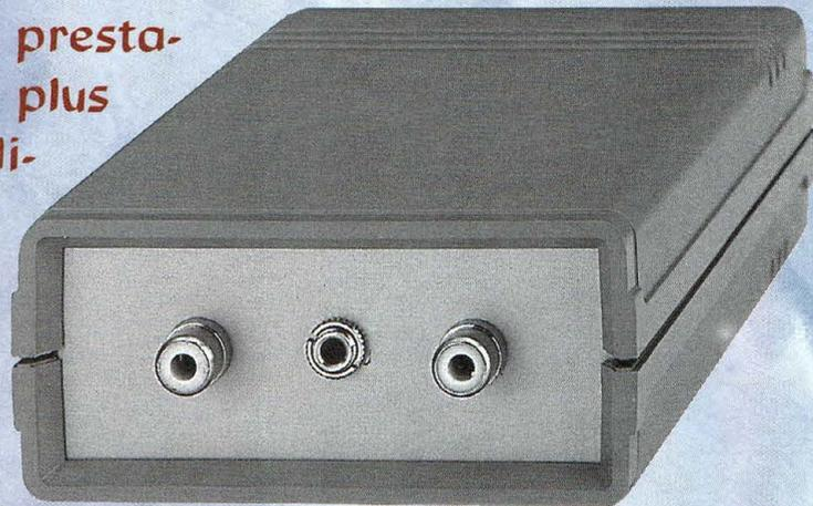
Fig.1 Le boîtier renfermant l'interface pour recevoir et émettre en SSTV et RTTY.
