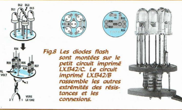
**Fig.8 Les diodes flash sont montées sur le petit circuit imprimé LX.1342/C. Le circuit imprimé LX.1342/B rassemble les autres extrémités des résistances et les connexions.**
