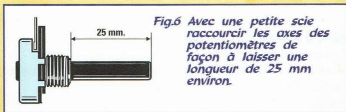
Fig.6 Avec une petite scie raccourcir les axes des potentiomètres de façon à laisser une longueur de 25 mm environ.
