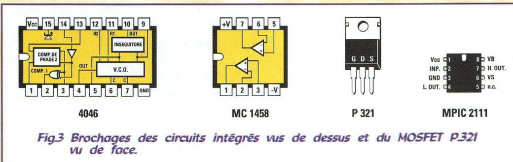
Fig.3 Brochages des circuits intégrés vus de dessus et du MOSFET P321 vu de face.
