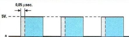
**Fig.5** Pour lire sur les afficheurs la valeur exacte du condensateur, il convient d'éliminer en phase de réglage l'impulsion de 0,05 μSec. Qui se rajoute à chaque impulsion, sinon l'étage intégrateur fournit une tension supérieure de 0,35 volt.
