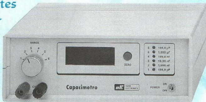
Cet appareil permet la mesure précise de tous les condensateurs dont la capacité est comprise entre 0,1 pF et 200 microFarads. Ce montage comporte un bouton poussoir pour compenser automatiquement les capacités parasites. Ce capacimètre d'une précision sans égale dispose de 6 gammes différentes sélectionnables à l'aide du commutateur placé sur la face avant.
