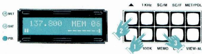
Fig. 55 En appuyant sur la touche 100 K et sur les touches P1 et P2 la nouvelle fréquence est accordée, puis appuyer sur la touche MEM.
