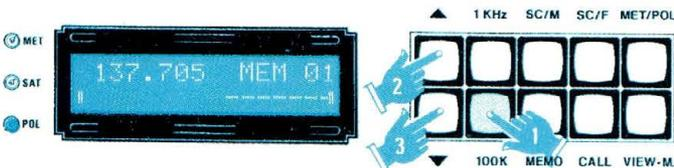
Fig.52 Pour modifier une fréquence de quelques centaines de KHz, appuyer sur la touche 100 K puis sur les touches P1 et P2.
