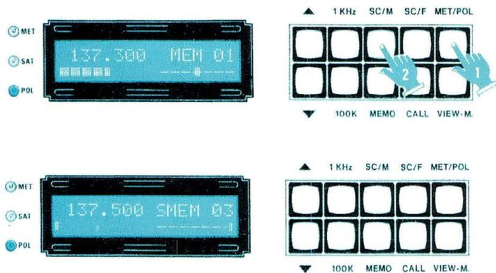
**Fig.44** Pour lancer le scanning mémoire, appuyer sur la touche MET/POL de façon que la LED POL s'allume, puis appuyer sur la touche SC.M.
