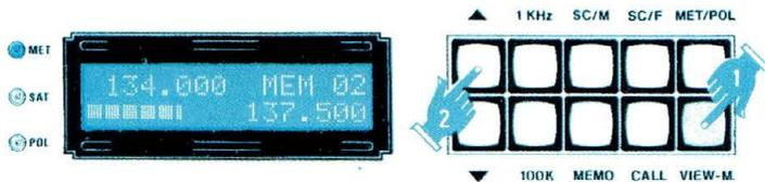
Fig.49 Pour voir quelles fréquences sont mémorisées, appuyer sur la touche VIEW.Memory puis sur les touches P1 et P2.
