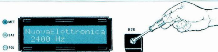
**Fig.29** Tourner l'ajustable R23 jusqu'à lire 2.400 Hz sur l'afficheur. Une tolérance de 10-16 Hz est admise.
