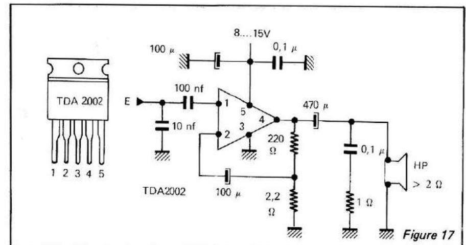
Une solution consiste à alimenter cet amplificateur basse fréquence à l'aide d'un régulateur de tension séparé du reste du montage, ou bien de fabriquer un régulateur accessoire à l'aide d'un transistor PNP dont le  $V_{ce\ sat}$  est faible —figure 18—. Ce dernier montage est surtout utile si l'on veut s'alimenter à partir d'une batterie.
