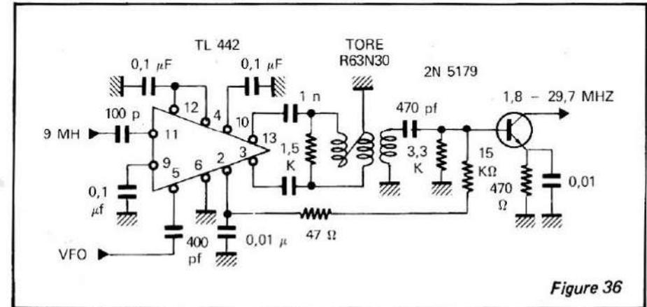
typique. On notera que la sortie du mélangeur se fait sur un transformateur à large bande réalisé à l'aide d'un tore de ferrite à haute perméabilité, comme le modèle Siemens R6,3 N30, sur lequel on bobine deux enroulements: le premier comporte deux fils torsadés et représente la charge du circuit intégré; le
