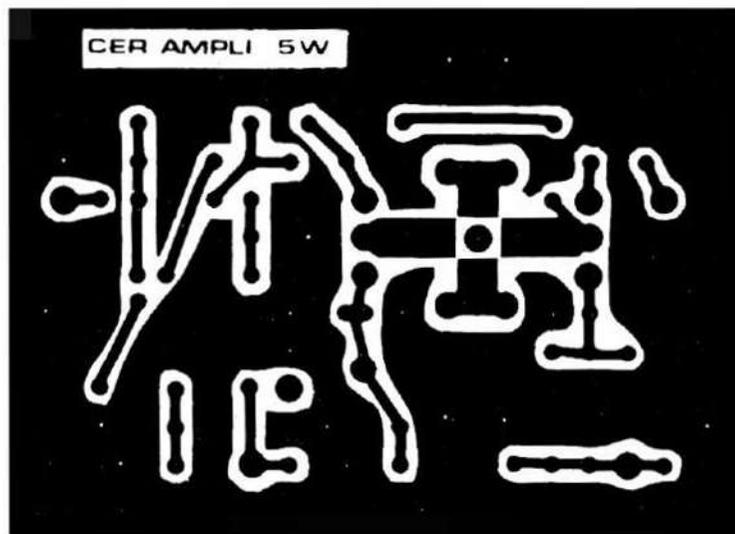
– résistances d'émetteur non découplées: 4 résistances de 3,3 ohms. De plus, ces résistances d'émetteur évitent l'emballement thermique du transistor. Comme le courant collecteur est constant, il n'y a pas besoin d'un système évolué pour la polarisation de la base, et un simple pont résistif, incluant un potentiomètre de 100 ohms, permet de régler le courant de repos.
