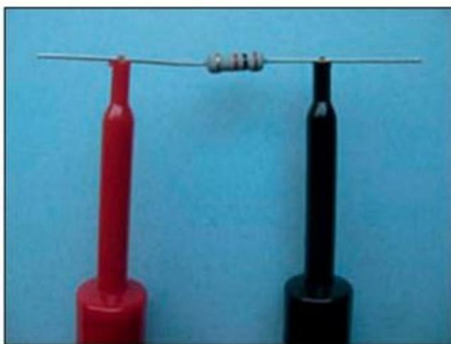
**FIGURE 5-9** À l'aide de votre multimètre, mesurez la valeur réelle d'une résistance fixe (en ohms).
