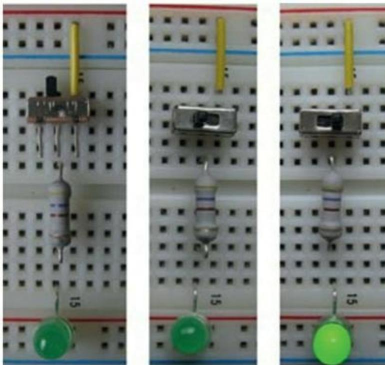
**FIGURE 4-13** Un inverseur simple utilisé comme interrupteur marche/arrêt.
