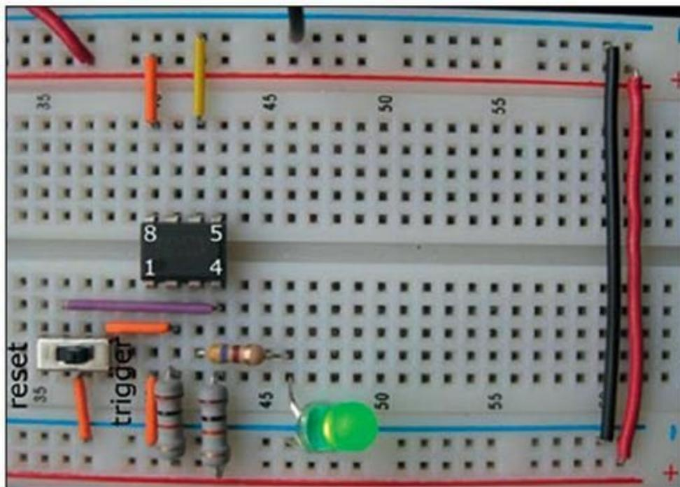
**FIGURE 11-20** Dans ce circuit de multivibrateur bistable, l'inverseur SPDT est utilisé pour déclencher la minuterie 555 et pour la réinitialiser (les numéros des broches et les légendes autour du curseur ont été ajoutés).
