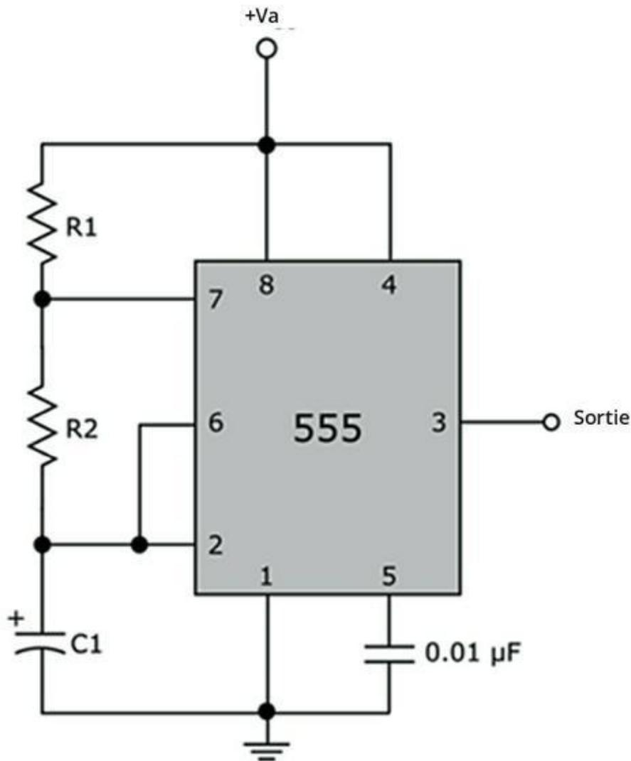
**FIGURE 11-15** Configuration du circuit d'un multivibrateur astable 555.
