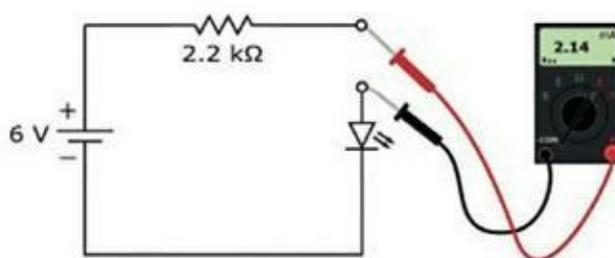
**FIGURE 16-9** Pour mesurer l'intensité du courant, branchez le multimètre en série avec le circuit ou le composant concerné.
