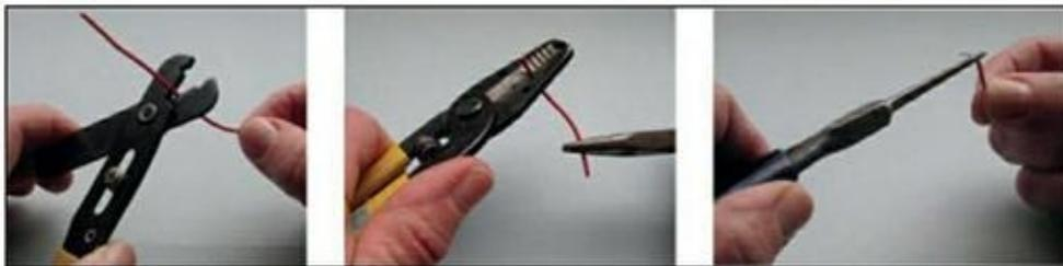
FIGURE 15-5 Couper, dénuder et tordre un fil d'interconnexion.
