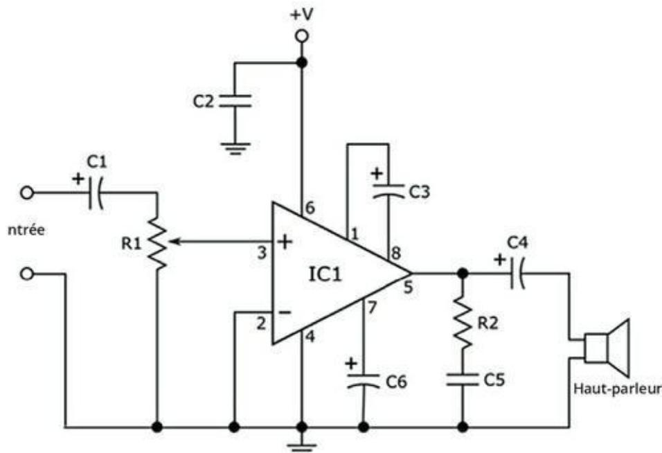
**FIGURE 17-7** Schéma d'un petit amplificateur.
