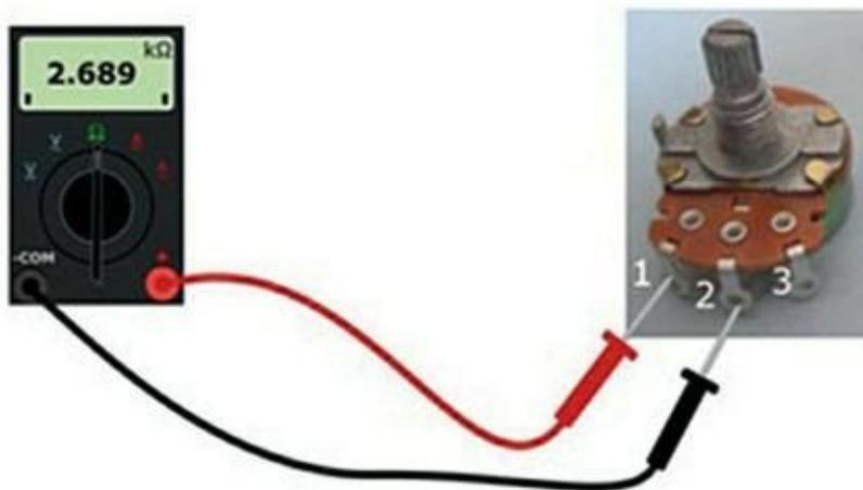
**FIGURE 16-10** Branchez les électrodes de test à la première borne et à la borne centrale, puis à la borne centrale et à la troisième borne, puis à la première et à la troisième borne du potentiomètre.
