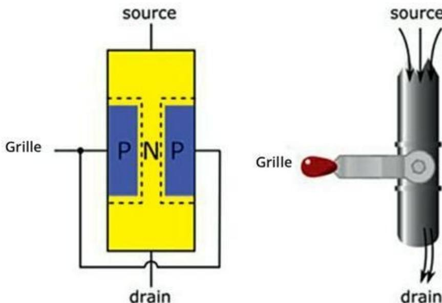
**FIGURE 10-5** Un transistor, comme une valve, peut être éteint (pas de courant), entièrement passant (courant maximal) ou partiellement passant (la circulation du courant entre la source et le drain dépendant de la plus ou moins grande ouverture de la grille, pour ainsi dire).
