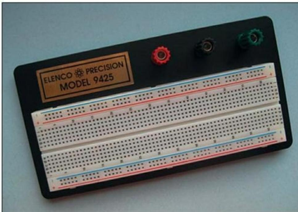
**FIGURE 15-1** Il existe des plaques d'essais sans soudure de différentes tailles. Celle-ci comporte 830 trous, quatre rails d'alimentation et trois bornes pour la liaison avec une source d'alimentation externe.
