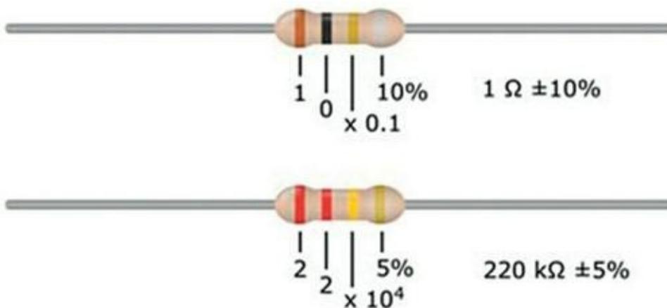
**FIGURE 5-10** Décodez la série de bandes colorées pour déterminer la résistance.
