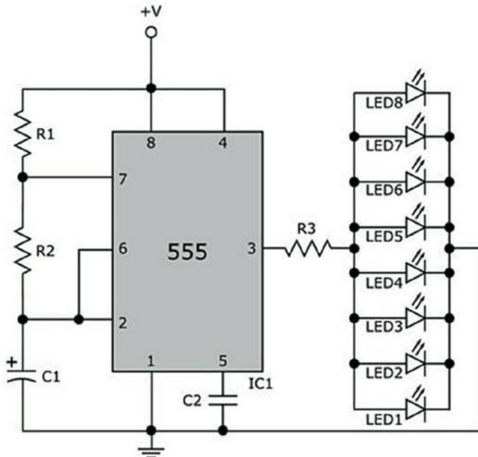
**FIGURE 17-3** Circuit pour une lumière clignotante à l'arrière d'un vélo. Les valeurs de  $R1$ ,  $R2$  et  $C1$  sont choisies de manière à obtenir un rythme de pulsation rapide pour le clignotement des LED.
