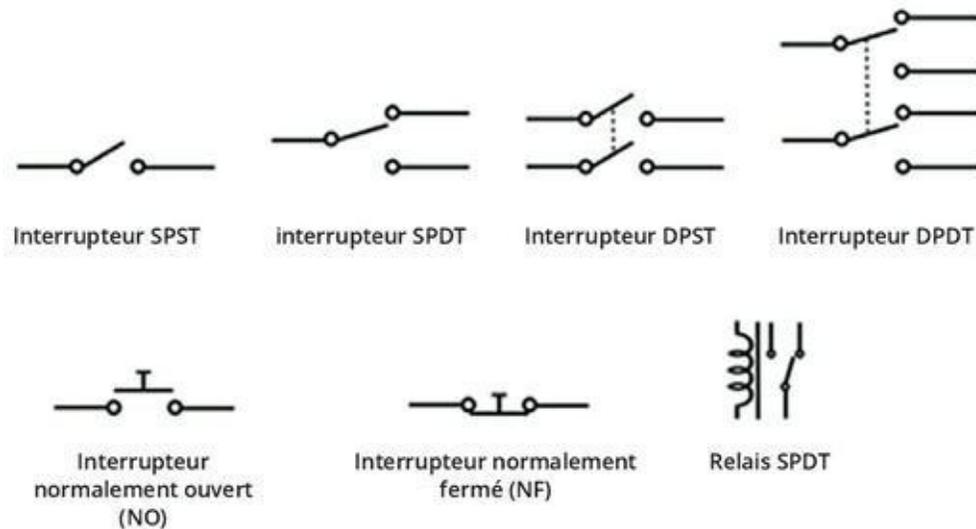
**FIGURE 14-10** Symboles des interrupteurs et des relais.
