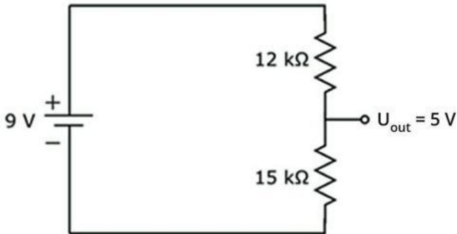
**FIGURE 6-3** Ce circuit diviseur de tension réduit une tension d'alimentation de 9 V à une tension de sortie de 5 volts.
