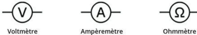
**FIGURE 14-13** Symboles des instruments de mesure les plus courants.
