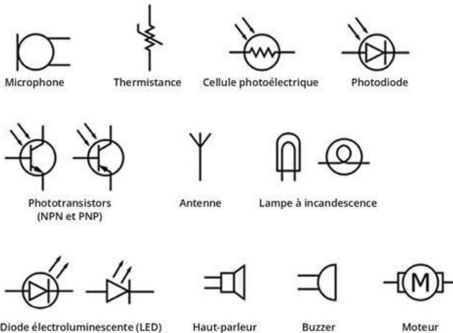
**FIGURE 14-11** Symboles des transducteurs d'entrée et de sortie.
