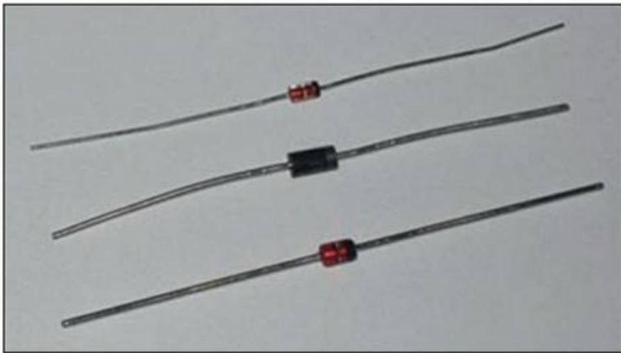
**FIGURE 9-1** Les diodes sont des composants semi-conducteurs à deux bornes, similaires aux résistances du point de vue de leur taille et de leur forme.
