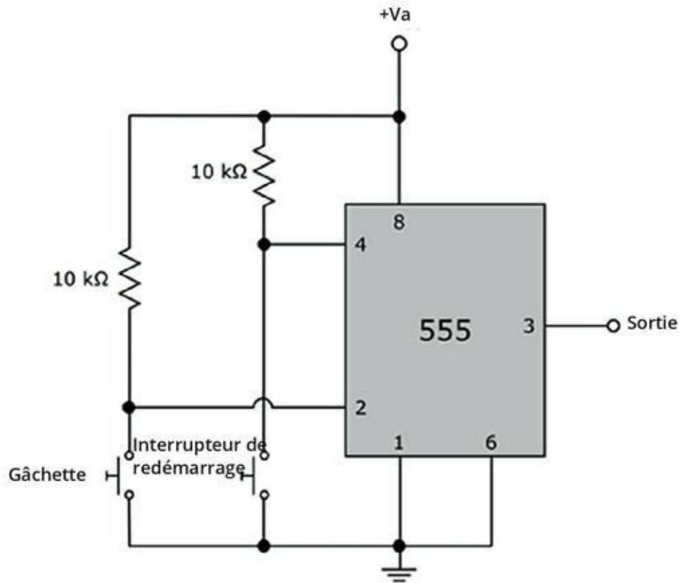
**FIGURE 11-18** Le circuit bistable 555 produit une sortie haute quand il est déclenché par la gâchette reliée à la broche 2 et une sortie basse quand il est redémarré au moyen de l'interrupteur relié à la broche 4.
