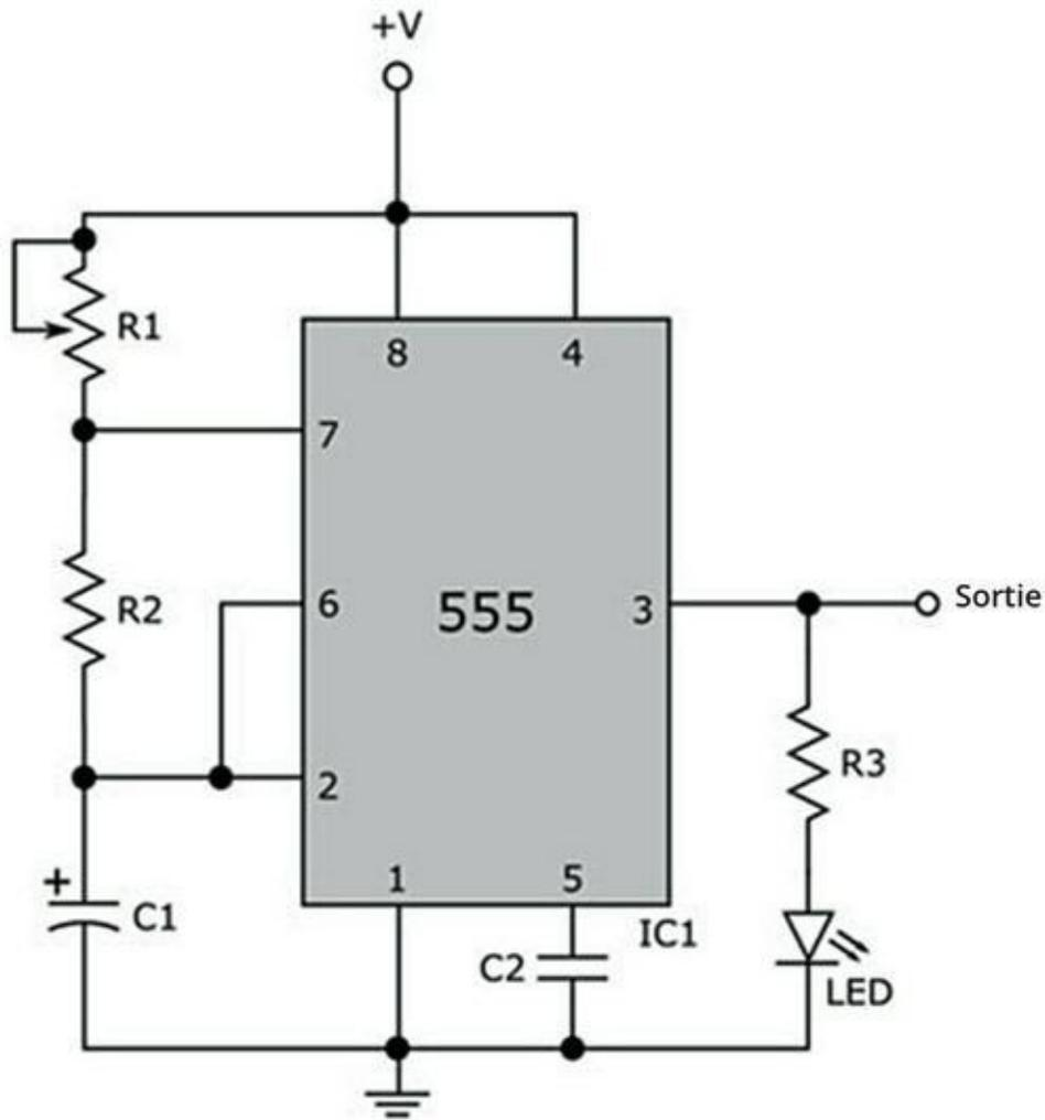
**FIGURE 17-1** Schéma du circuit d'une LED clignotante.
