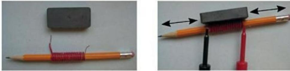
**FIGURE 8-4** Le déplacement d'un aimant à proximité d'une bobine de fil métallique induit un courant dans le fil.
