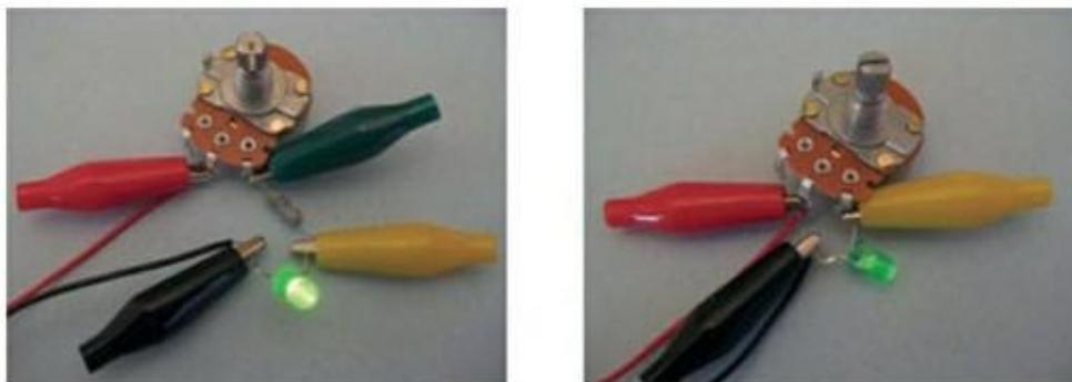
**FIGURE 5-14** Une résistance montée en série avec un potentiomètre garantit la limitation du courant traversant la LED, même si le potentiomètre est réglé sur 0 ohm. Sans cette résistance, la LED serait grillée.
