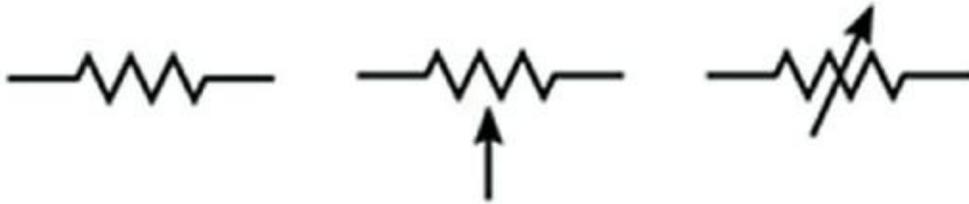
**FIGURE 5-8** Les symboles des schémas de circuits.
