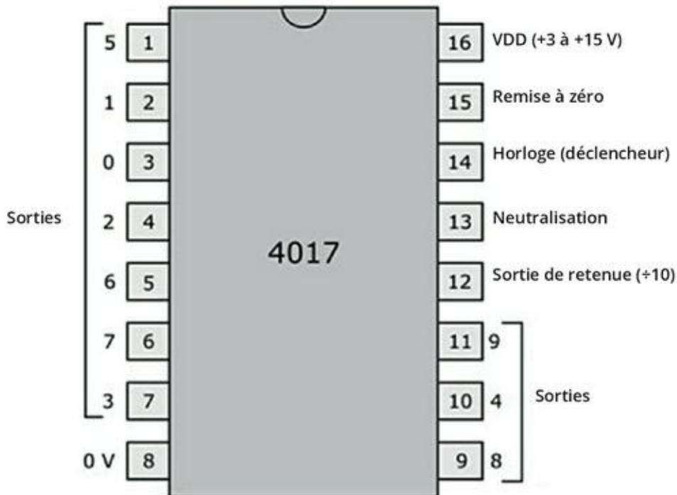
**FIGURE 11-21** Brochage du compteur décimal CMOS 4017.
