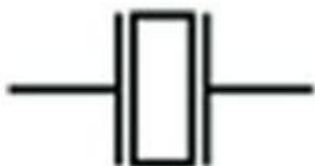
**FIGURE 8-9** Ce symbole, en schématique, représente un cristal.
