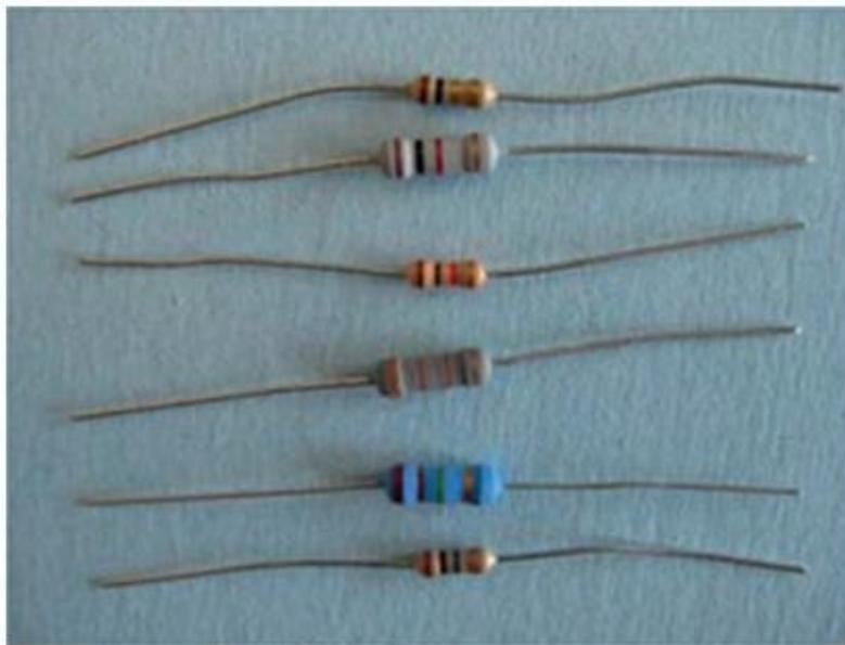
**FIGURE 5-1** Il existe des résistances de différentes tailles et de différentes valeurs.
