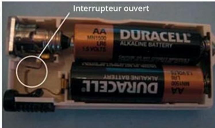
**FIGURE 3-2** L'interrupteur étant ouvert, l'ampoule n'est pas connectée aux piles et le circuit est ouvert.
