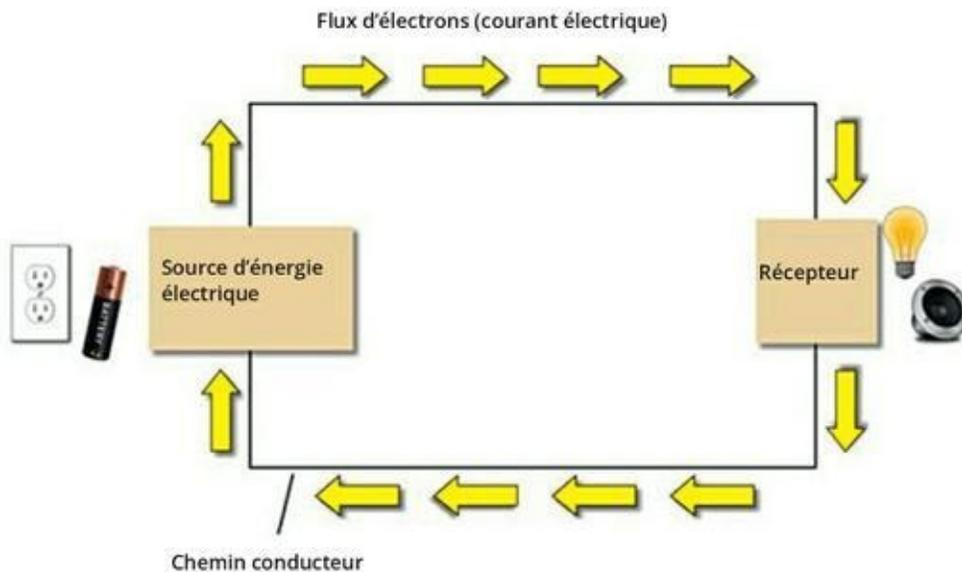
**FIGURE 1-6** Un circuit simple constitué d'une source d'énergie, d'un récepteur et d'un chemin conducteur du courant.
