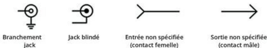
**FIGURE 14-12** Symboles des connexions à d'autres circuits.
