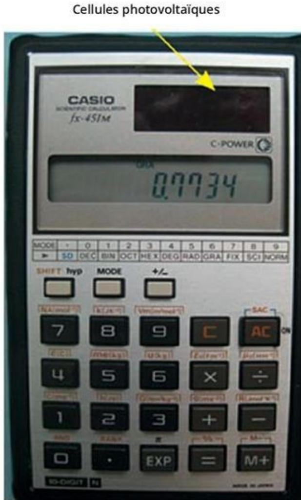
FIGURE 1-8 Cette calculatrice est alimentée en énergie électrique par des cellules photovoltaïques.
