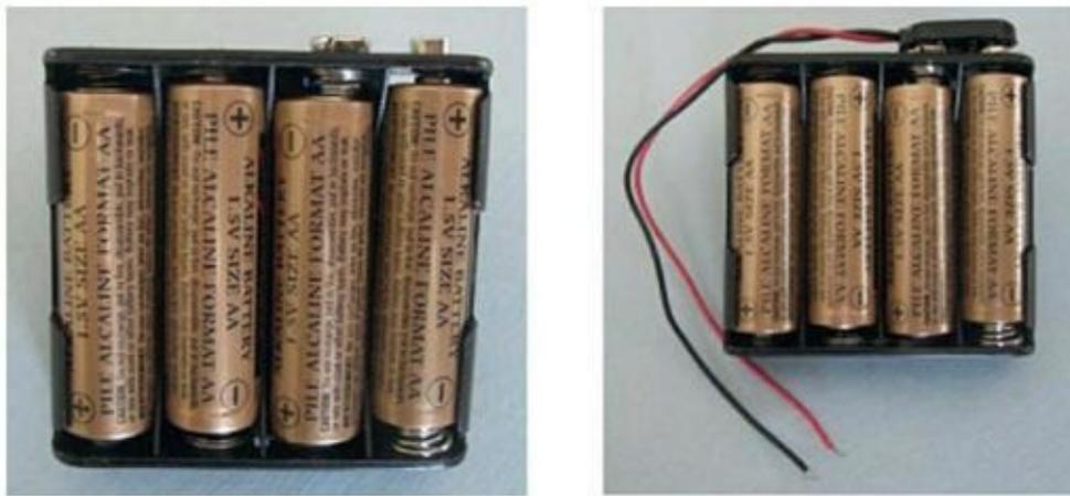
**FIGURE 12-5** Quatre piles de 1,5 V branchées en série dans un compartiment à piles produisent une tension de 6 volts entre le fil rouge et le fil noir.
