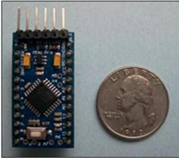
**FIGURE 11-22** La puce carrée à gauche de la pièce de monnaie est un microcontrôleur monté sur une miniplaque de circuit imprimé.
