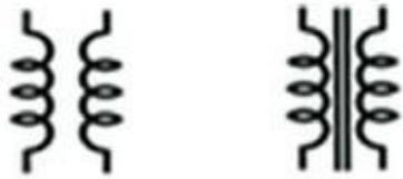
**FIGURE 8-10** Symbolisation du transformateur à air et du transformateur à noyau solide.
