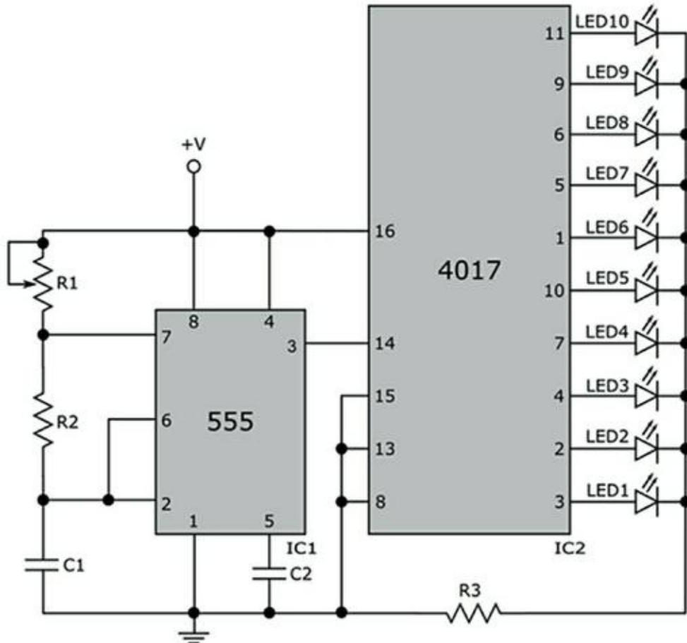
**FIGURE 17-8** Schéma du générateur d'effets lumineux n° 1.
