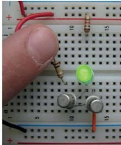
**FIGURE 10-12** Une façon de monter le circuit de commutateur à effleurement. Vous pouvez allumer la LED en plaçant votre doigt entre le fil rouge et la résistance de 100 kW.
