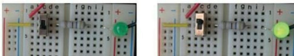
**FIGURE 4-15** Une LED verte indique si la plaque d'essais est alimentée ou non.
