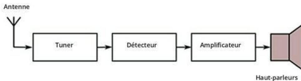
**FIGURE 14-1** Schéma fonctionnel d'un système de réception radiophonique.
