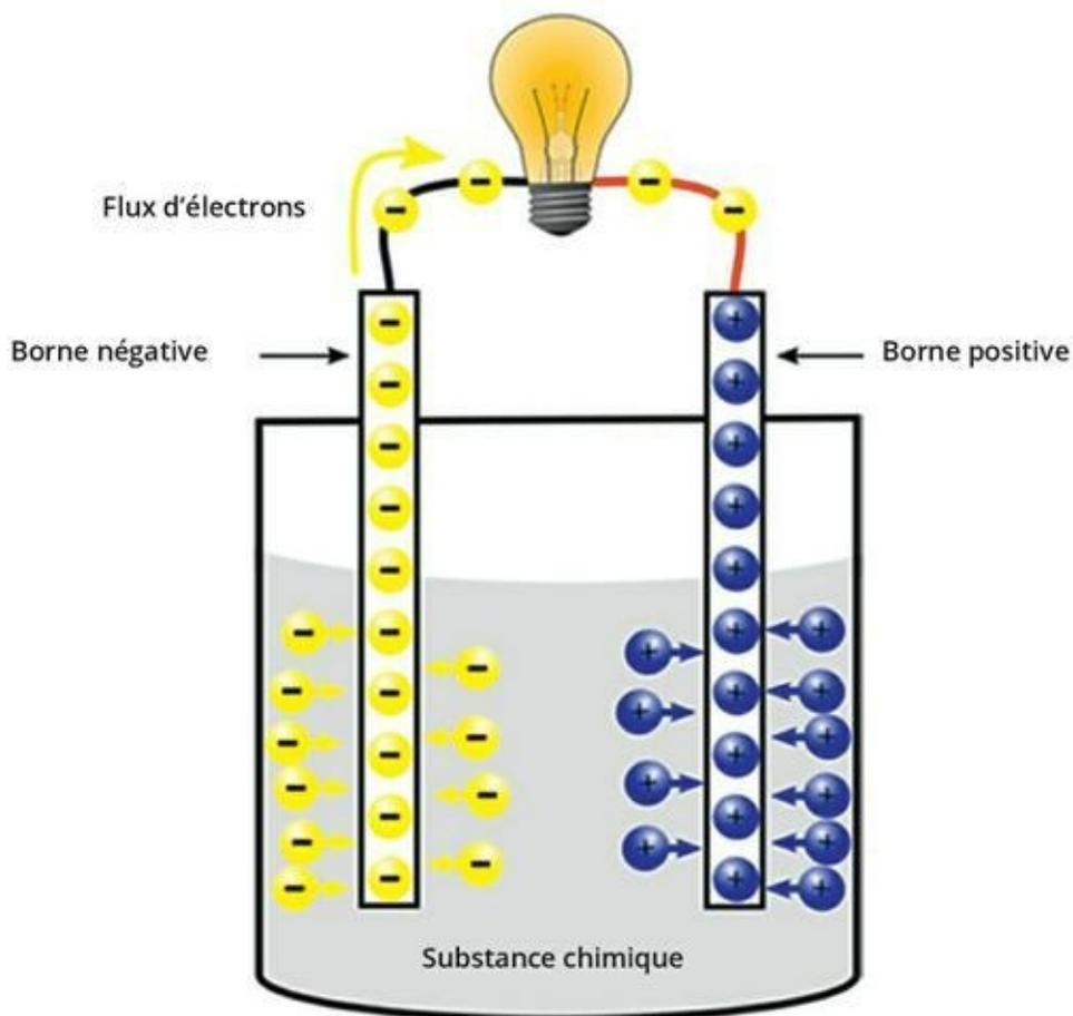
**FIGURE 1-7** Le courant continu produit par une pile.
