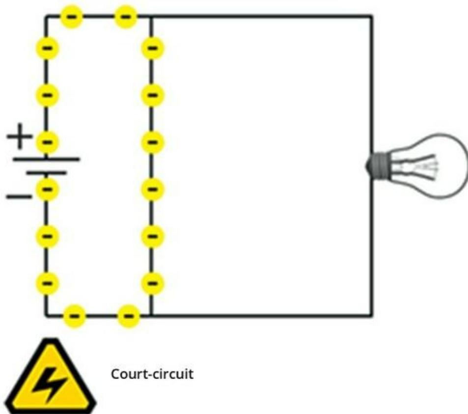
**FIGURE 3-4** Dans un court-circuit, le courant ne suit plus le chemin prévu.
