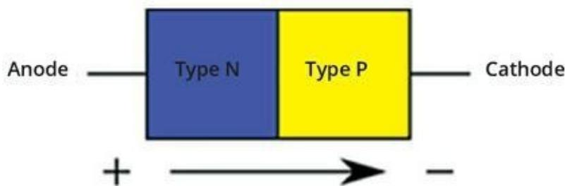
Sens du courant quand une tension est appliquée de l'anode vers la cathode (à l'exception des diodes Zener)
