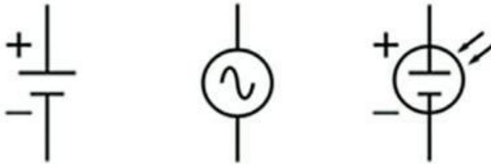
FIGURE 1-9 Les symboles d'un schéma de circuit électrique.
