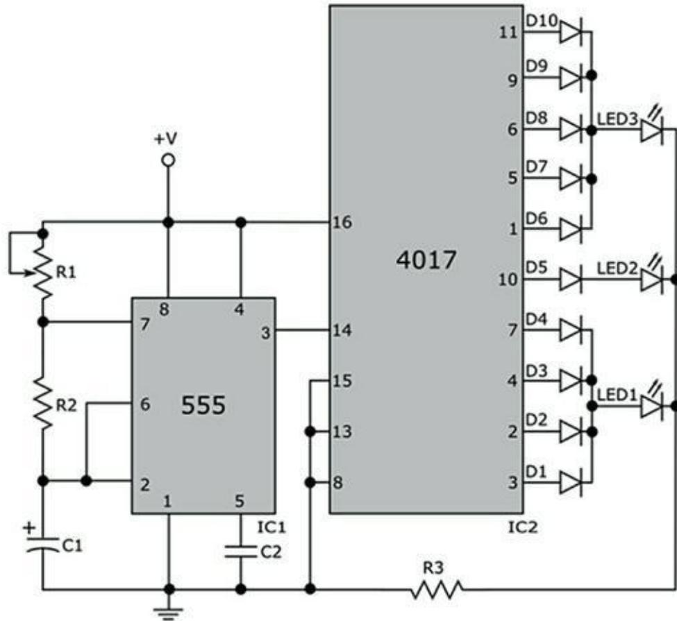
**FIGURE 17-10** Schéma électronique d'un feu de signalisation.
