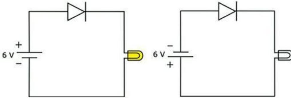
**FIGURE 9-5** Dans ce circuit, la pile située à gauche polarise la diode en mode direct et le courant alimente la lampe. Quand les polarités de la pile sont inversées (à droite), la diode est polarisée en mode inverse, ce qui empêche le courant de circuler.
