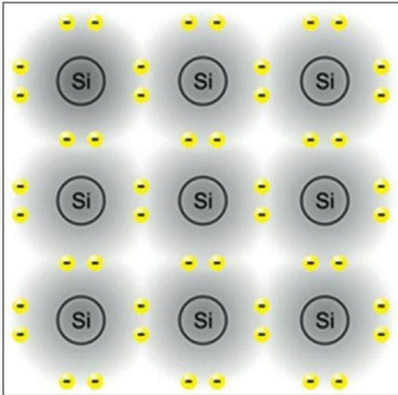
**FIGURE 9-2** Des matériaux semi-conducteurs comme le silicium comportent des liaisons covalentes fortes qui maintiennent ensemble les atomes dans une structure de cristal (seuls les électrons ultrapériphériques apparaissent ici).
