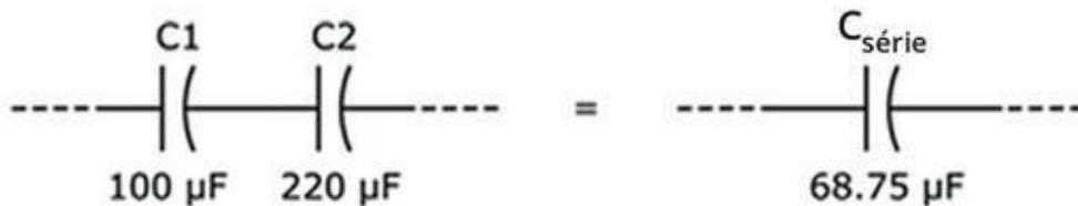
**FIGURE 7-7** Les condensateurs branchés en série se neutralisent, la capacité globale diminue.
