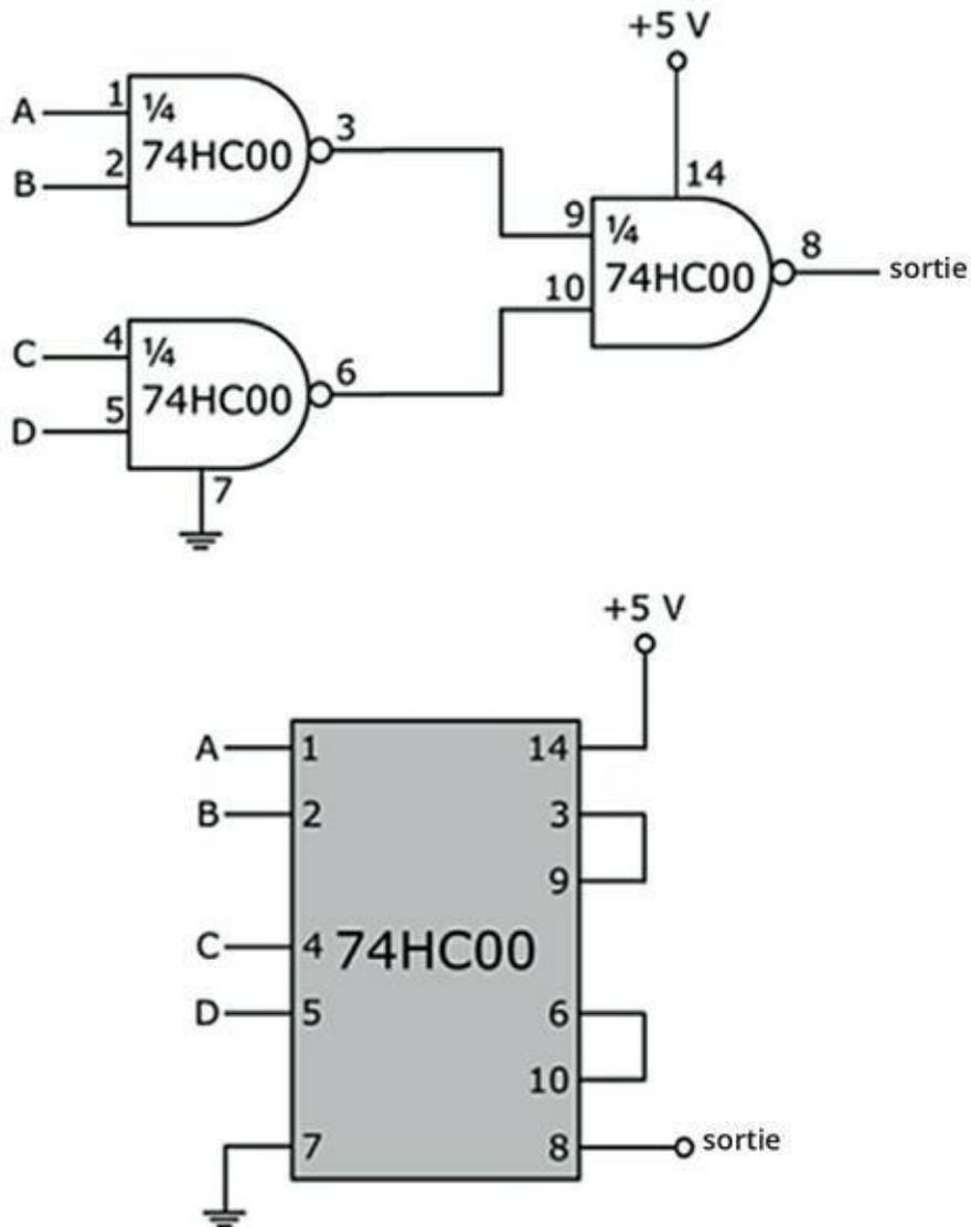
**FIGURE 14-9** Deux représentations différentes d'un même circuit.
