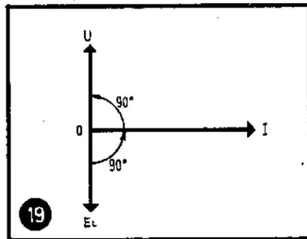
circuit est en retard de  $90^\circ$  sur la tension appliquée  $U$ . En même temps, il est en avance de  $90^\circ$  sur la f.e.m. de self-induction  $E_L$ . Autrement dit, le déphasage entre le courant et la tension est positif et égal à  $90^\circ$ , tandis que le déphasage entre le courant et la f.e.m. de self-induction est négatif et de  $90^\circ$  également.
