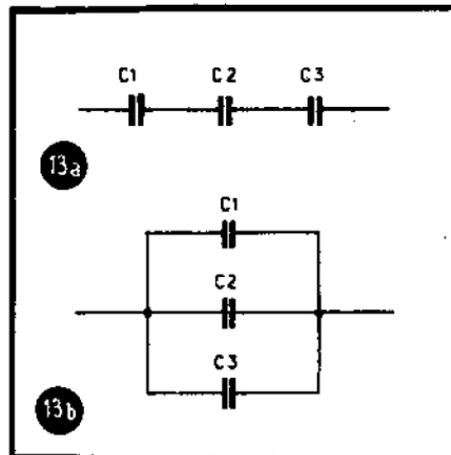
sont connectées en parallèle (fig. 13 b), la capacité résultante C est
