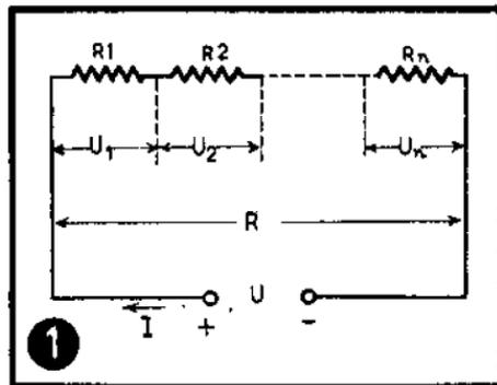
La chute de tension aux bornes de chaque résistance est :
