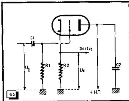
**Amplificateur à sortie par la cathode**
