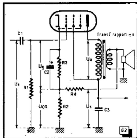
a. — Le gain de l'étage avec contre-réaction ( $G_{CR}$ ) si ce gain est, sans contre-réaction,  $G = 40$  ;
