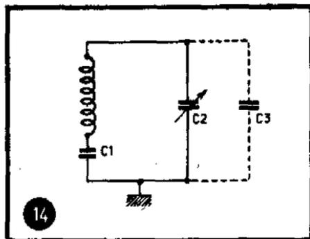
pF en G.O. La capacité maximum du condensateur variable  $C_2$  est de 490 pF. Quelle sera la capacité du circuit pour chaque gamme et au maximum du CV, en admettant que la capacité parasite totale  $C_3$  (en parallèle sur  $C_2$ ) est de 50 pF ?
