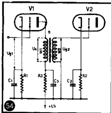
Pour les fréquences basses (inférieures à 800 p/s) et lorsque la lampe  $V_1$  est une triode, le gain de l'étage est calculé par la relation
