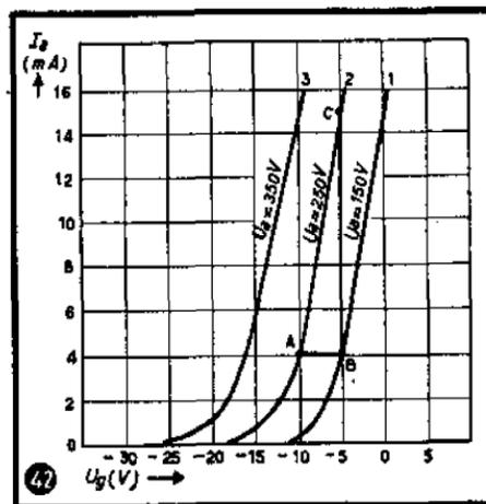
Entre la pente, la perméabilité et la résistance interne d'un tube nous avons la relation fondamentale suivante
