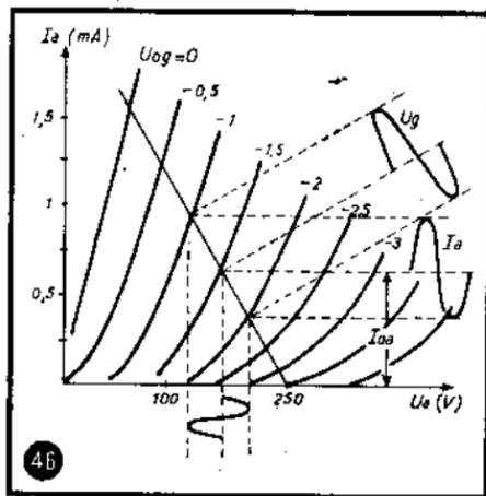
de la tension continue  $U_{og}$  (polarisation), une tension alternative sinusoïdale  $u_g = U_g \sin \omega t$  (fig. 4b), nous aurons, en absence de la résistance de charge ( $R_a = 0$ ),
