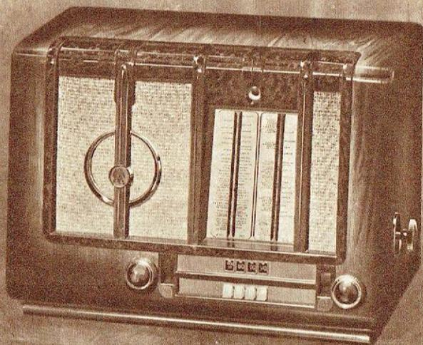
La série « Grand Luxe » débute par ce modèle. Six lampes dont deux ECH3 (lampes doubles). Bobinages à fer. Compensation BF. et contre-réaction. Tonalisateur 3 positions. Grand cadran avec aiguille lumineuse (breveté). Dynamique 245 mm. Grande ébénisterie à angles arrondis et vernis dégradé, avec cadre bakélite. Série « Semi - Automatique » avec changement d'ondes par « Boutons lumineux ».
