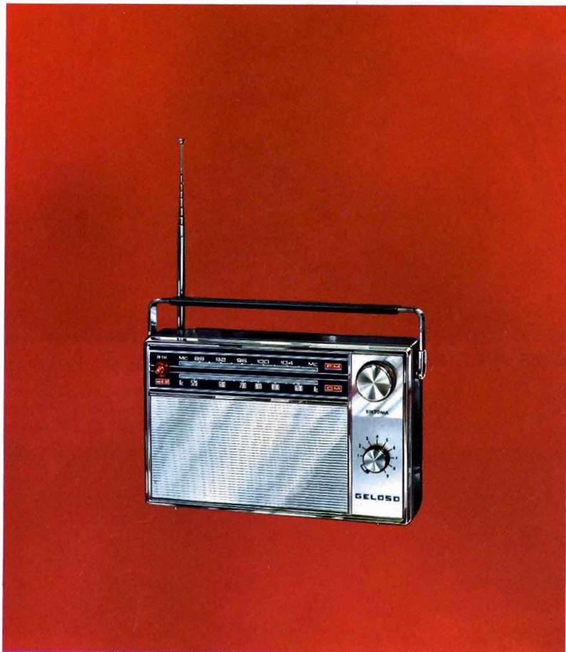
**G 16/201** 10 transistori + 5 diodi - Onde Medie e Mod. di Frequenza - Controllo autom. di freq. FM - Antenne a ferrite e a stilo telescopico - Prese antenna esterna, cuffia, registratore - 4 pile da 1,5 Volt - Dim. cm. 25×16×7. **L. 27.900**
