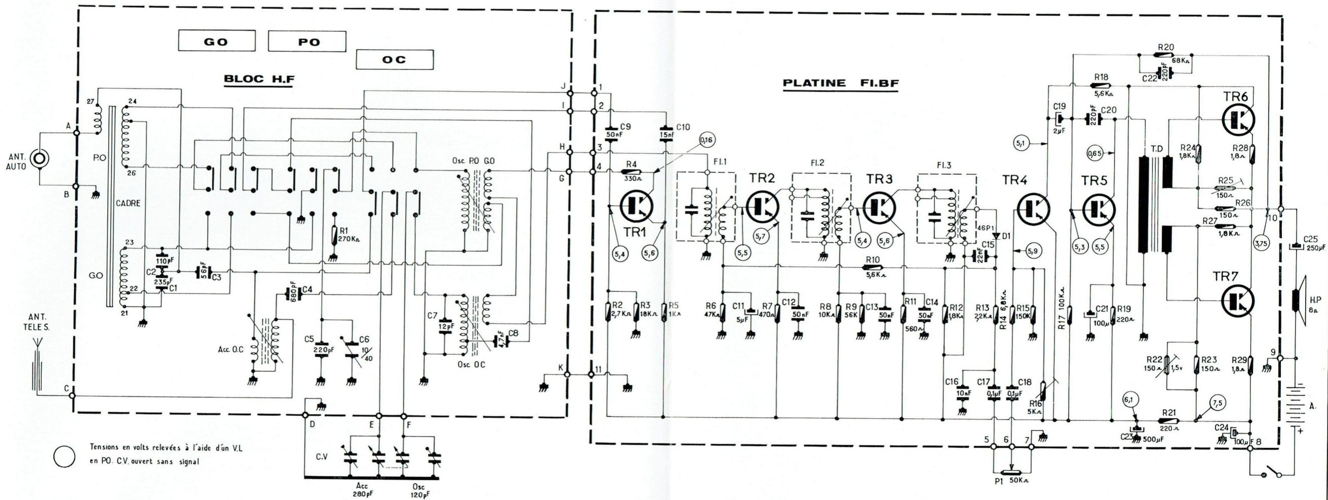
○ Tensions en volts relevées à l'aide d'un V.L. en PO. C.V. ouvert sans signal
