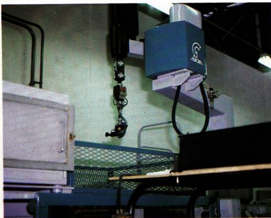
Le robot de déchargement de presses conçu par Albora.
