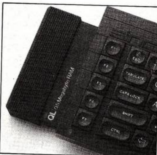
Module d'extension RAM de 0,5 Mo.
