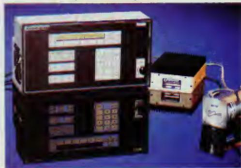
Compumotor : programmeur 16 bits de moteurs pas à pas.
