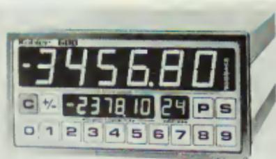
commande monocycle ou en continu. Les entrées optoélectroniques travaillent en logique positive ou négative et le compteur dispose de trois entrées à 2 canaux. 9 relais assurent la sortie, la fréquence
