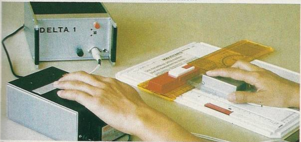
Lecture opto-électronique et conversion en Braille éphémère.
