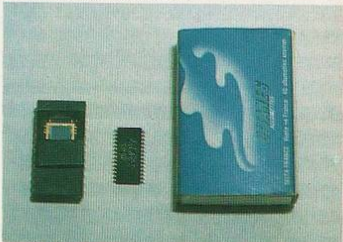
Le C.C.D. et son circuit de commande.
