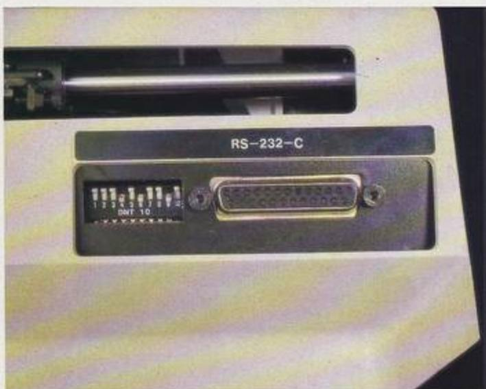
Prise de connexion et mini-interrupteurs de configuration.
