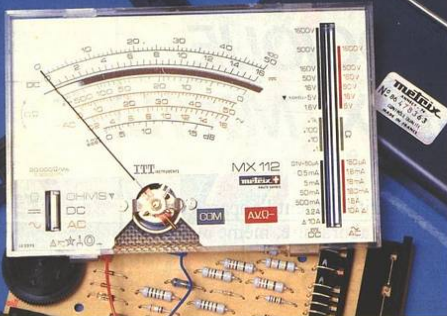
Photo 2. - Le galvanomètre et son jeu d'échelles.
