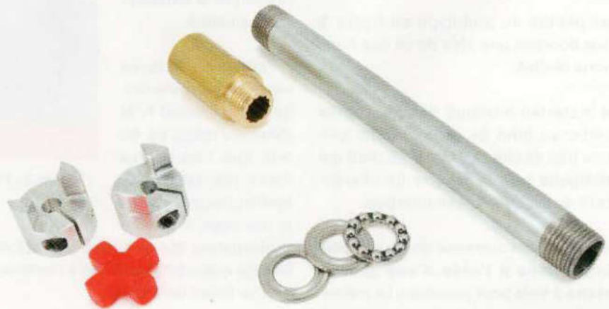
Figure 4 : ici le joint d'Oldham démonté (notez le palier de butée en laiton) et le tube où la mèche servant de vis sans fin est insérée.
