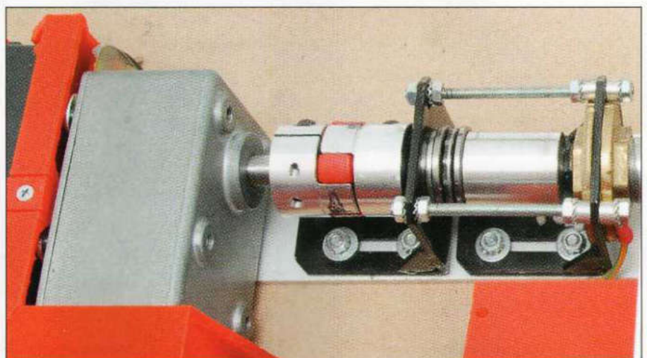
Figure 2 : détails du motoréducteur et du joint d'Oldham qui le relie à l'axe de la meche utilisée comme vis sans fin pour alimenter l'extrudeuse.
