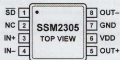
Brochage du circuit intégré SSM2305.
