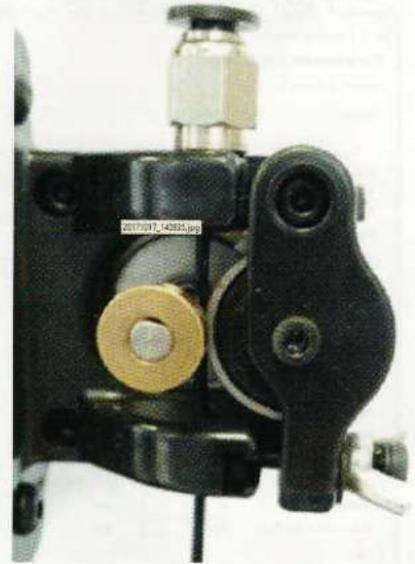
roulement et le guide jusqu'à ce qu'il pénètre dans le tube en PTFE (voir la figure 35).
