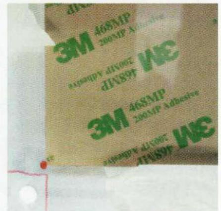
**Figure 7 : alignement du coin du dispositif chauffant avec le point de contact de la tête en position « HOME ».**
