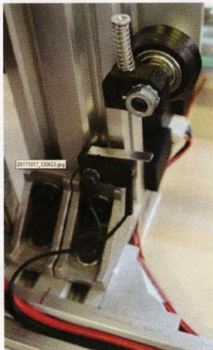
**Figure 30 : réglage du fin de course de l'axe Z.**
