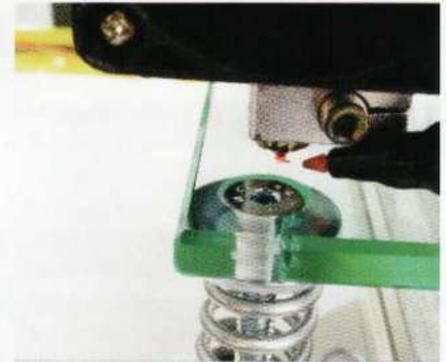
**Figure 5 : marquage sur la plaque de verre du point de contact de l'extrudeuse.**
