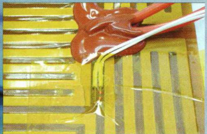
Figure 2 : la CTN placée entre 2 pistes de cuivre de l'élément chauffant.
