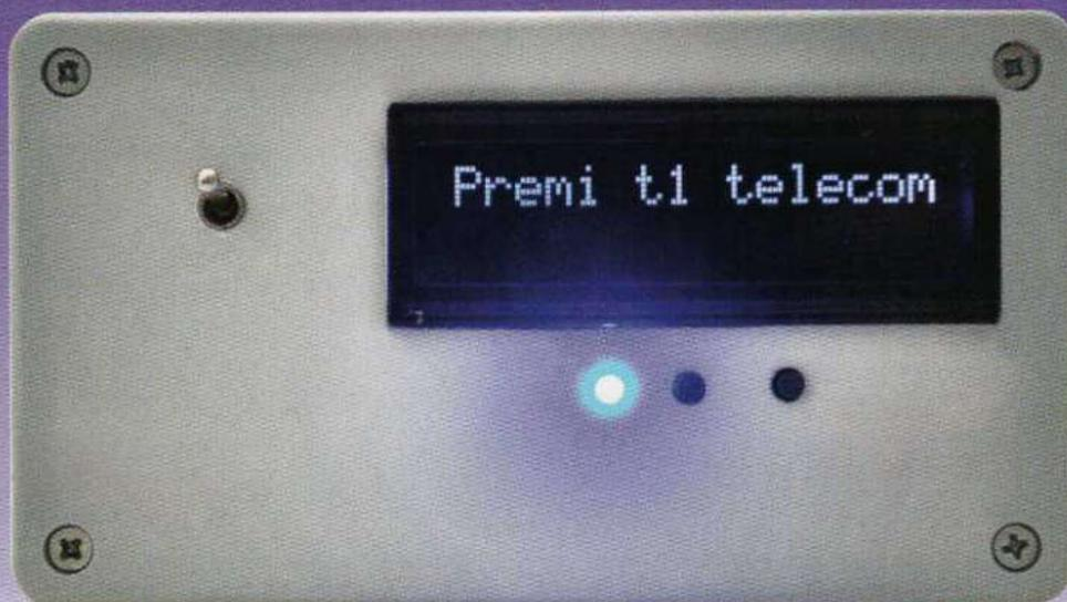
Ce montage permet de vérifier l'intégrité et la programmation correcte des télécommandes couramment utilisées pour les ouvre-portes, les portails, les volets motorisés, etc.
