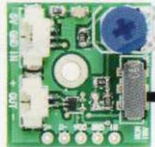
Photo de l'un de nos prototypes de l'amplificateur linéaire.
