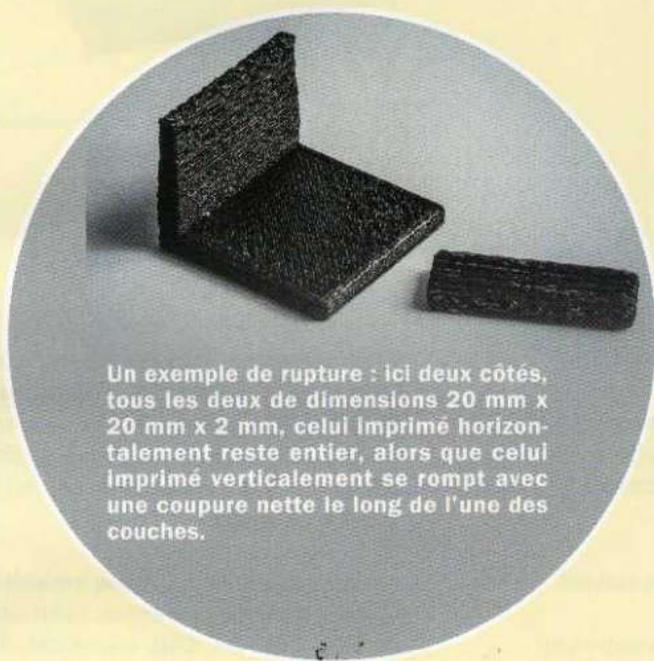
Un exemple de rupture : ici deux côtés, tous les deux de dimensions 20 mm x 20 mm x 2 mm, celui imprimé horizontalement reste entier, alors que celui imprimé verticalement se rompt avec une coupure nette le long de l'une des couches.
