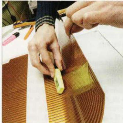
Figure 11 : utilisez un objet non tranchant pour étaler correctement l'adhésif sans laisser des bulles d'air se former.
