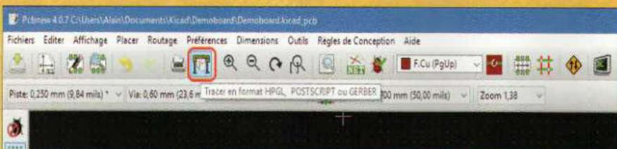
Figure 7 : génération des fichiers de sortie à partir de l'icône « Tracer en format... ».
