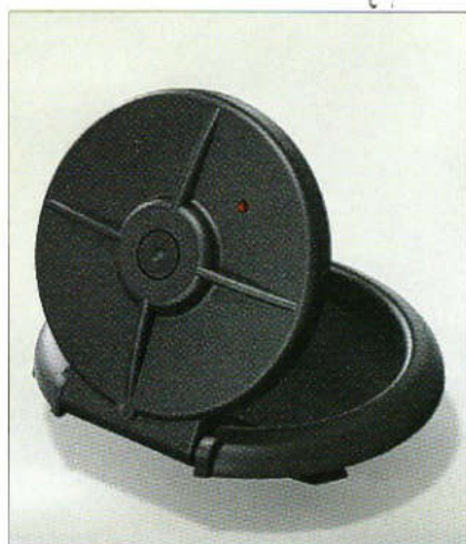
Figure 1 : la caméra du RaspberryPi insérée dans son boîtier avec la base pivotante.
