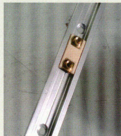
Figure 3 : le chariot inséré dans le guide sur lequel est vissé le support de la caméra.
