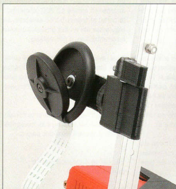
Figure 2 : à gauche, le support couissant de la caméra ; à droite, l'ensemble bras et support de caméra.
