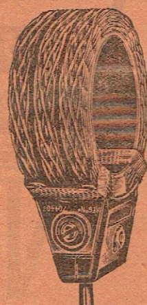
NOUVELLE BOBINE en triple nid d'abeille partagée en trois sections espacées pareillement
