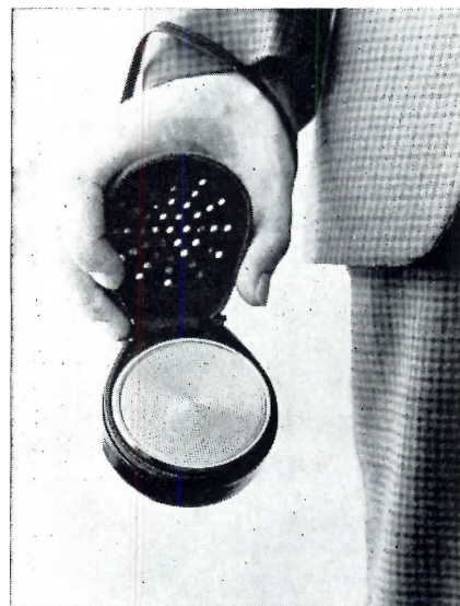
Premier récepteur de radio à circuit intégré (lequel n'occupe que 1 mm 3 ) cet appareil créé par Philips mesure 75 x 72 x 30 mm et coûte environ 125 DM.
